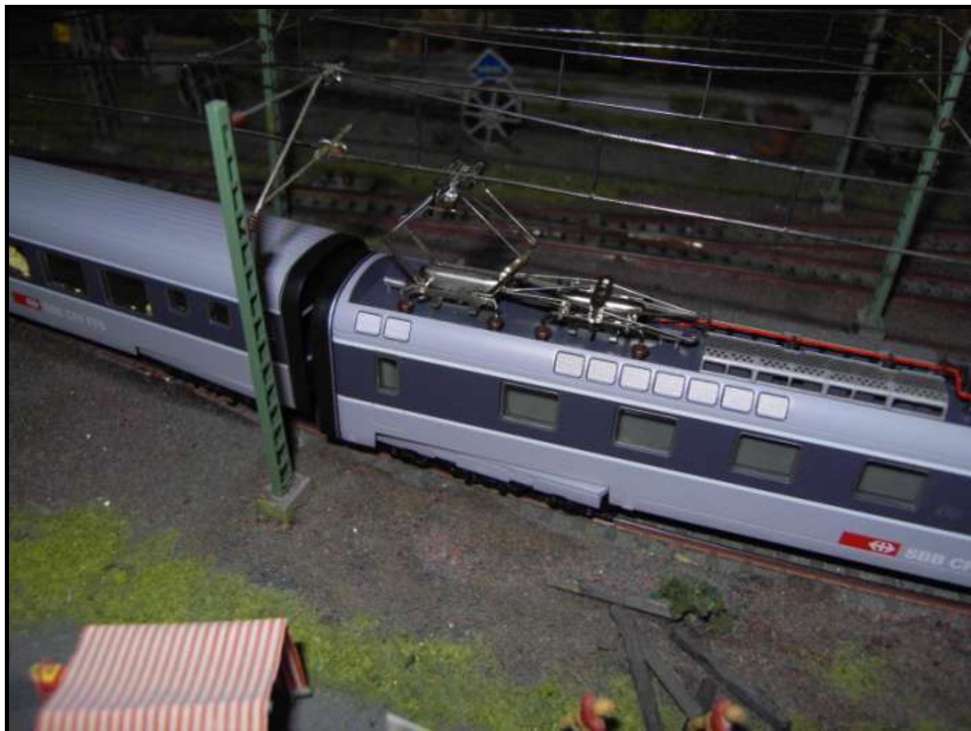
Foto n. 23: il pantografo con strisciante largo per le DB, quello accanto è quello stretto per la catenaria SBB CFF.
