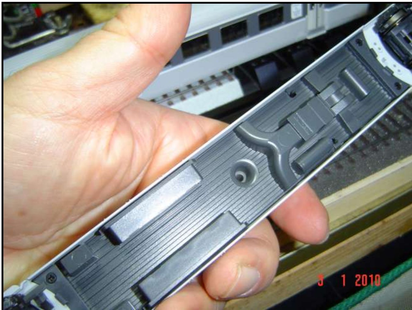
Foto n. 14: nel foro centrale l'alloggiamento della vite nelle carrozze pilota .
