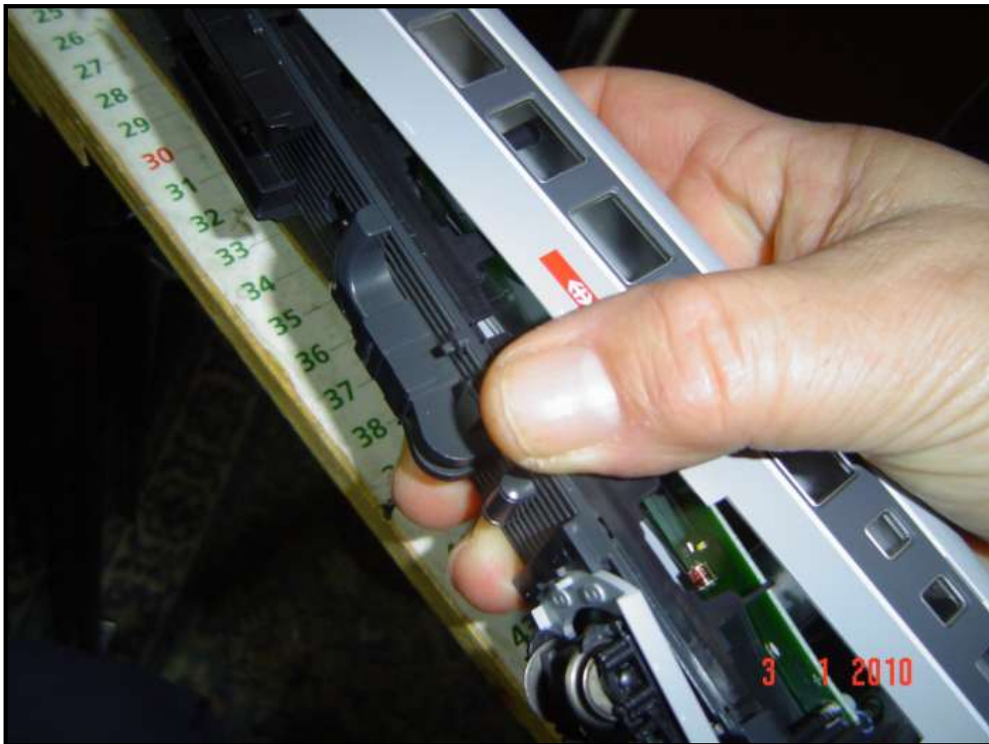
Foto n. 15: per sollevare il mantello è conveniente serrare la vistosa riproduzione del sottocassa, ben evidente in questa foto.
