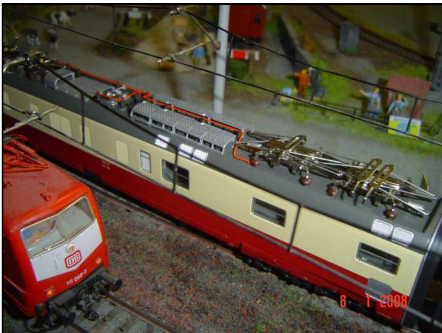
Foto n. 22 da destra a sinistra: rispettivamente i pantografi per le DB, le SBB CFF e le nostre FS. Quello alzato, sullo sfondo tutto a sinistra, dovrebbe essere adatto sotto la catenaria SNCF.
