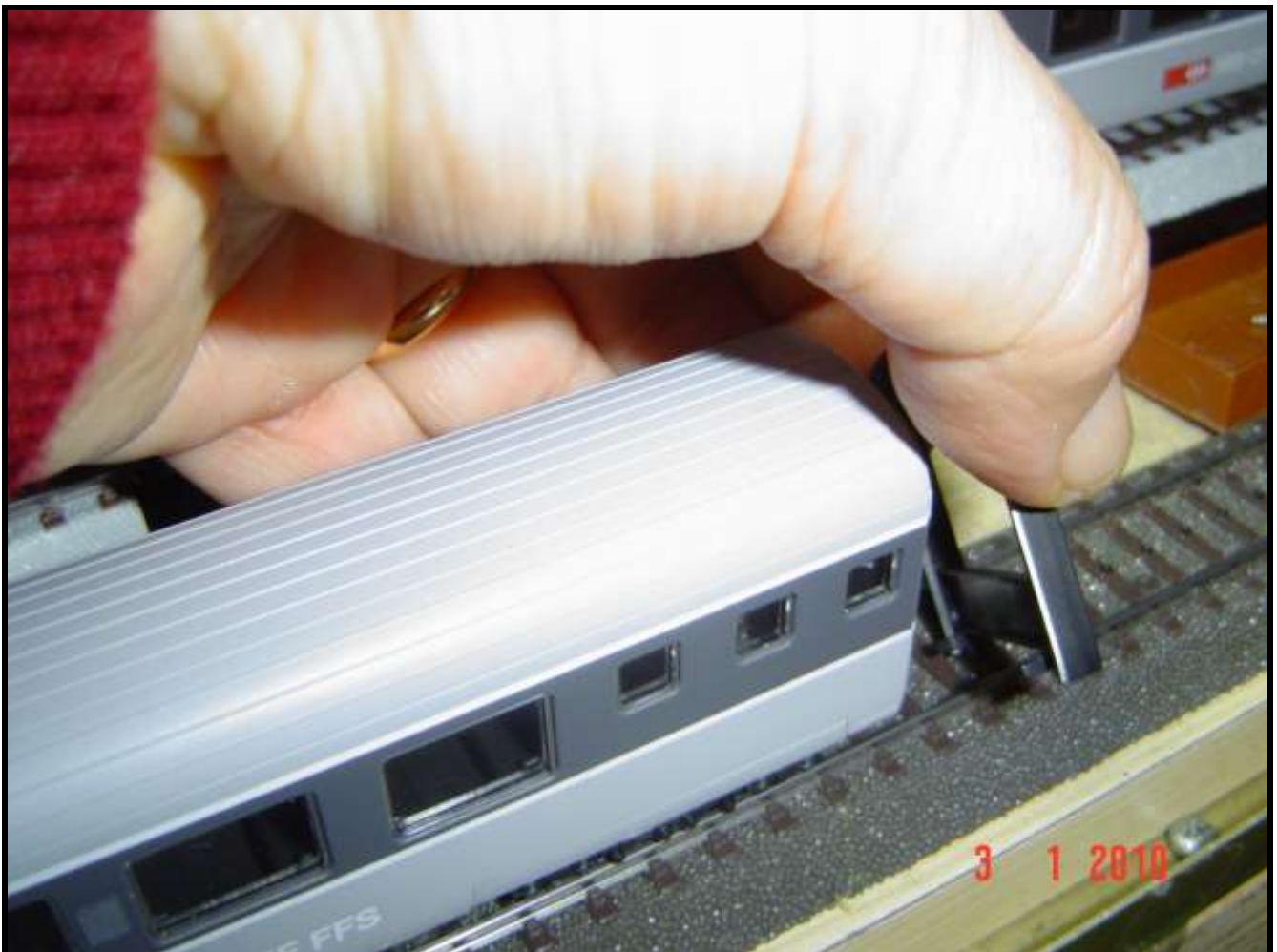
Foto n. 13: allontanare il soffietto delle carrozze del "Topo".
