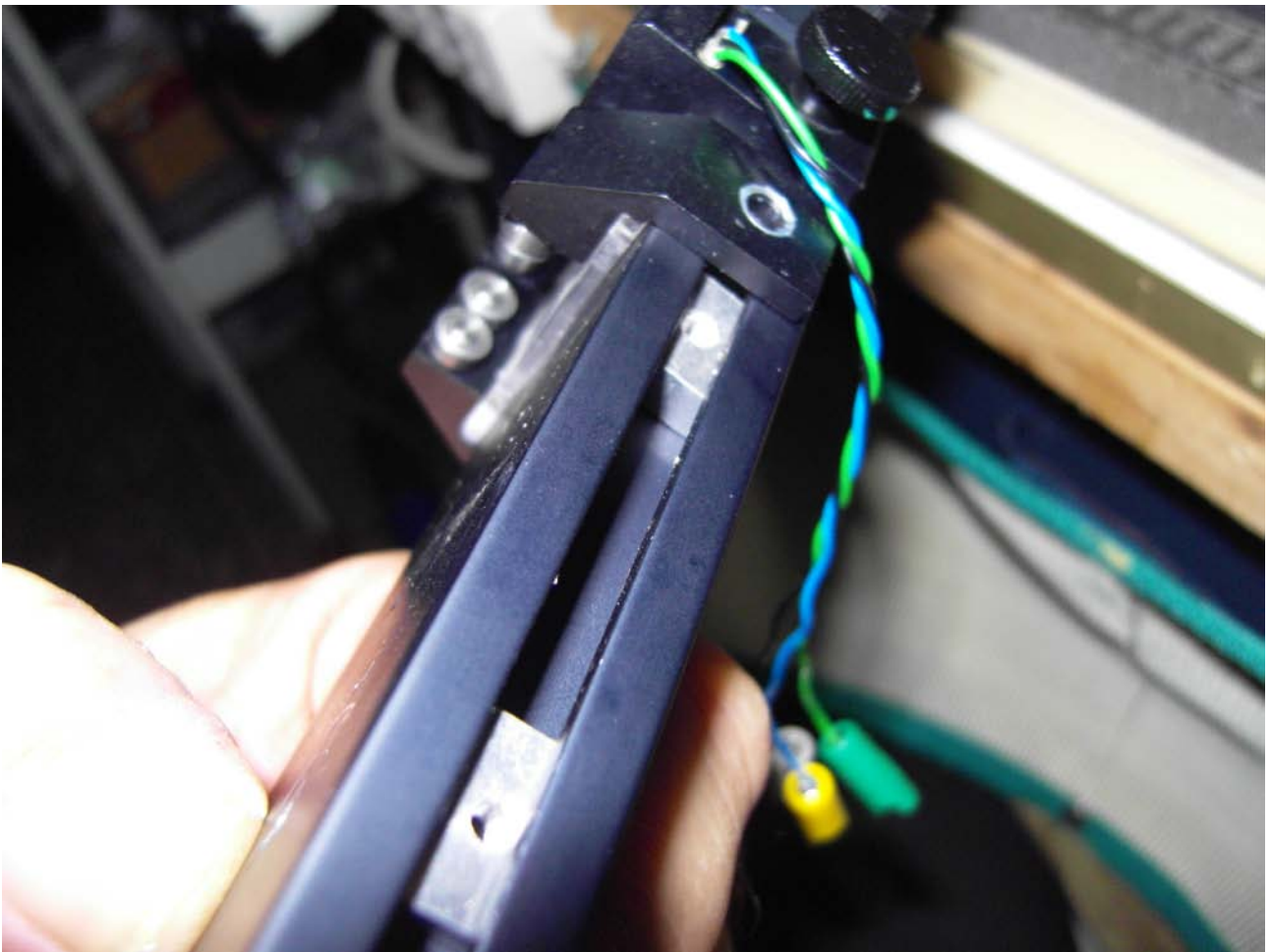
Foto n. 27: il rullo speciale va inserito come terzo nel banco di prova
