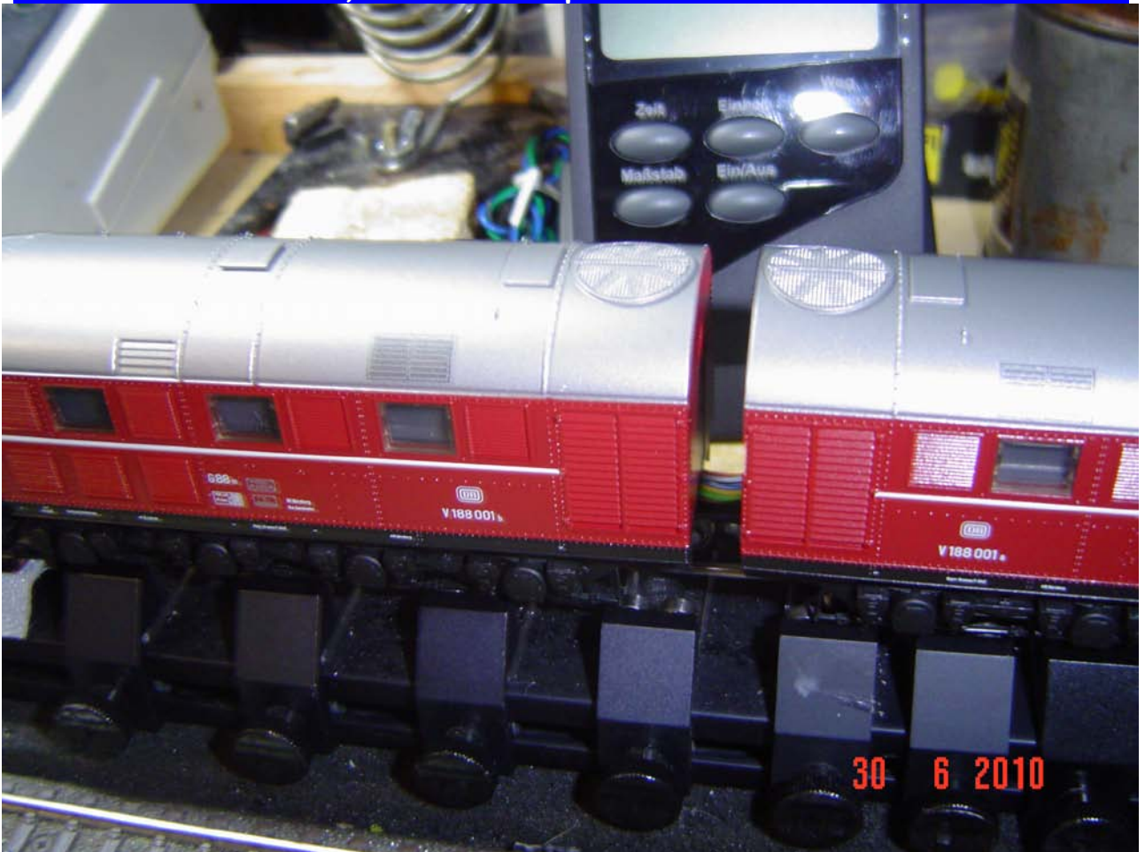
Foto n. 11: la 218 260, sul banco di prova a 6 rulli: ha 4 assi motorizzati
