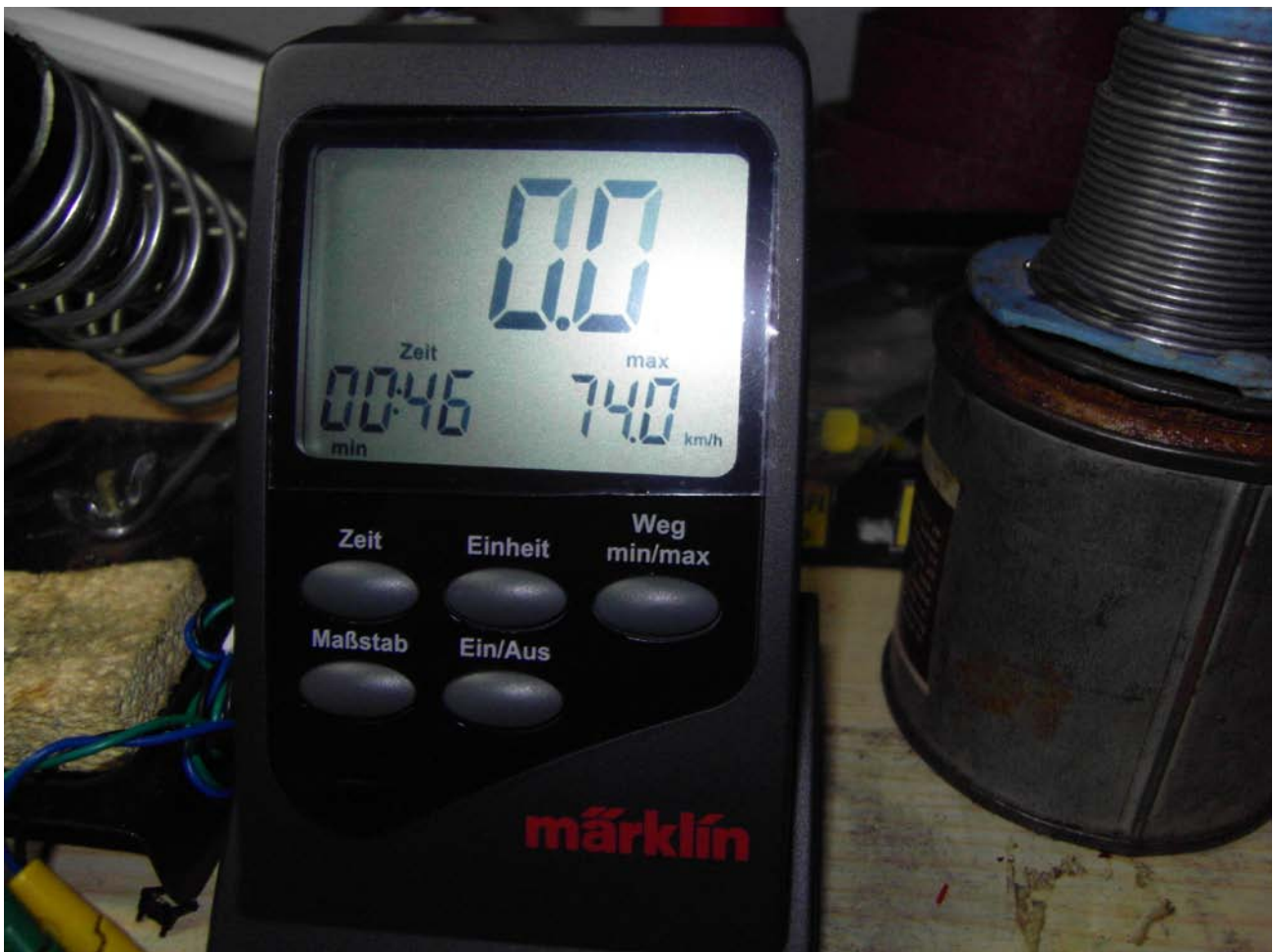
Foto n. 4: il contakilometri (art. 78158) che si collega al banco di prova
