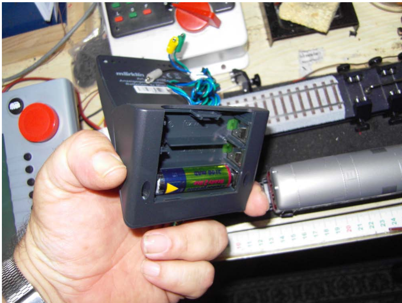
Foto n. 23: il vano per le batterie è alla base del contakilometri
