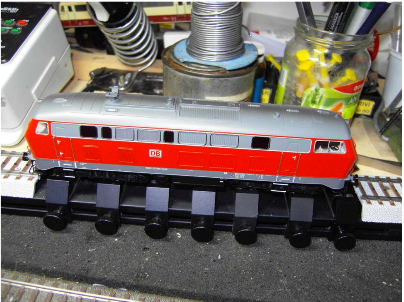
Foto n. 11: la 218 260, sul banco di prova a 6 rulli: ha 4 assi motorizzati
