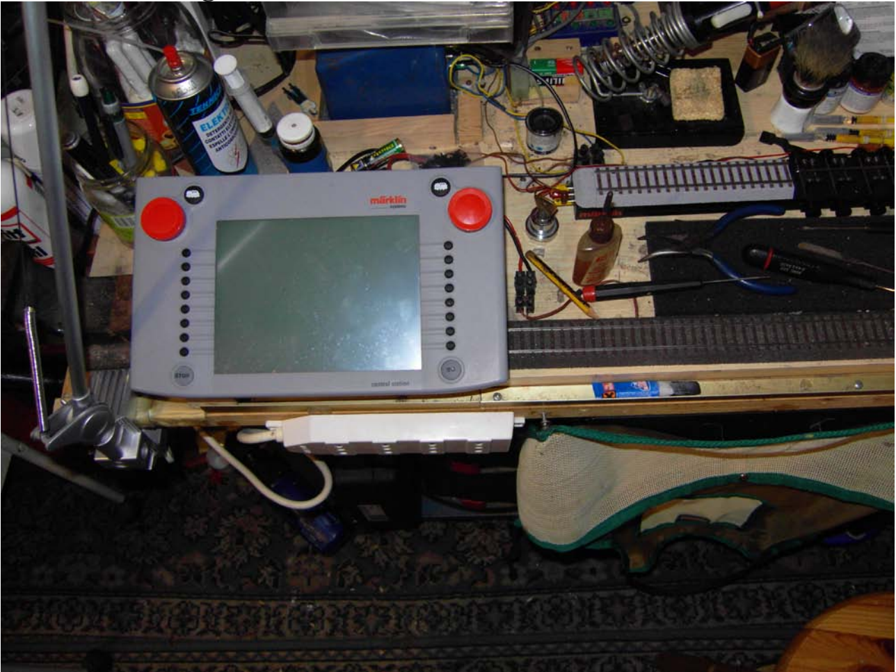
Foto n. 3: esempio di collegamento della CS1 al banco di prova a rulli
