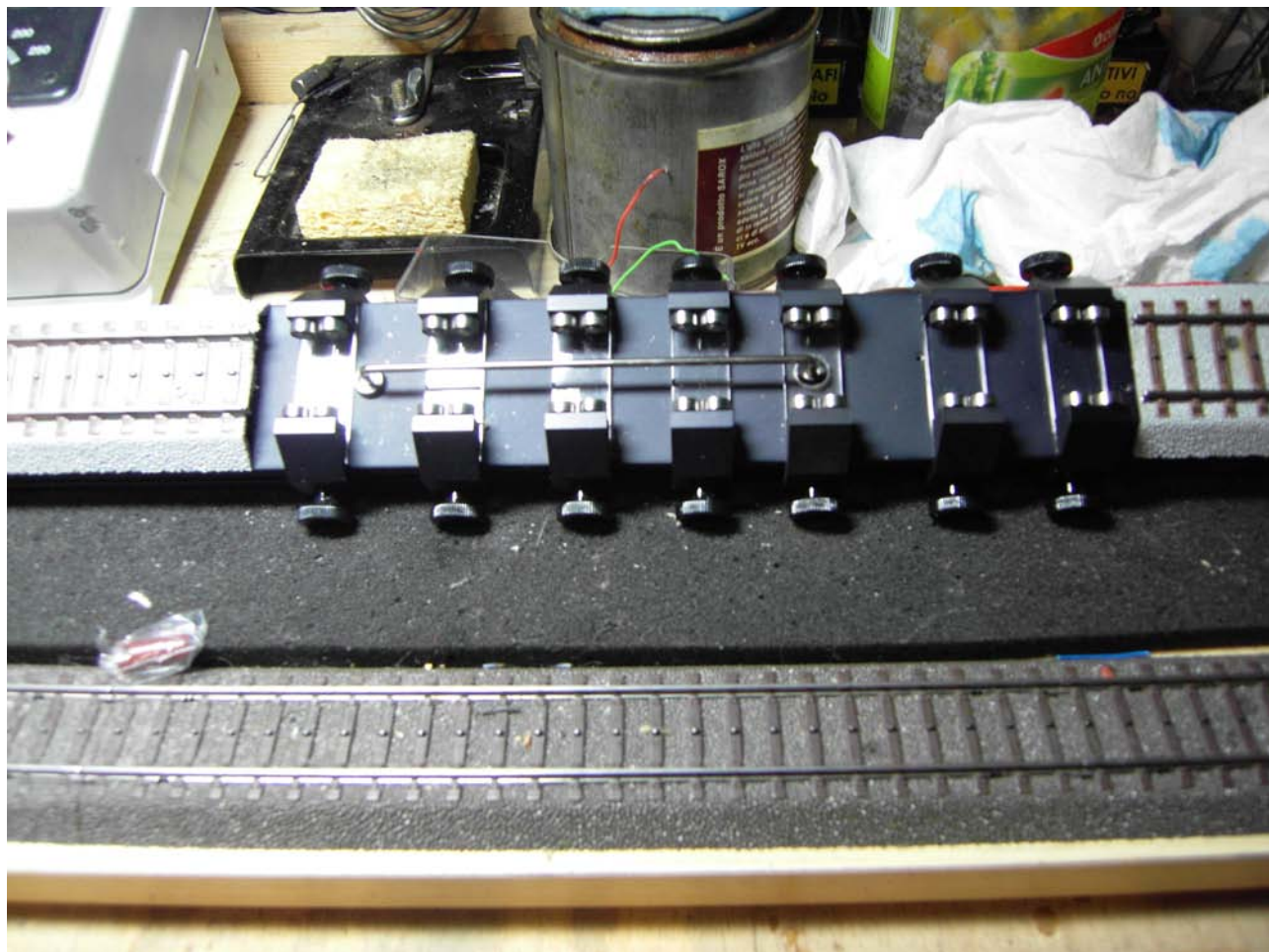
Foto n. 7: il banco di prova (art 78150) già con 7 coppie di rulli
