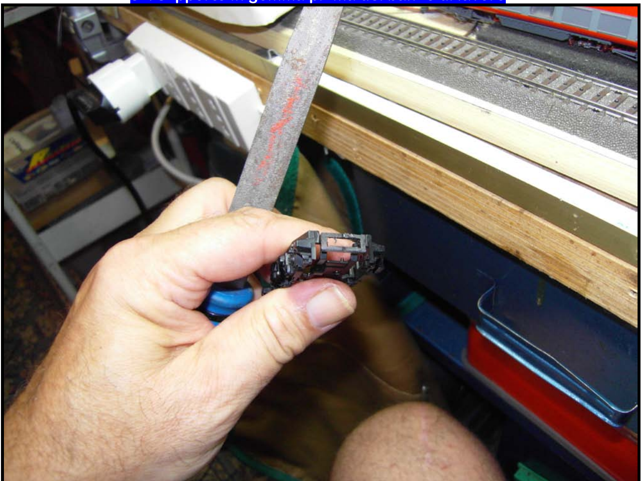
foto n. 10: la lima pareggia l'irregolarità del taglio
