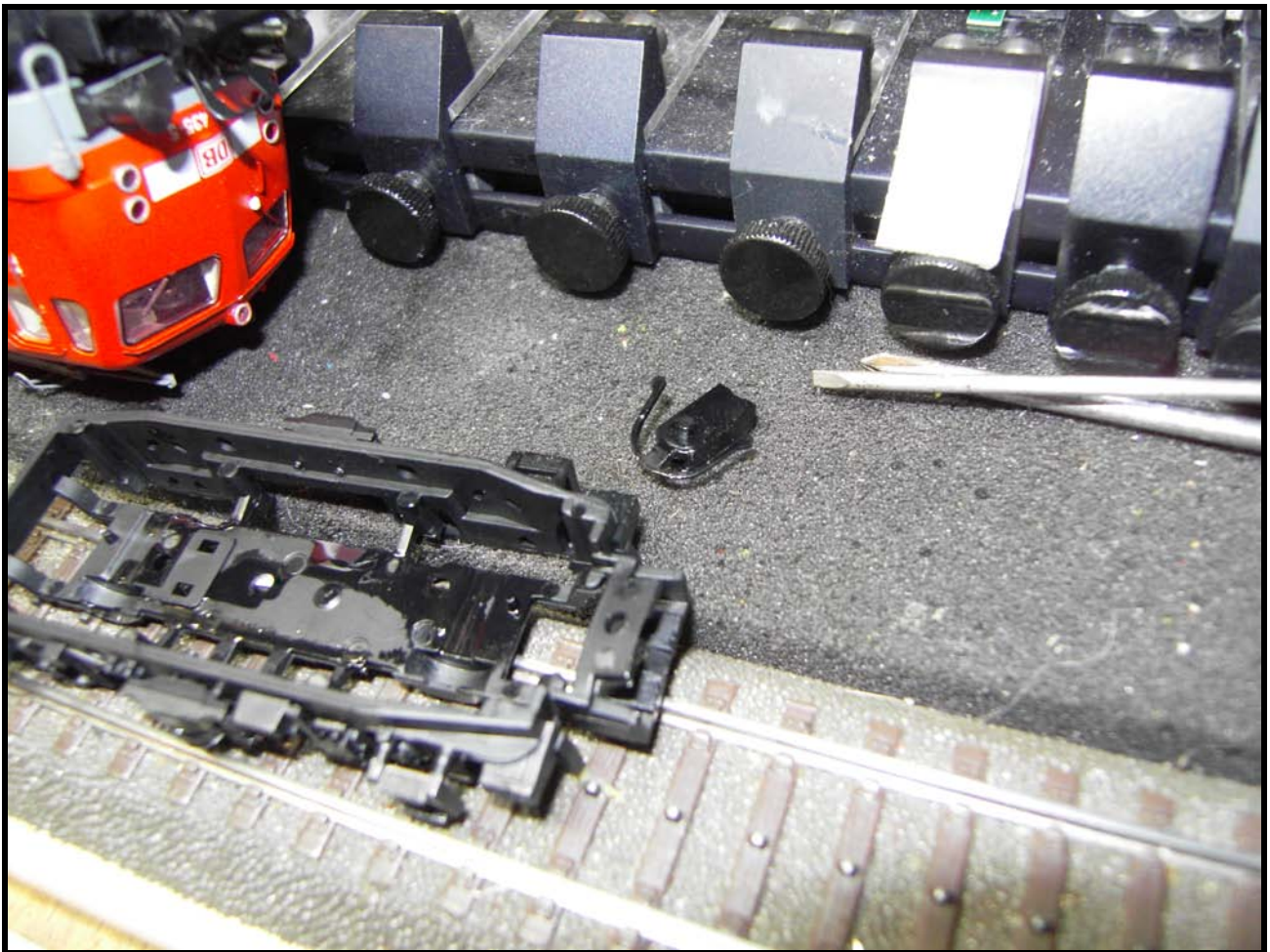
foto n. 7: si allontana il porta gancio (al centro della foto e con le alette) del carrello forzando con un cacciavite
