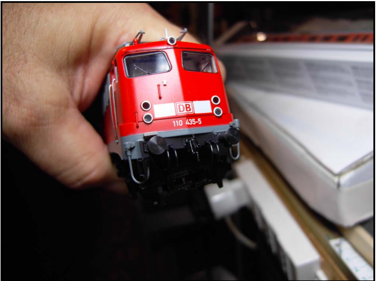
foto n. 13: i tubi dei freni Märklin vengono inseriti a pressione
