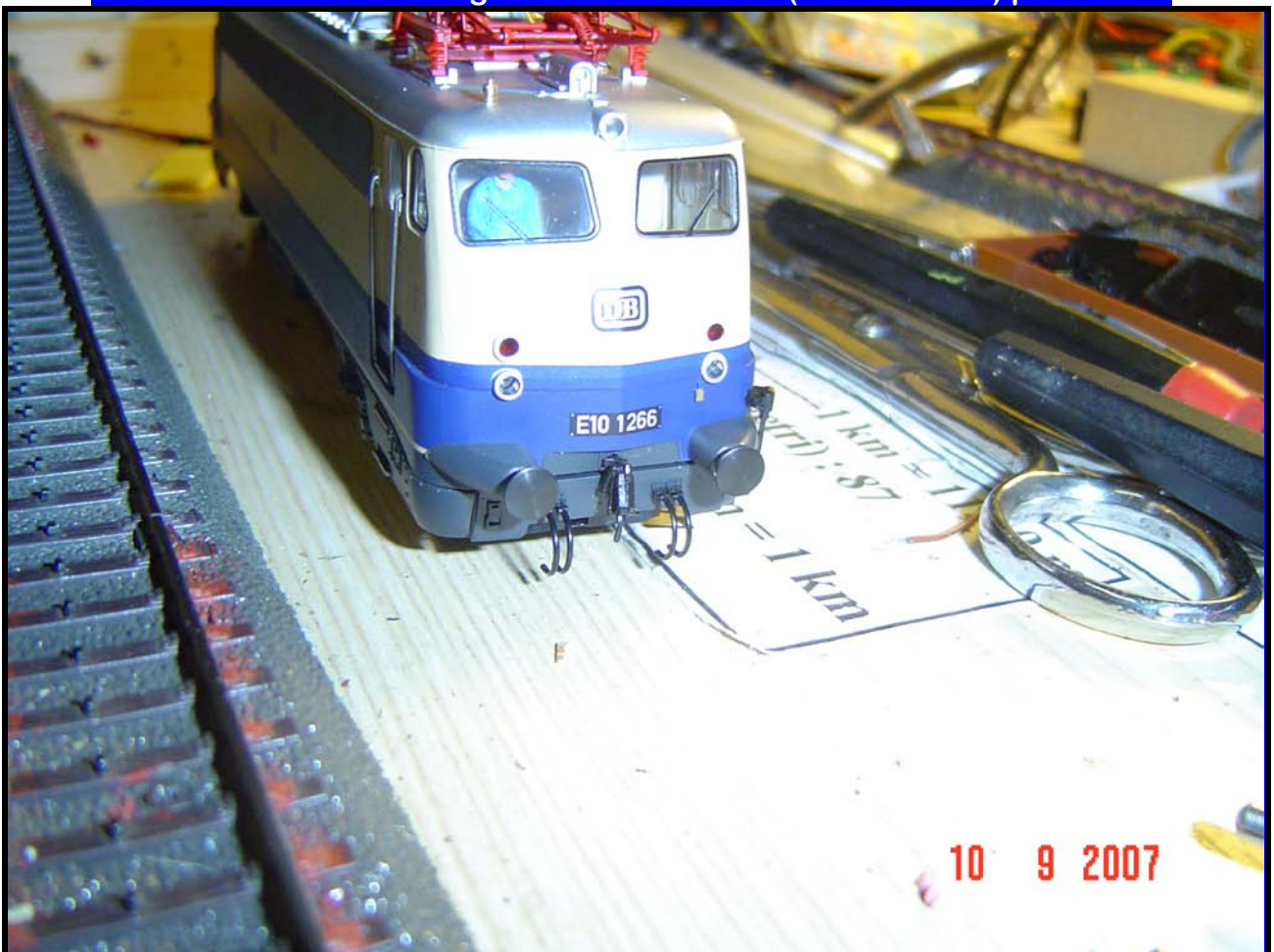
foto n. 2: muso anteriore della E 10 completato con la mascherina e vari aggiuntivi
