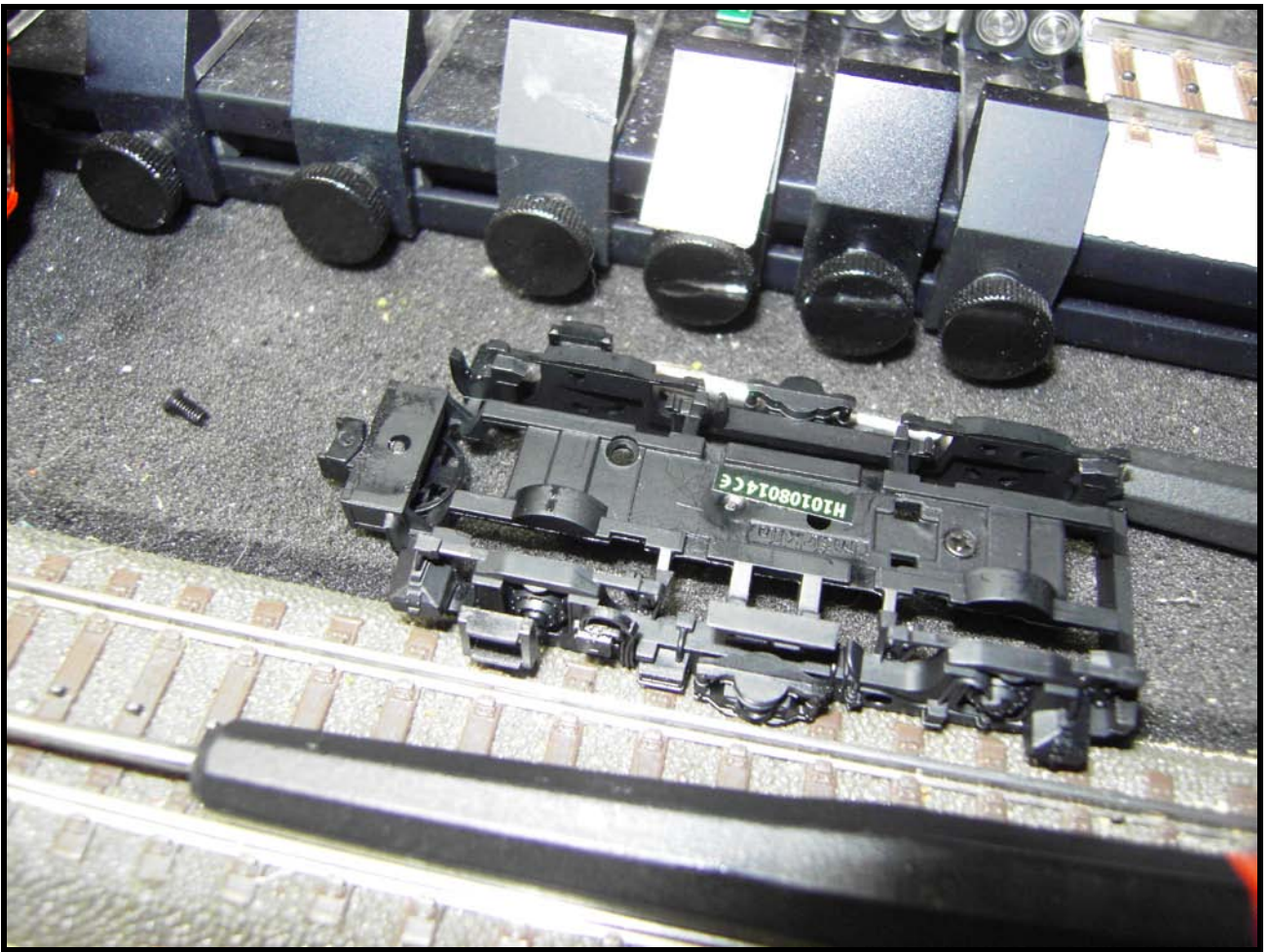
foto n. 6: le 2 viti (una è ancora nella sede) che trattengono la copertura
