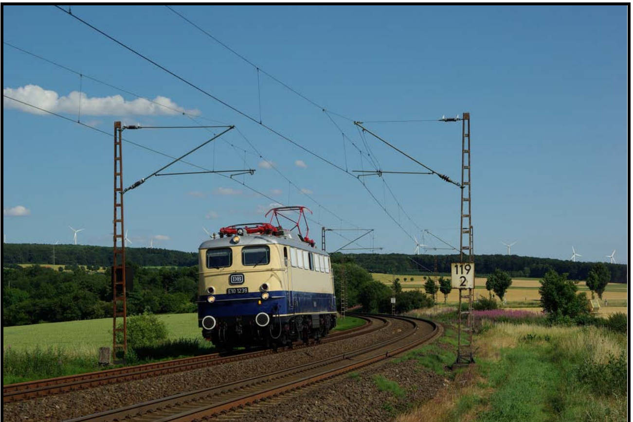
Foto di una vera E 10 12 serie senza "piega dei pantaloni", colorazione per il traino del Rheingold, con corrimano sotto i finestrini
