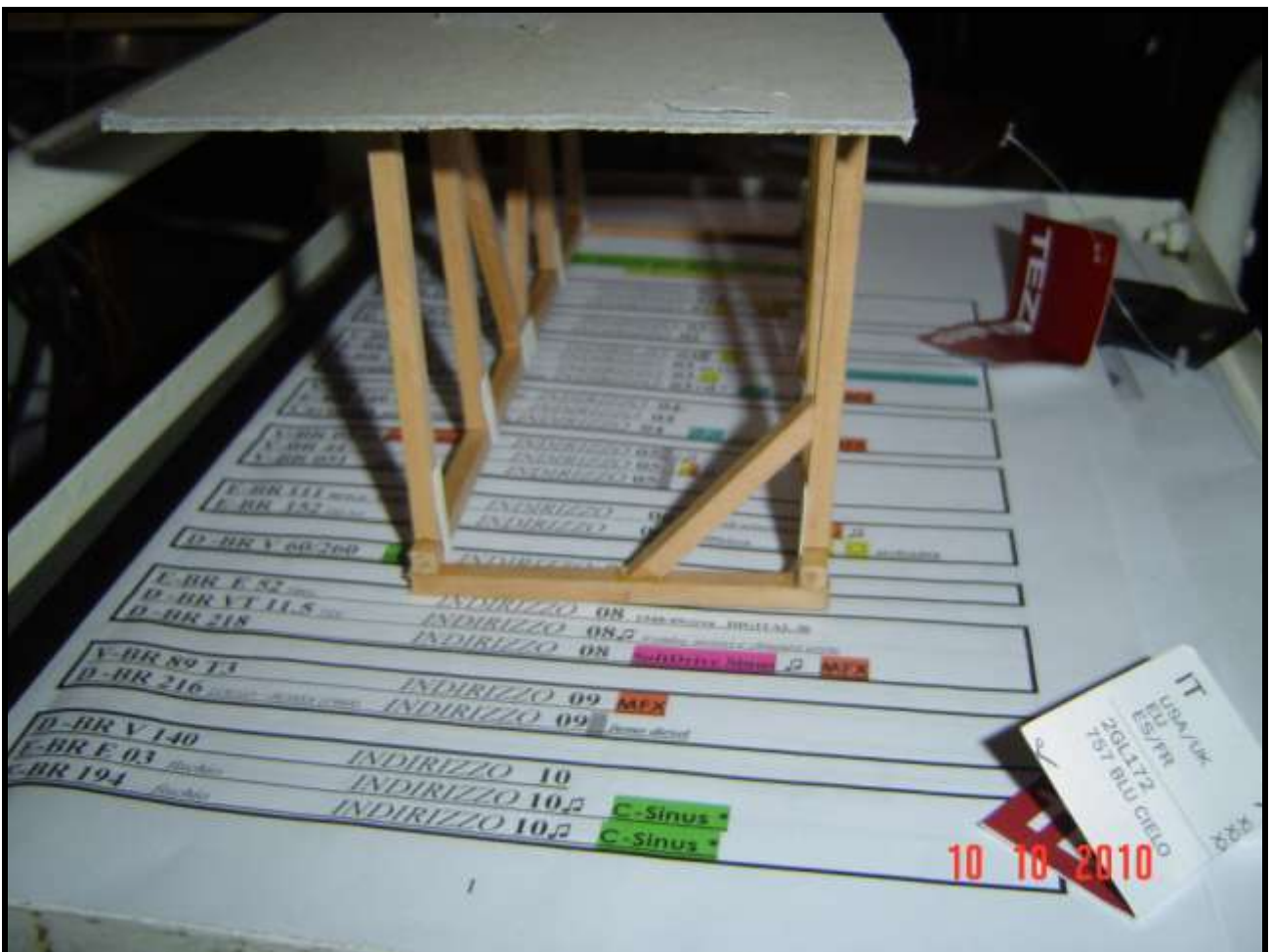
foto n. 19: la struttura rovesciata e l'elemento corto di controvento
