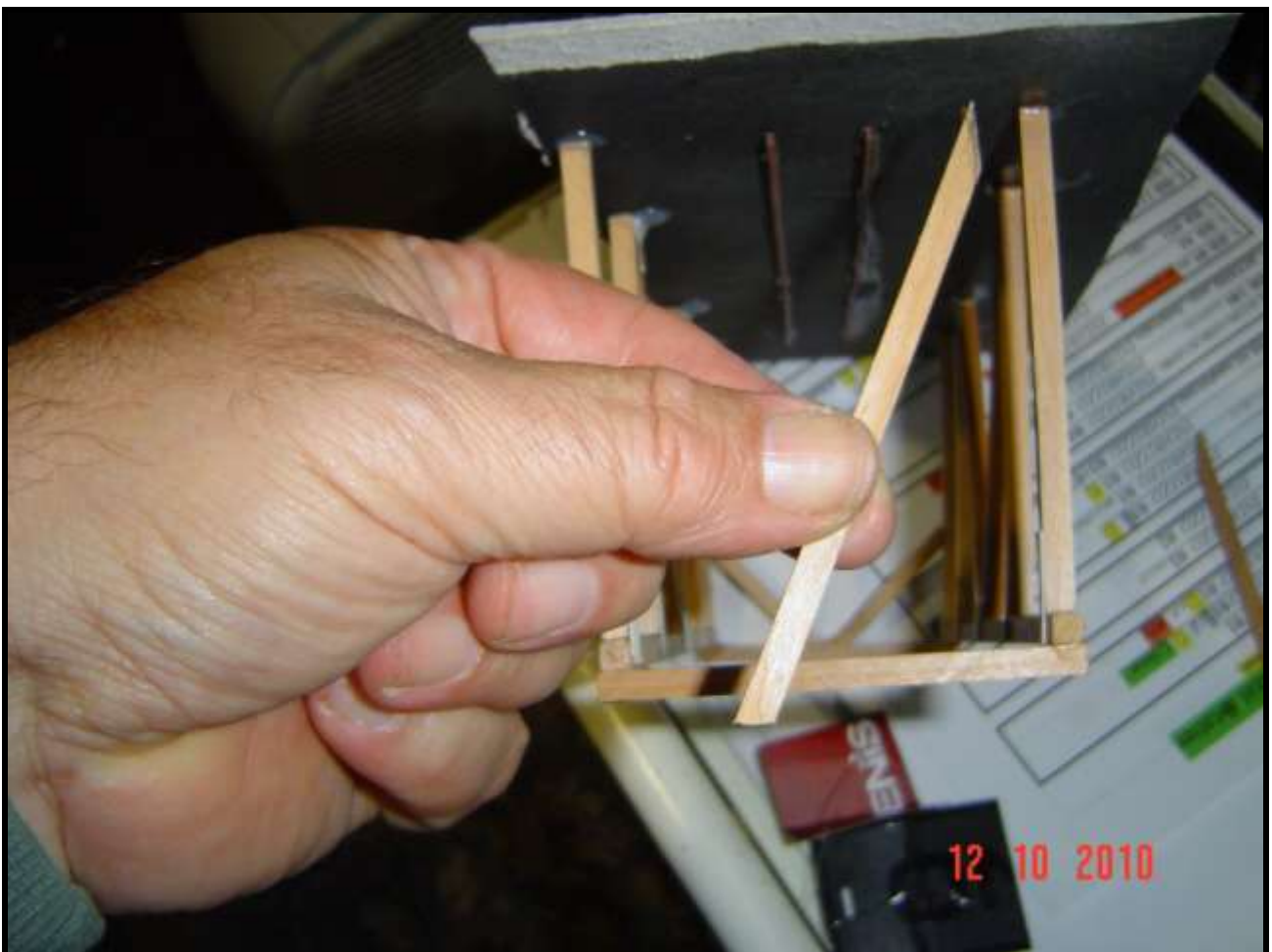
foto n. 23: i due elementi di controvento lunghi, sagomati
