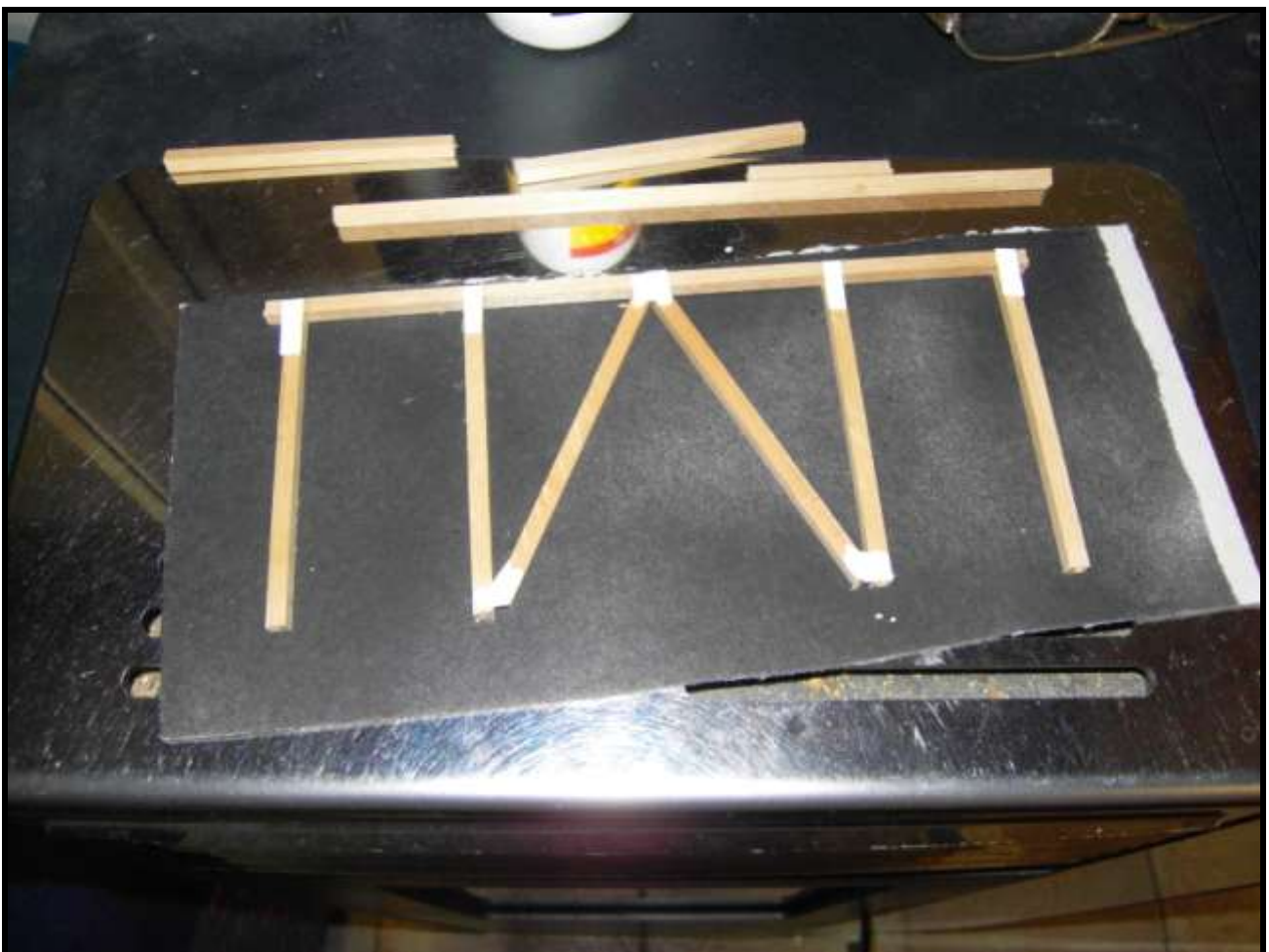
foto n. 11: incollata la travatura della prima struttura
