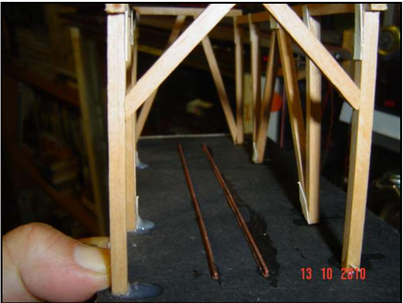
foto n. 22: particolare dei due elementi di controvento corti
