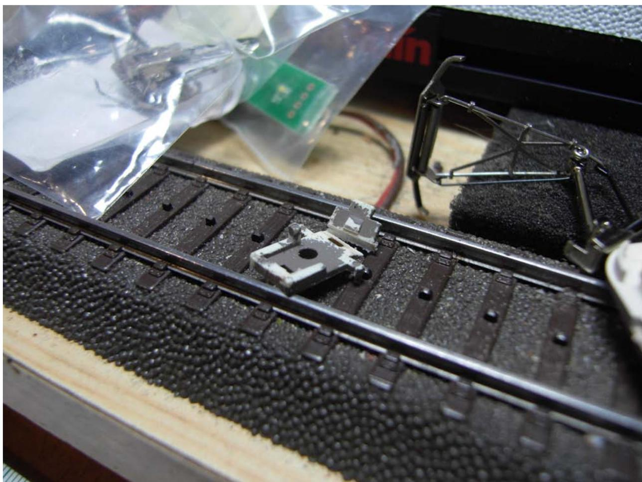
Foto n. 9: la basetta del vecchio pantografo dell'ICE Experimental da modificare tagliando e limando le varie protuberanze
