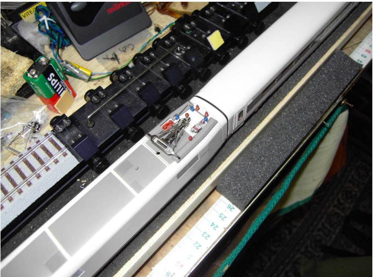
Foto n. 12: il nuovo pantografo in posizione chiusa, montato sull'ICE Experimental
