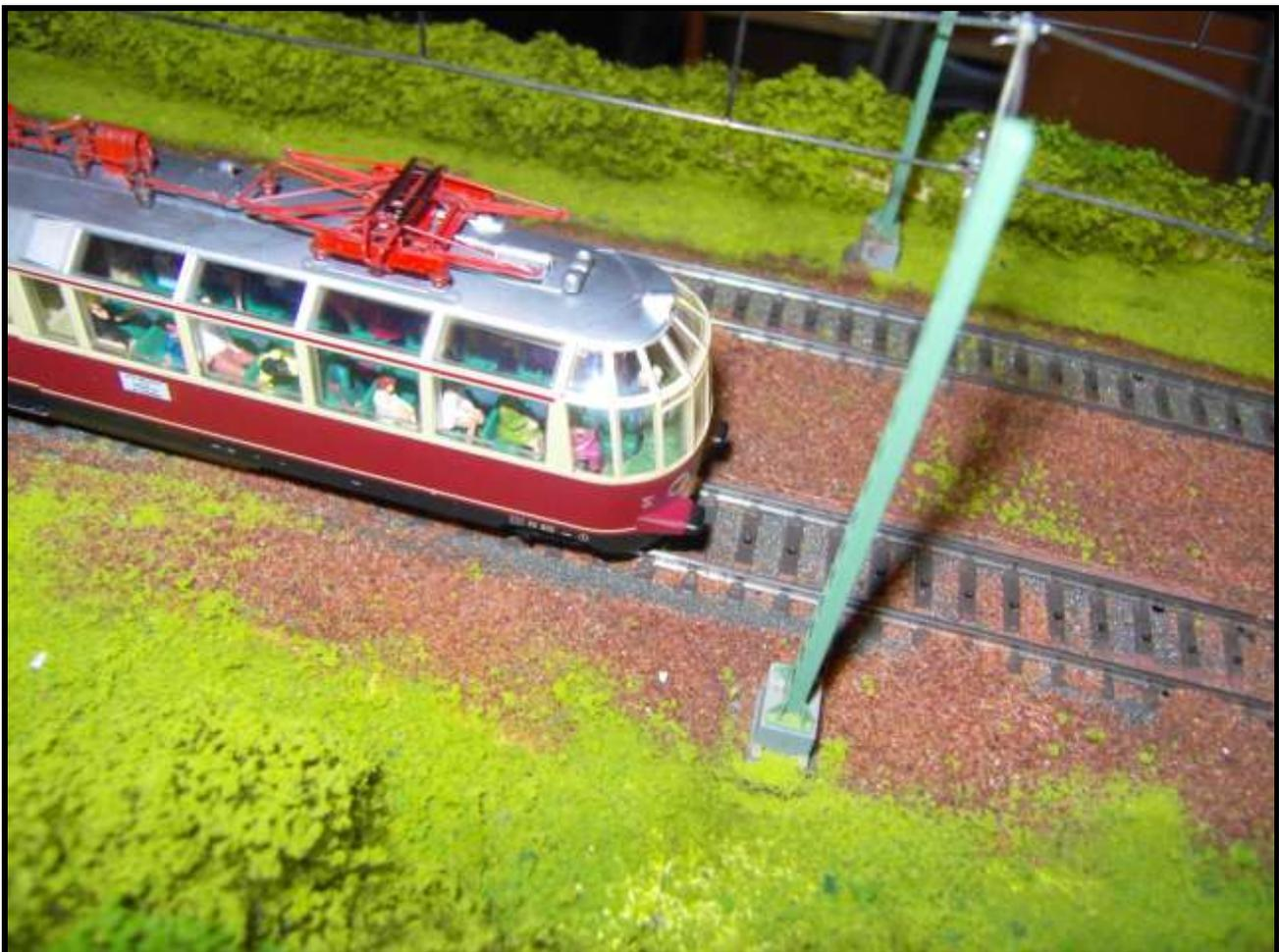
Foto n. 7: ET 91 01, il pantografo abbassato non colpisce la sua apparecchiatura di sollevamento se la diagonale di rinforzo è posizionata internamente.
