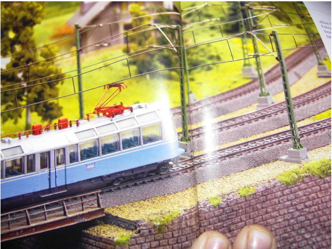
Foto n. 7 (M/M n.2/2010): la 491 Märklin, con pantografo esageratamente abbassato a causa dei pali montati senza lo zoccolo previsto per i binari C
