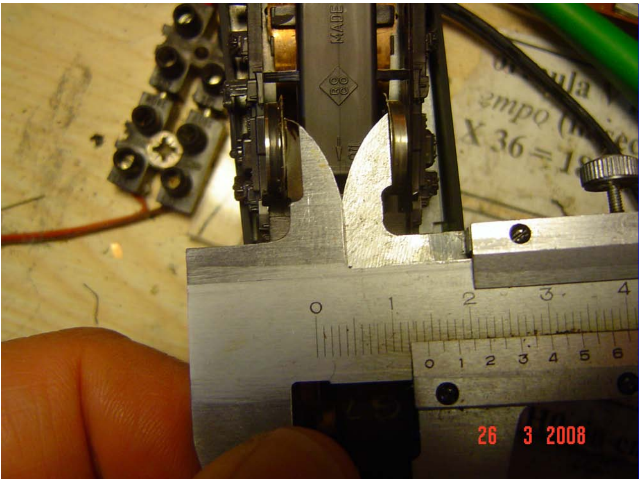
Foto n. 34: uso corretto del calibro per verificare la distanza interna degli assi
