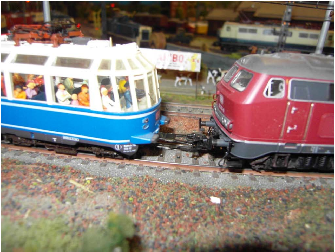
Foto n. 31: particolare del gancio di trazione auto costruito
