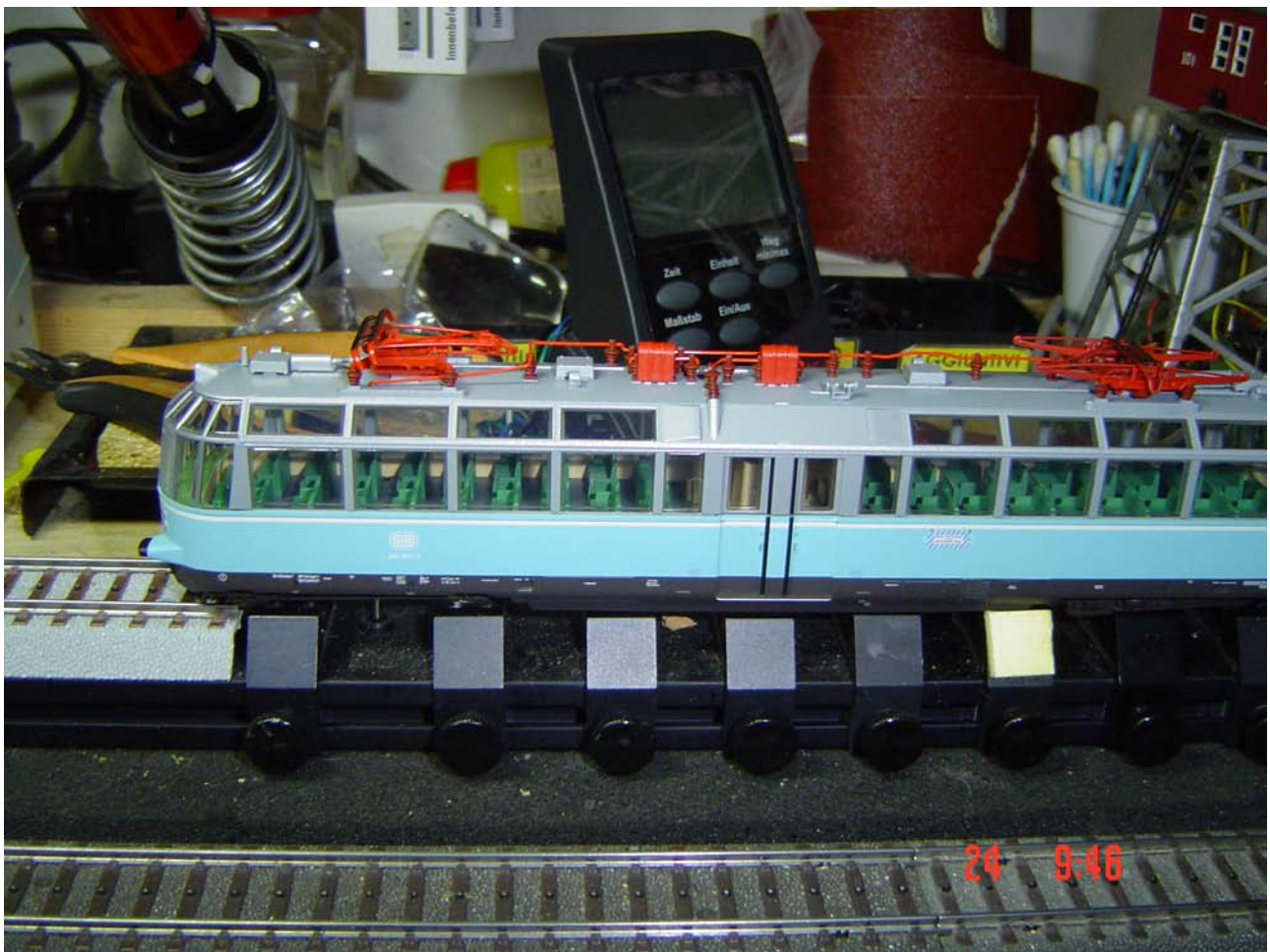
Foto n. 15: la nuova 491 Märklin sul banco di prova a rulli
