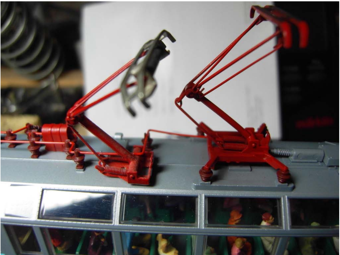
Foto n. 13: il vecchio pantografo a ginocchio Roco (a sinistra) e il Märklin più fine
