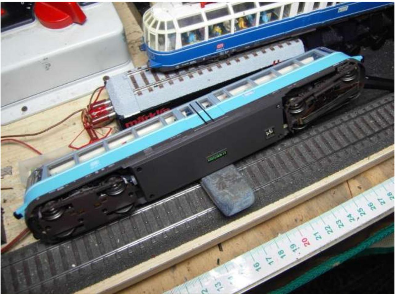
Foto n. 26: la 491 (Märklin), il pattino, lungo, sotto il carrello a destra, folle nel modello e al vero motorizzato
