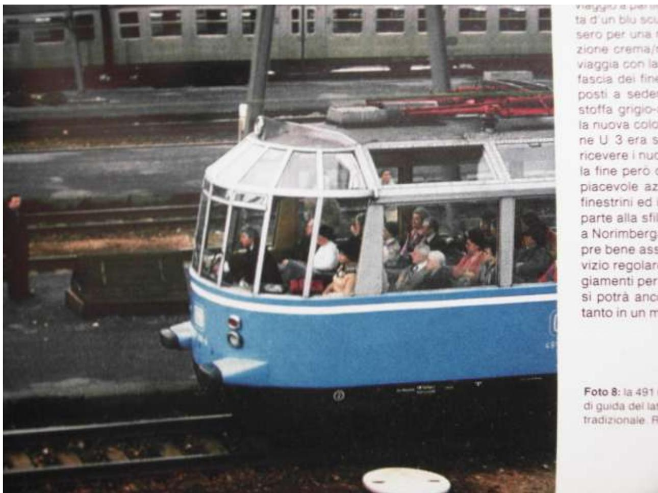
**Foto n. 19: la 491, reale, viaggia a ritroso (pantografo a forbice del lato 2 è visibile abbassato in alto), ma i passeggeri sono comodamente seduti in avanti**
