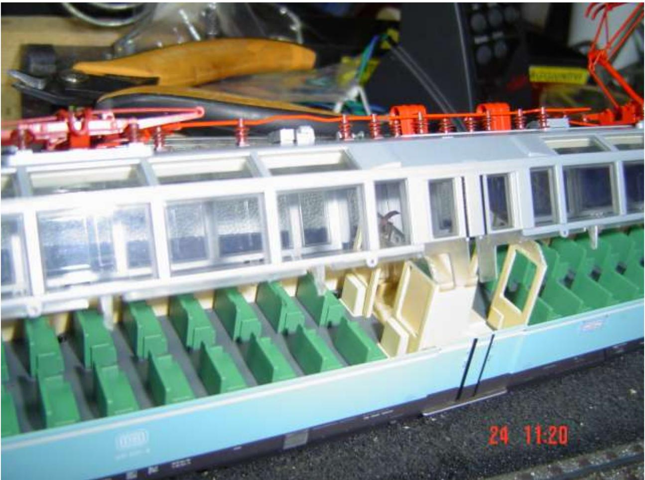
Foto n. 12: 491 Märklin, nel vano centrale si intravedono le lamelle di contatto per le luci, da NON invertire!
