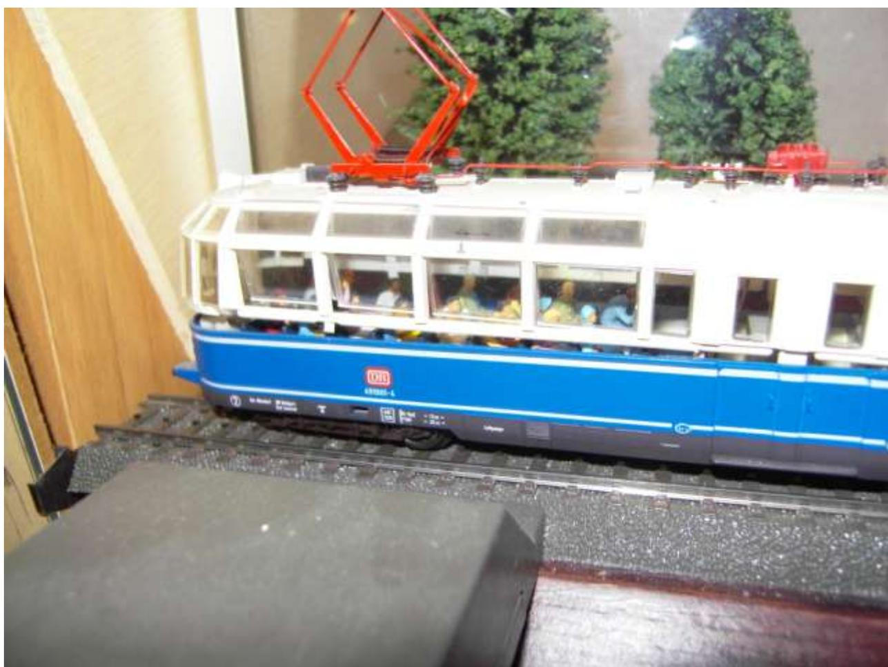
**Foto n. 30: si intravede il famigerato filo rigido in rame nel secondo finestrino stretto da destra, difficilissimo da riposizionare per consentire l'alimentazione dalla linea aerea**
