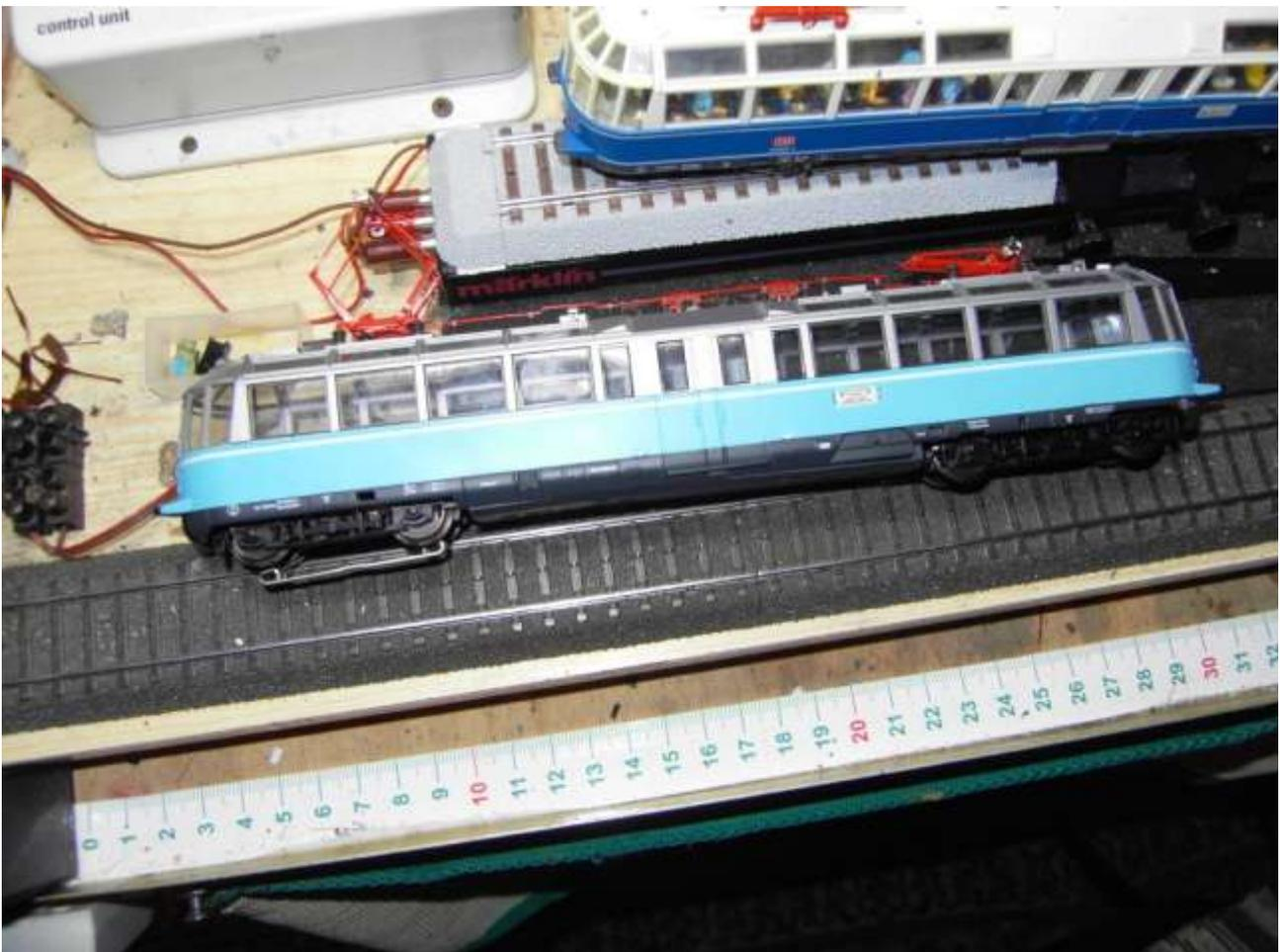
Foto n. 25: la 491 (Roco per il sistema a 3 conduttori), il pattino, necessariamente corto, sotto il carrello folle del lato 2, come al vero.
