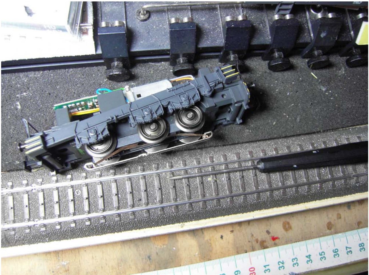
Foto n. 15: i copri carrelli facilmente allontanabili con un mini cacciavite -
