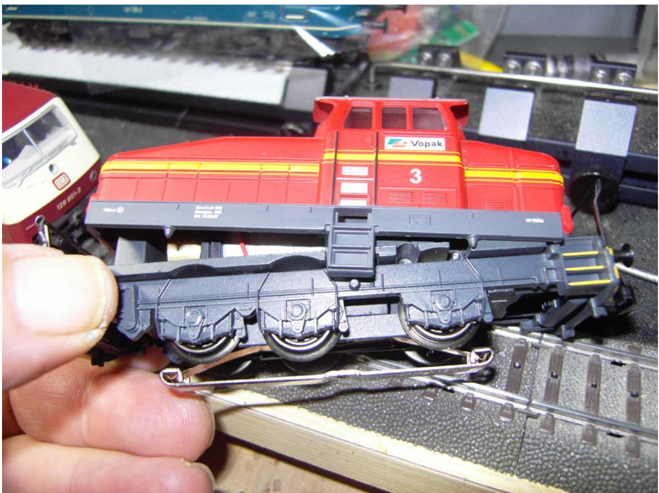
Foto n. 6: le scalette sganciano la carrozzeria da due incastri mascherati da scalini
