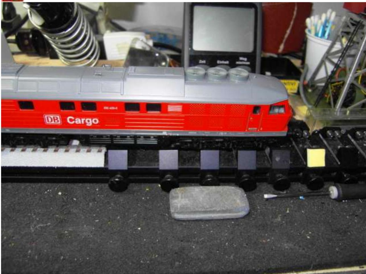
Foto n. 12: la 232 420-0 sul banco di prova a rulli mentre viene caricata nella CS 1
