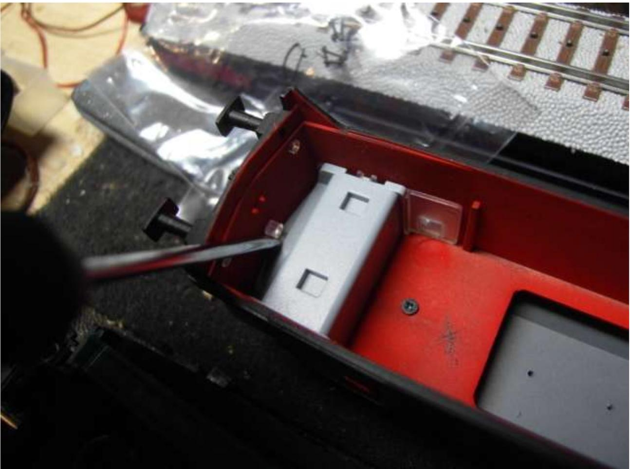
Foto n. 6: il corpo luce da spingere in fuori delicatamente per sganciare la cabina
