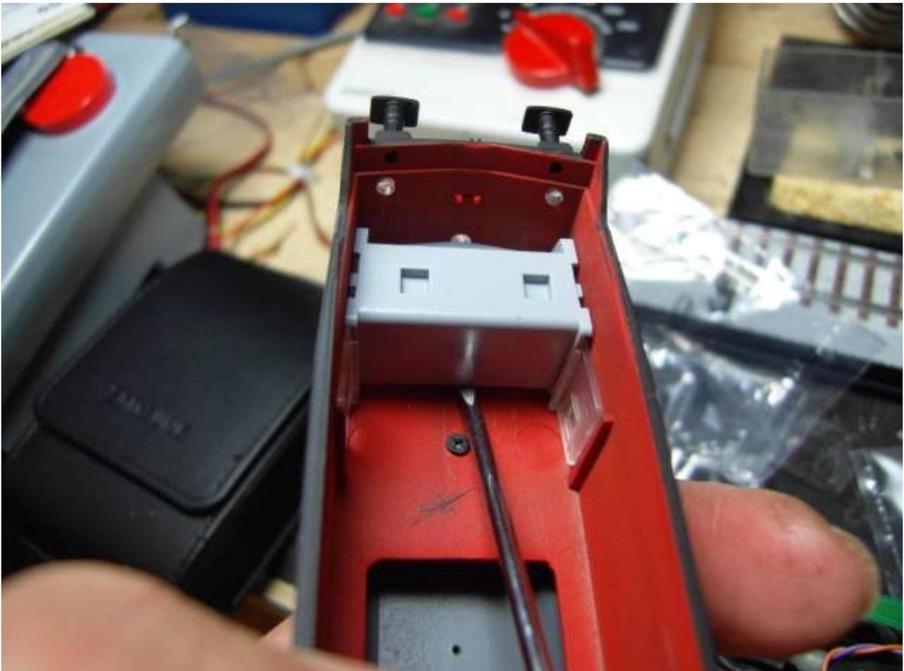
Foto n. 7: far leva delicatamente con un cacciavite per sganciare la cabina
