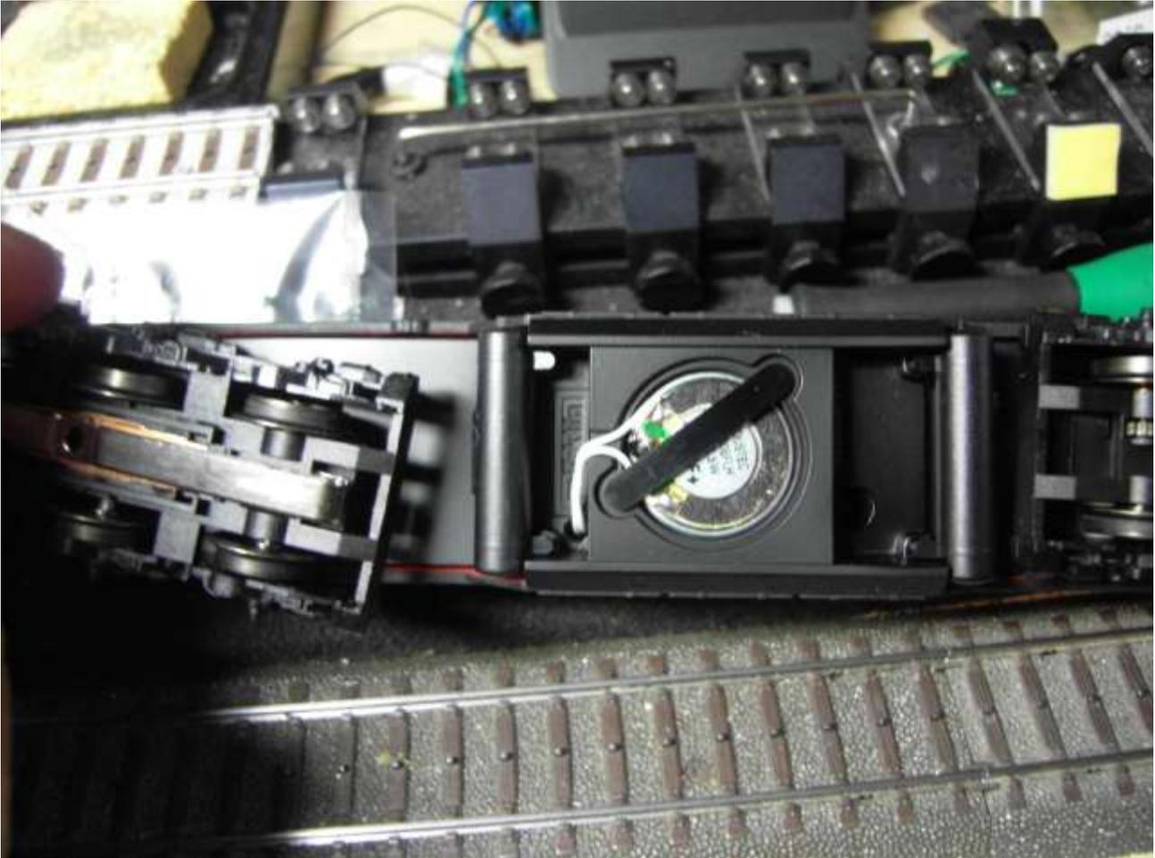
Foto n. 3: nella “Ludmilla” con suoni l’altoparlante è stato ben collocato nel sottocassa, nell’alloggiamento presente nelle loco Hobby a partire dai 21,7 cm –
