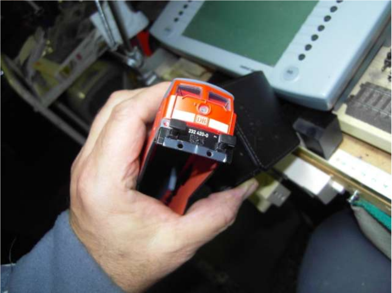
Foto n. 29: nella 232 Märklin, la barra colma lo spazio irrealistico tra i respingenti
