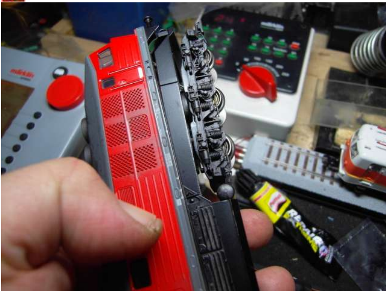
Foto n. 20: si allontana il mantello tirando dai carrelli o sollevando
