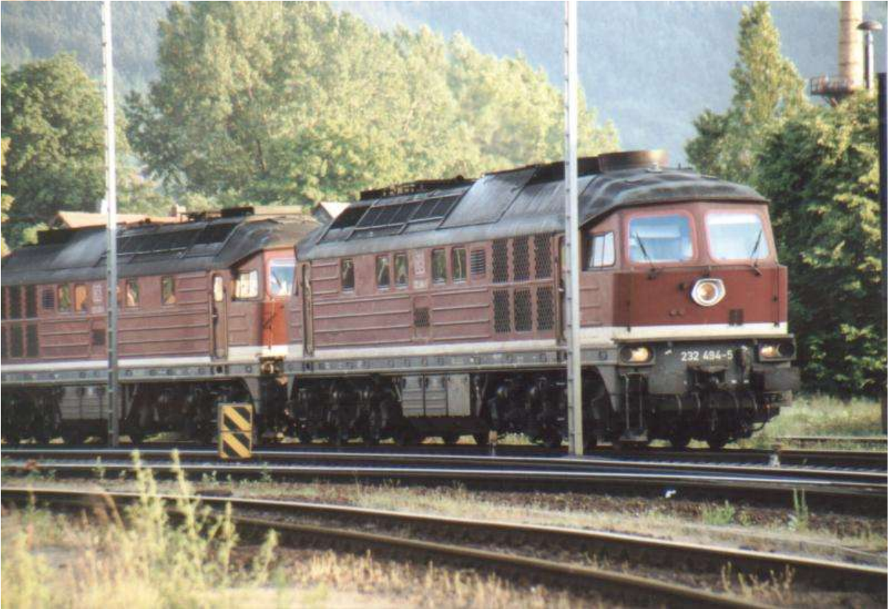
Foto n. 13: doppia di 232 reali, la zona delle griglie laterali non è molto sporca, i tetti sono invece estremamente anneriti dal fumo del gasolio.
