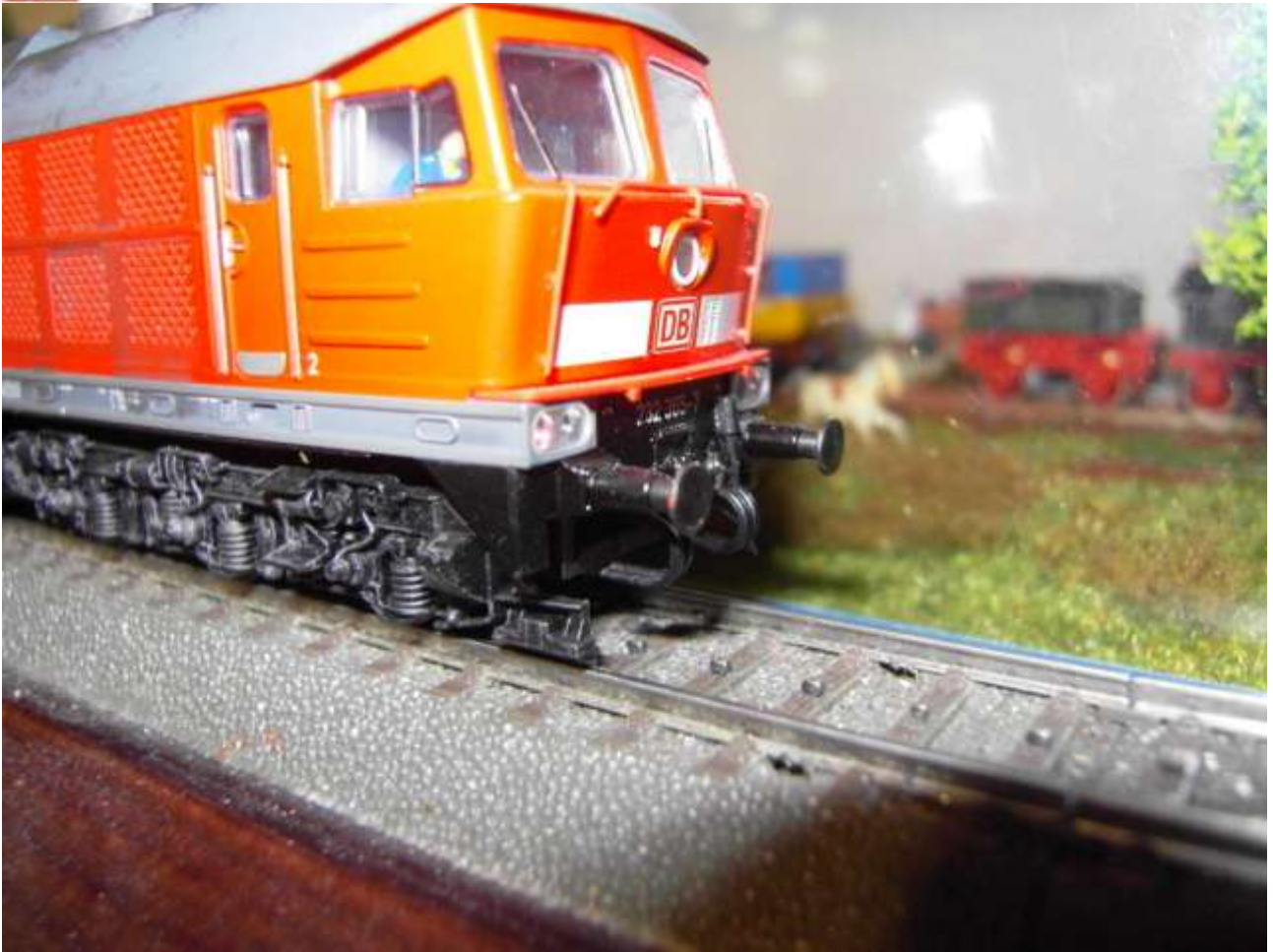
Foto n. 11: 232 365-7 Märklin, carrelli e tetto invecchiati, fragili corrimano anteriori
