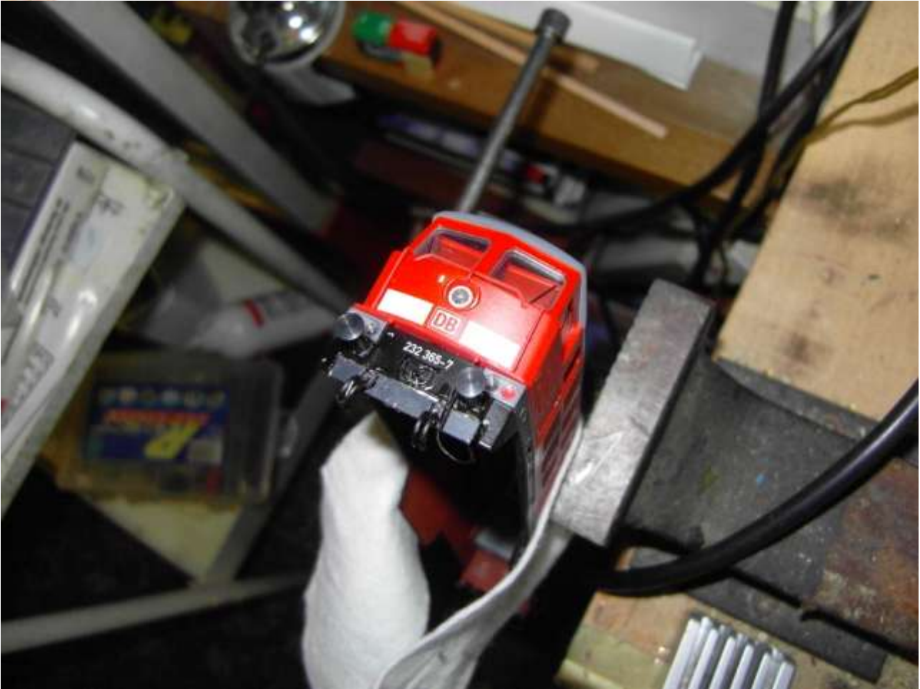
Foto n. 33: 232 365 Märklin, bloccata delicatamente da una morsa per completare l'incollaggio con la colla Extreme, la barra non è ancora stata verniciata
