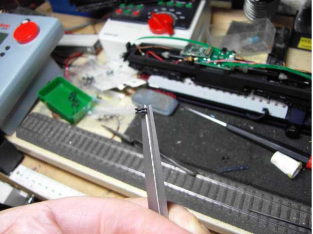
Foto n. 31: i tubi dei freni, derivati dalla carenature 220989, vanno accorciati
