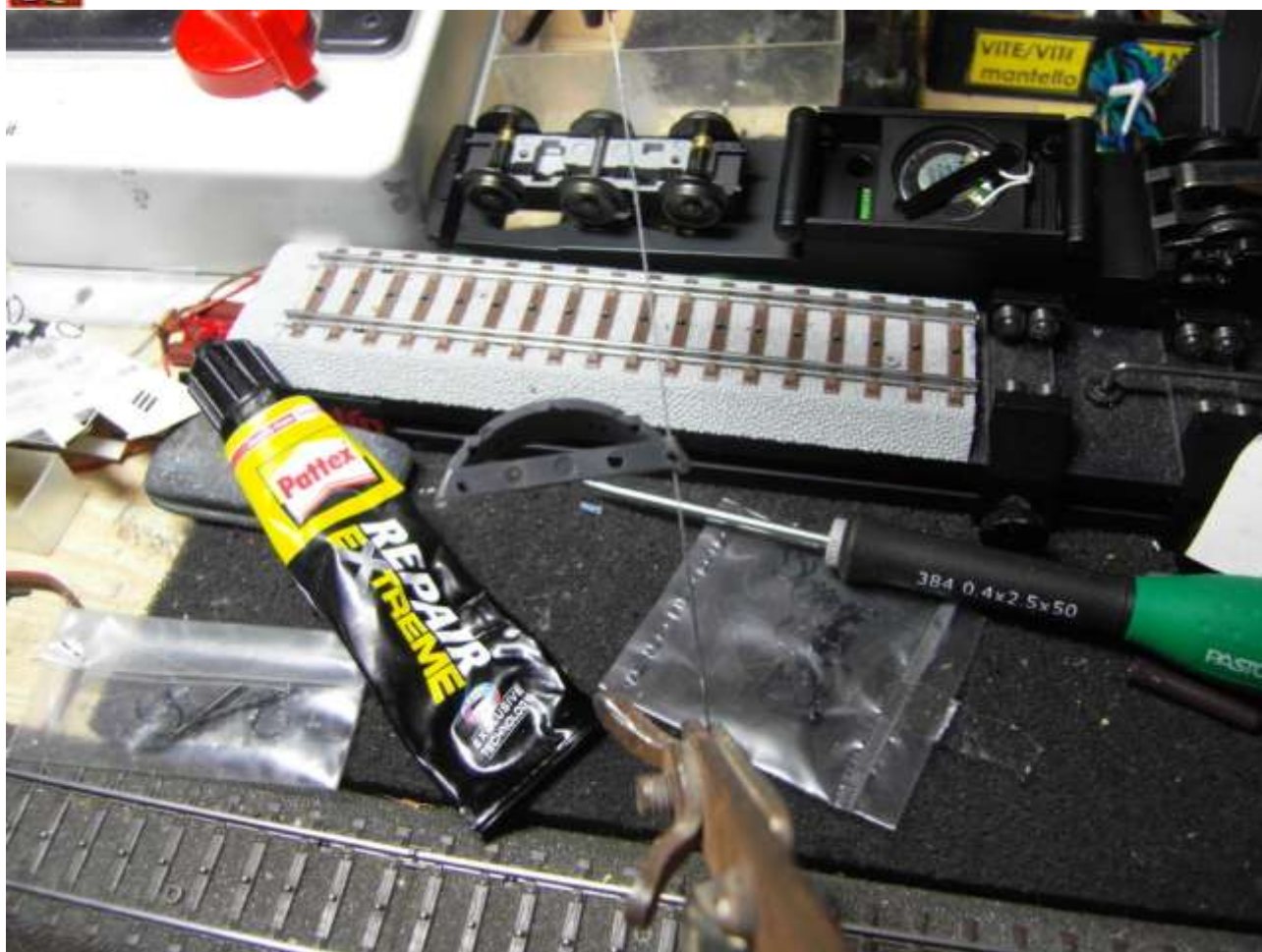
Foto n. 28: dove tagliare con il traforo e la colla Extreme della Pattex
