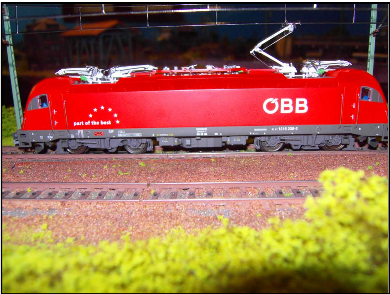
Foto n. 33: le scalette d'ingresso in cabina sono solidali con i carrelli
