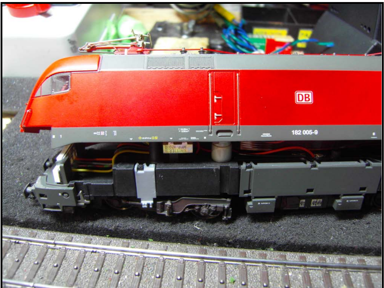
Foto n. 7: lato sinistro del carrello con Bremsanzeige visibile e mantello sollevato
