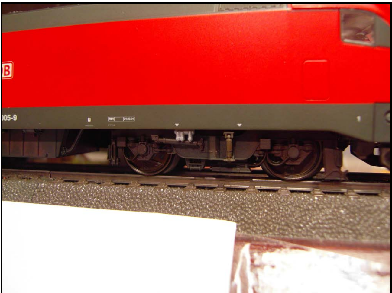
Foto n. 6: lato destro del carrello (cabina 1) di 182 DB AG con Bremsanzeige
