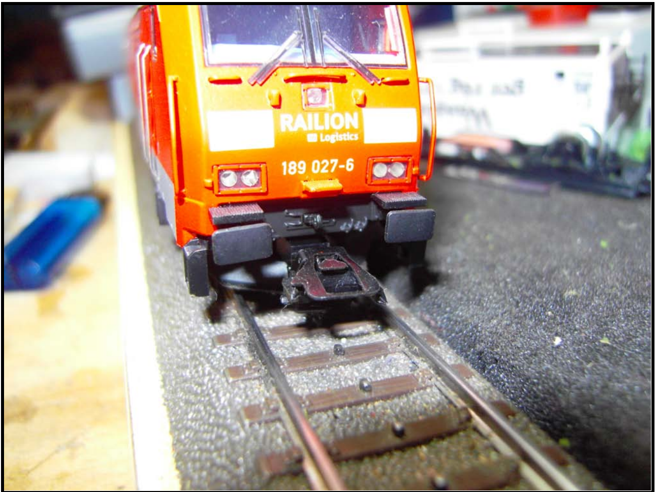
Foto n. 7: l'anteriore della 189 027-6 Railion non ancora modificato, abbozzo dei tubi dei freni e gancio semplificato
