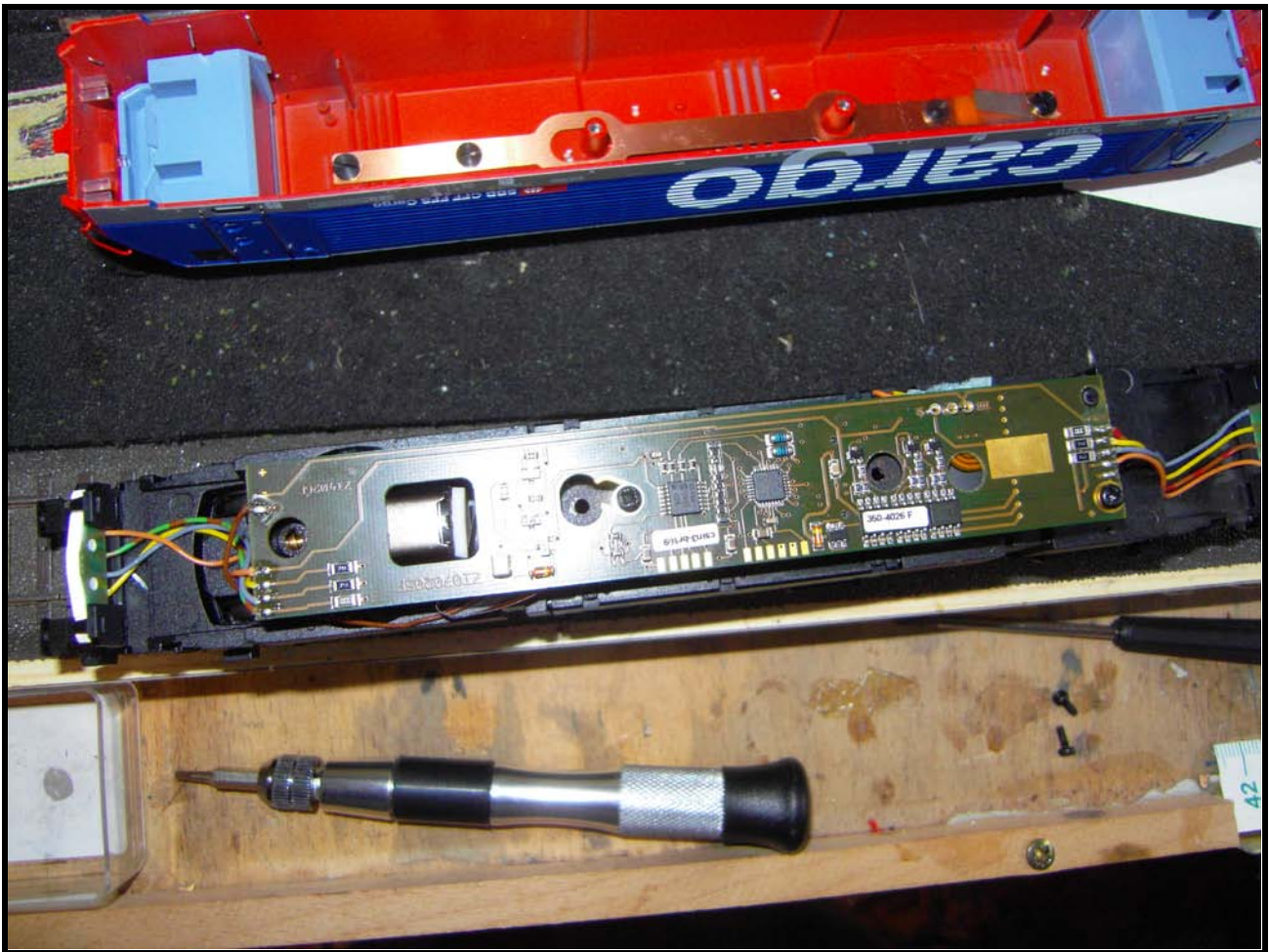
Foto n. 4: mantello e interno della 474, notate in alto i diffusori centrali che bloccano le cabine e a destra sul circuito il riquadro per il contatto linea aerea
