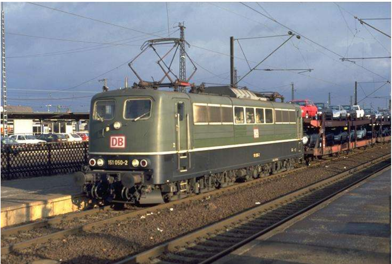
Foto n. 16: 151 050-2 DB AG, con il rec a imbuto e i tubi freni portati molto bassi
