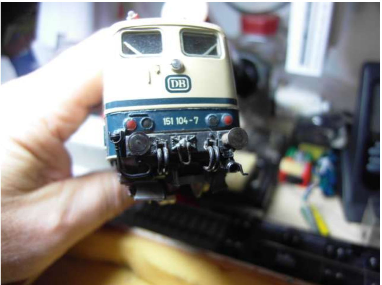
Foto n. 18: aggiunto il rec destro e incollato il rec ad imbuto nella 151 104-7
