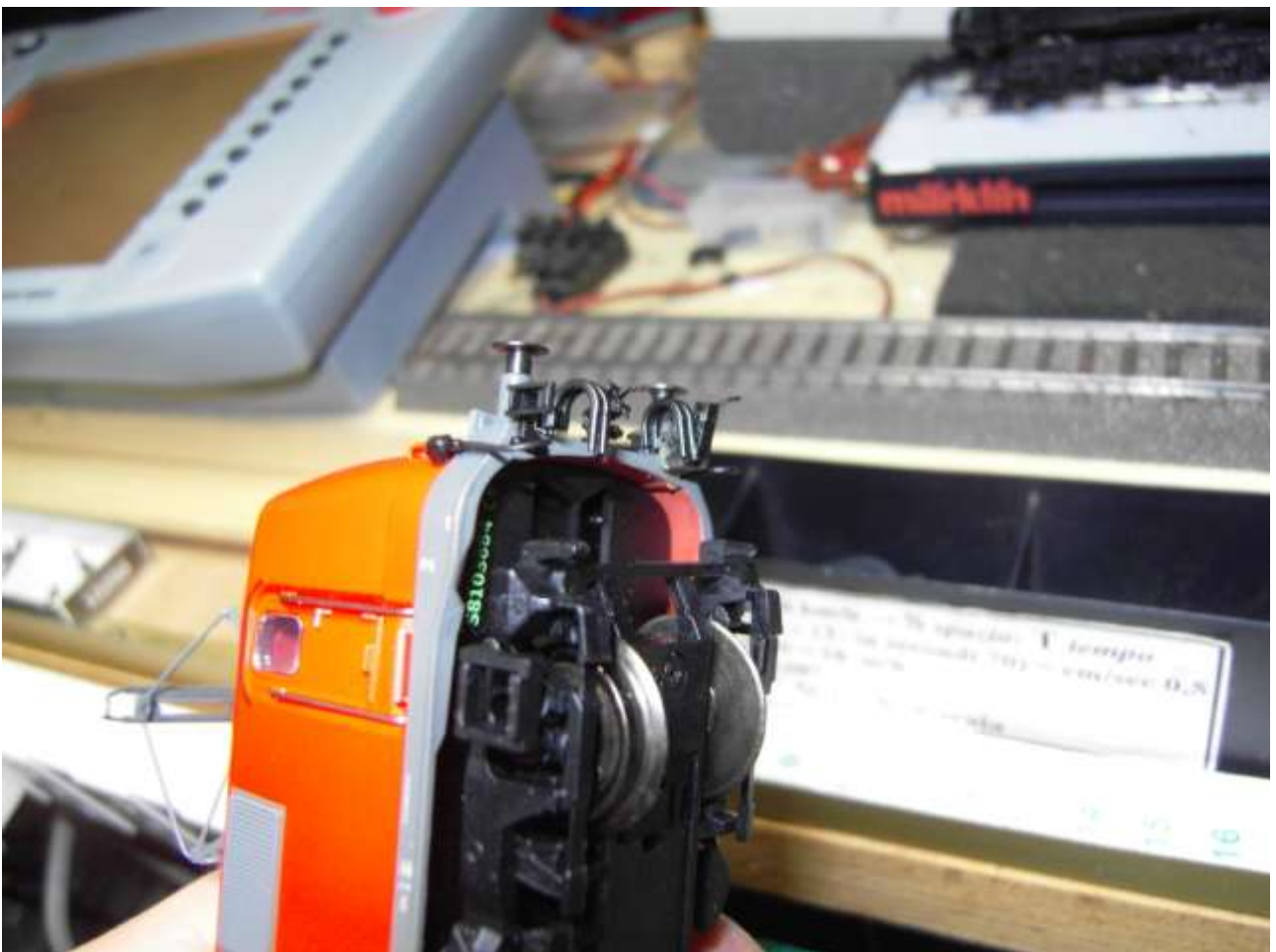
Foto n. 33: 141 061-2 Märklin, anteriore modificato con il rec e doppi tubi dei freni
