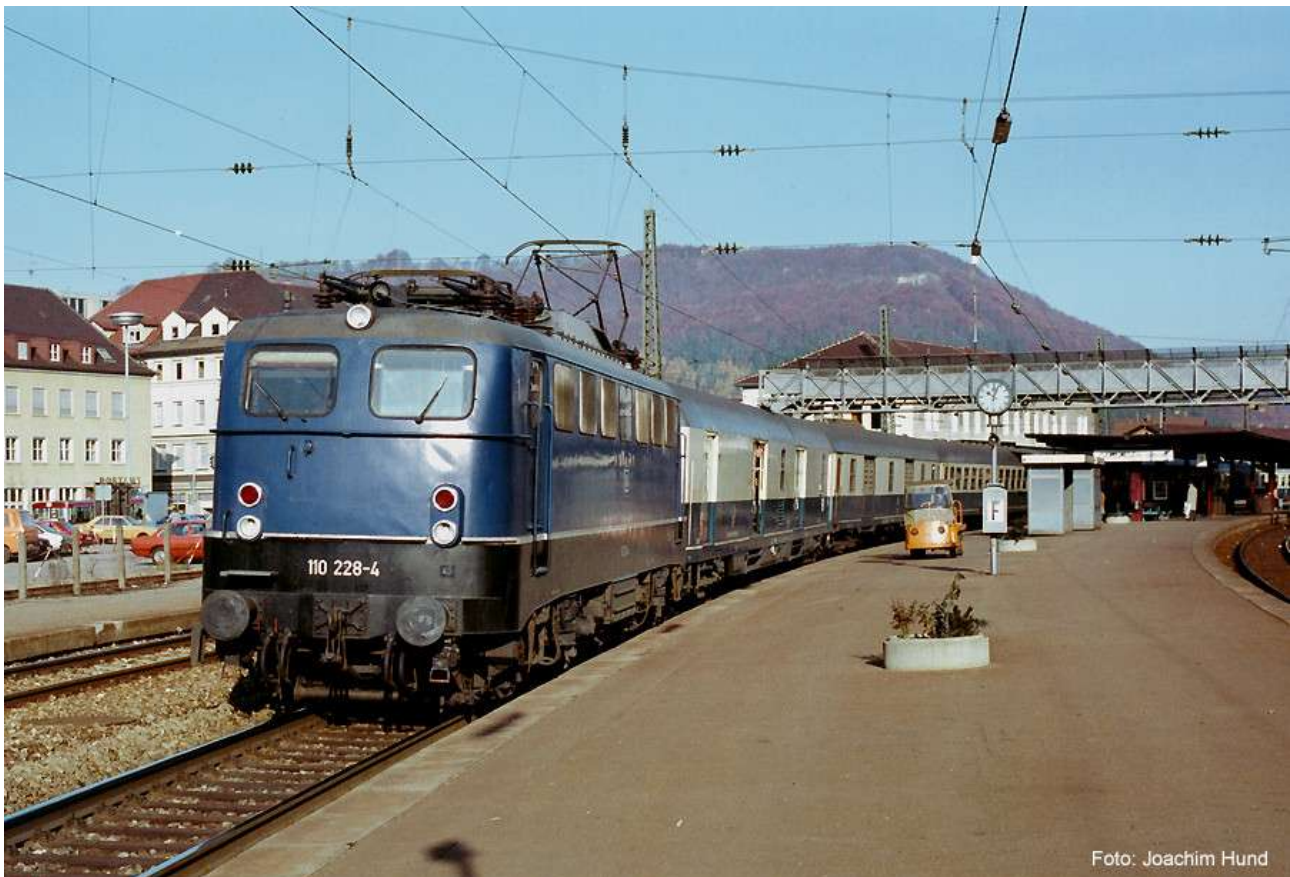
Foto n. 1: 110 228-4 DB al traino di carrozze InterCity tipo Am 203, non ha il rec femmina: visibili in basso sotto i respingenti, solo gli appigli simili a quelli in dotazione alle E 03/103.
