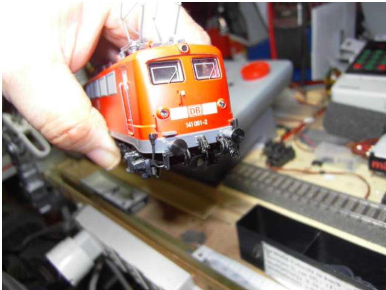
Foto n. 24: 141 061-2 Märklin, anteriore modificato con il rec e doppi tubi dei freni
