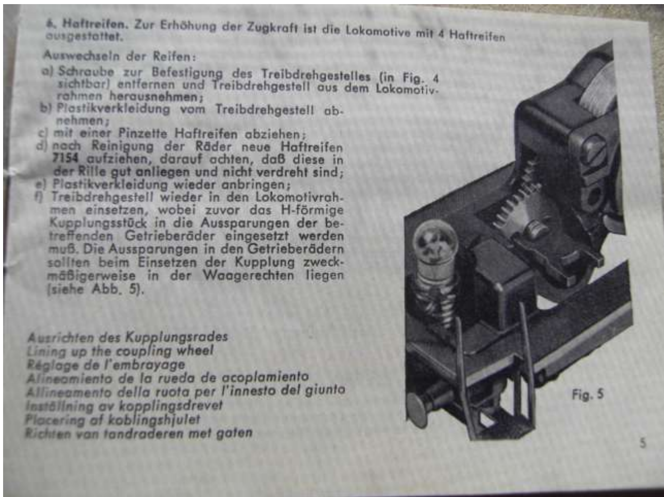
Foto n. 12: il giunto ad "H" innestato nelle ruote dentate nelle 212 (art. 3072) –
