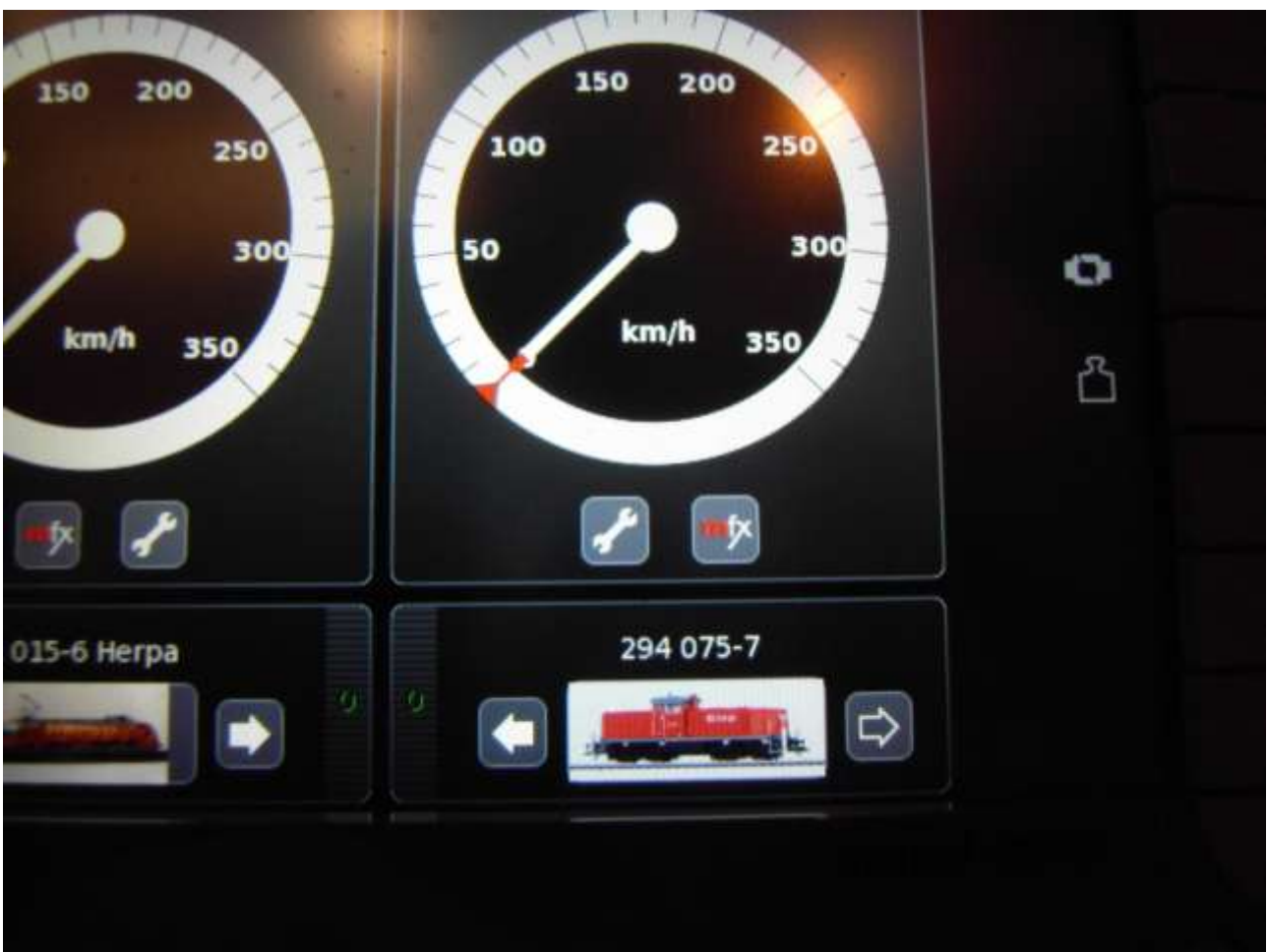
Foto n. 3: il decoder della 03 1001 segnala il riconoscimento sul pannello della CS
