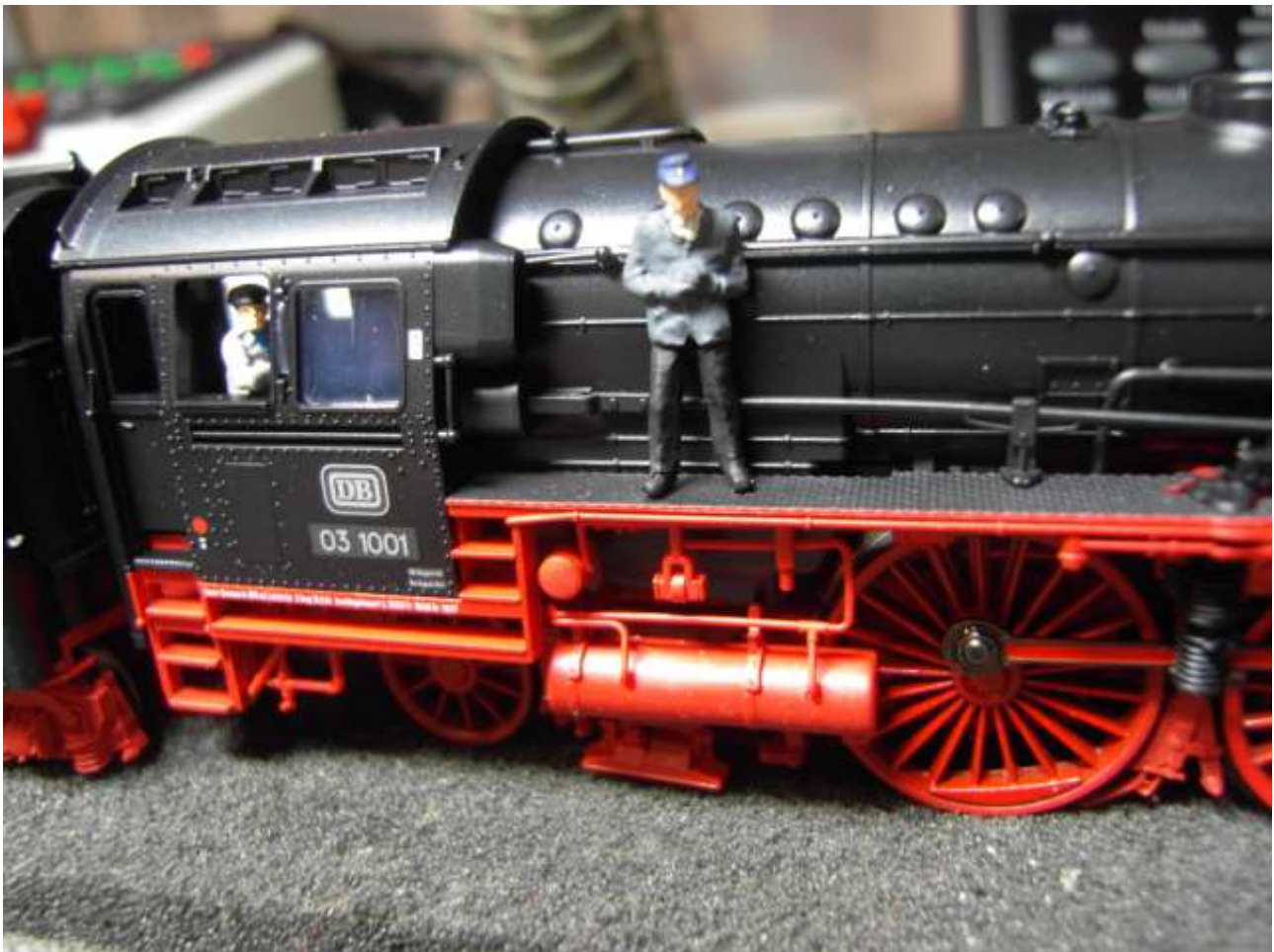
Foto n. 19: 03 1001, leva dell'inversione di marcia (dietro le gambe del fuochista), tubazioni riportate, serbatoio, pompe e dispositivo "Indusi" della locomotiva
