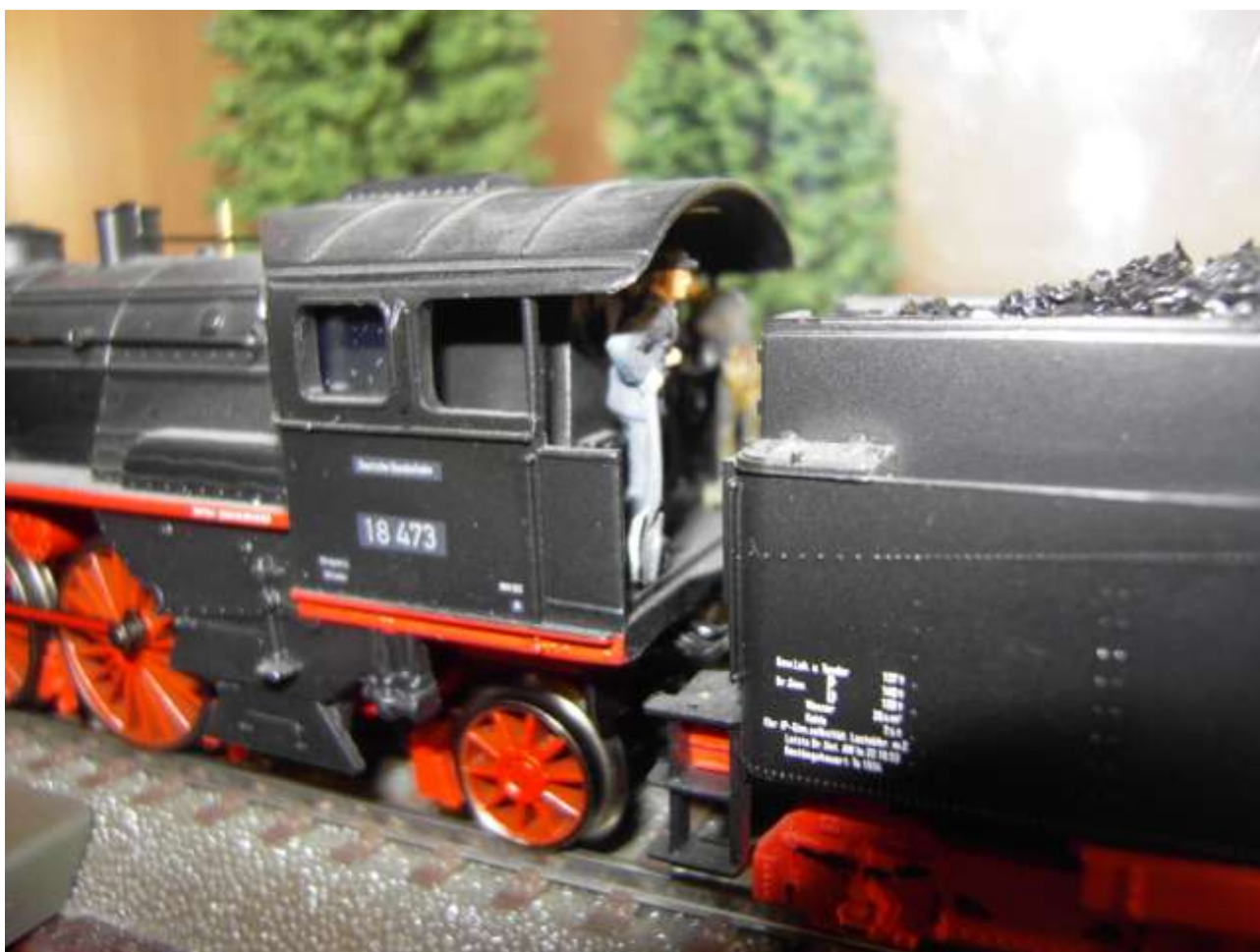
Foto n. 4: Br 18 473, con la cabina occupata dal motore (nascosto dalla capsula metallica) e la bocca del forno arretrata
