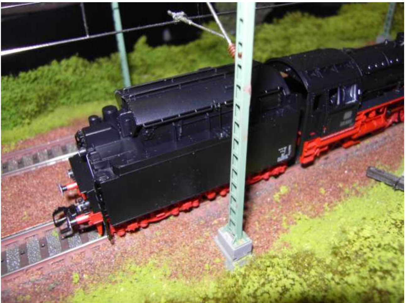
Foto n. 25: 03 1001, il tender chiuso ha tre serie di mancorrenti per lato
