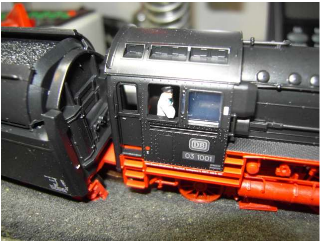
Foto n. 21: 03 1001, nel tender accennato il dispositivo "Stoker", il macchinista
