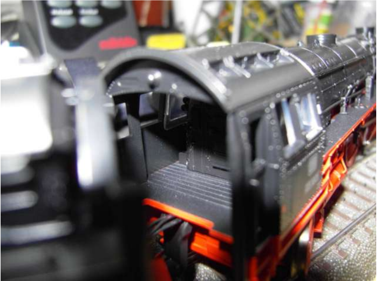
Foto n. 9: 03 1001, con la cabina parzialmente invasa dal motore: l'ombra della foto
