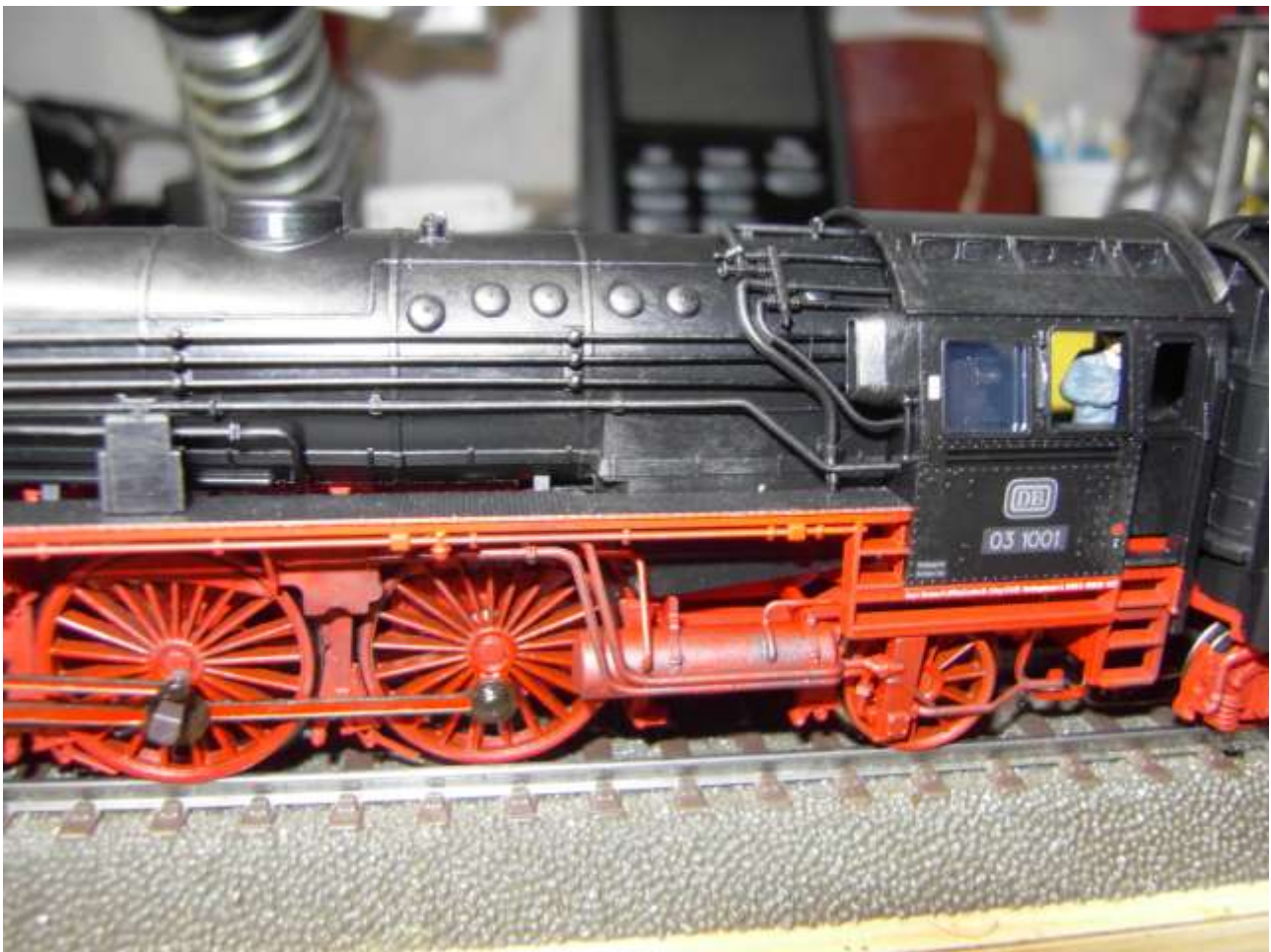
Foto n. 20: 03 1001, tubazioni riportate su caldaia e in basso, serbatoio
