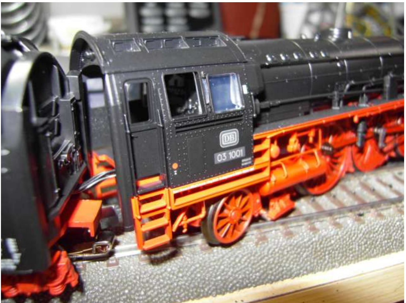
Foto n. 18: 03 1001, cavi elettrici quasi tutti neri tra tender e locomotiva
