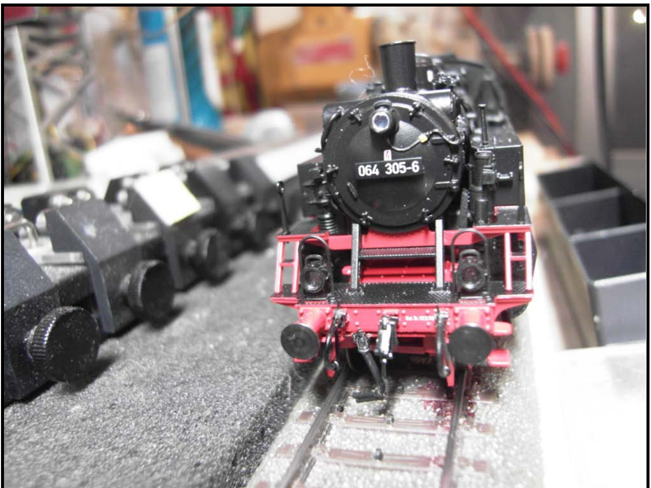
Foto n. 27: condotta del rec vapore Roco, in basso a sinistra, sotto il pancone
