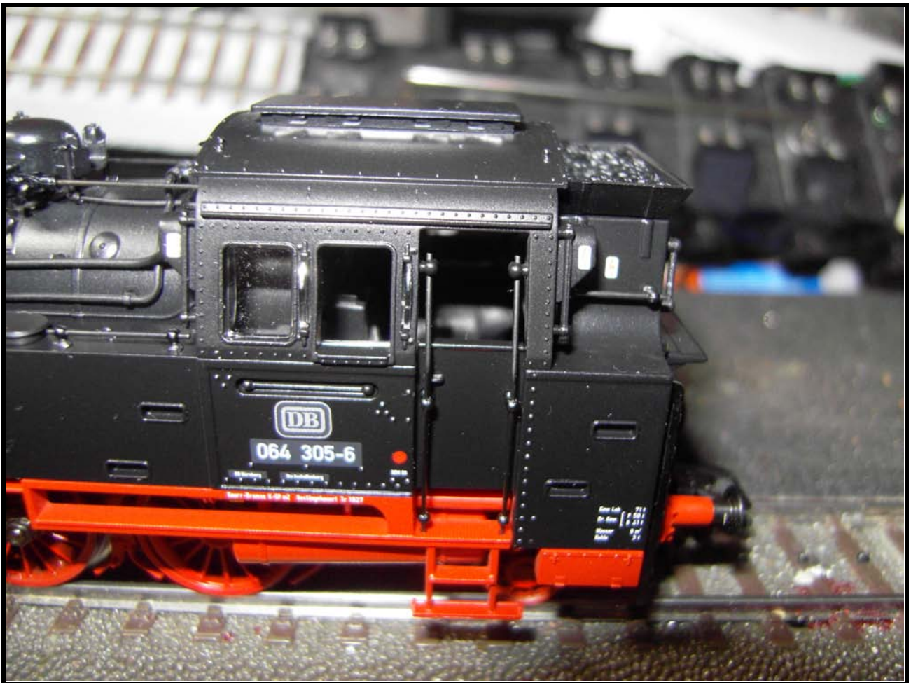
Foto n. 21: i vari corrimano della cabina e della carboniera
