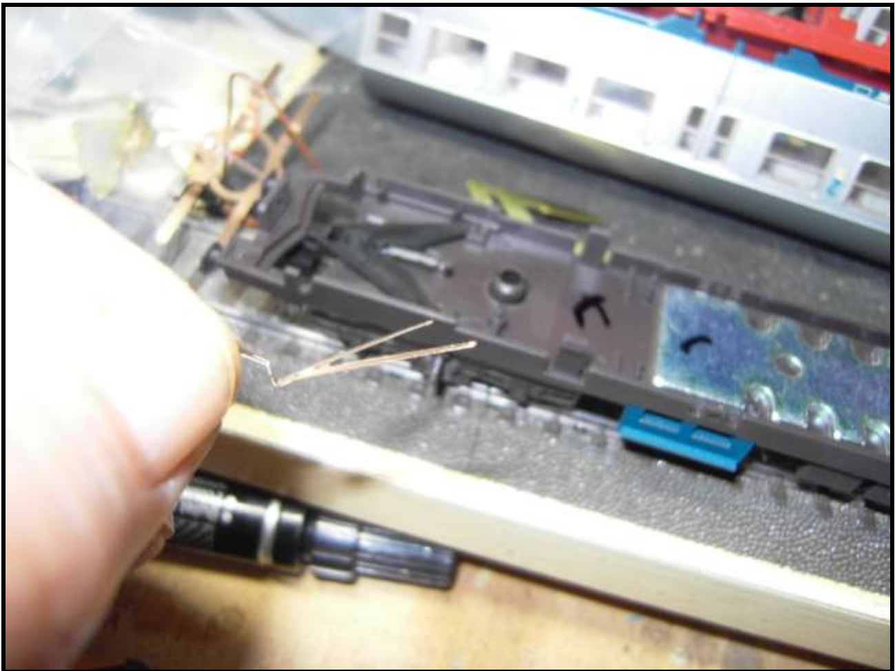
Foto n. 12 : la molletta a "V" necessaria per il collegamento del gancio conduttore
