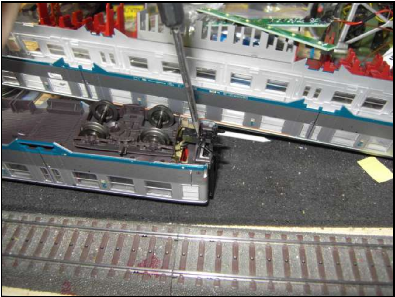
Foto n. 9: 1° passaggio allontanare i ganci corti standard
