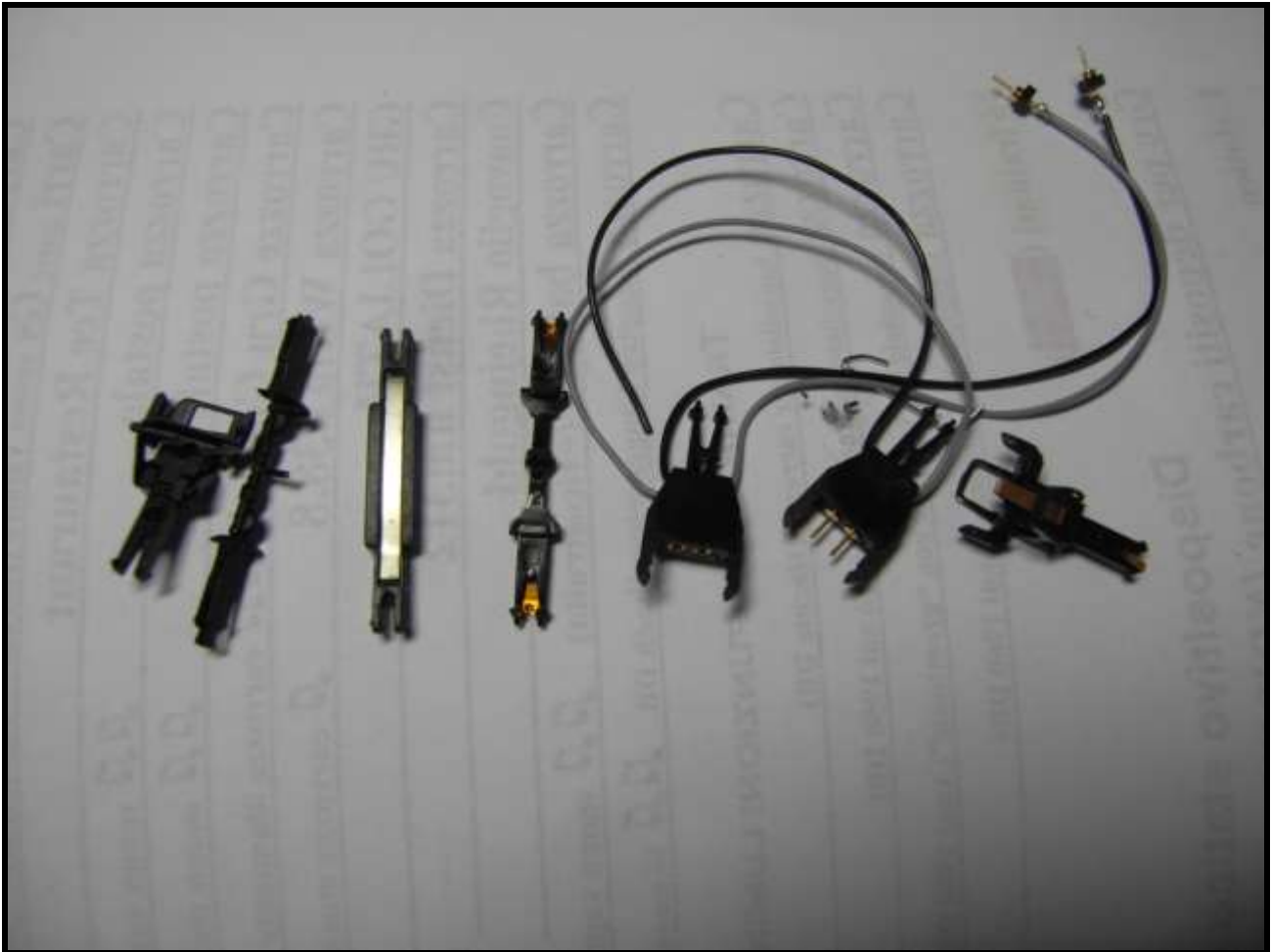
Foto n. 2: ganci Märklin fissi e non, tutti con attacco NEM. Da sinistra: gancio corto standard, gancio fisso senza funzioni di collegamento elettrico, due tipi di ganci fissi con collegamento elettrico, ganci bipolari femmina e maschio, gancio corto sezionabile 72020 0 72021.
