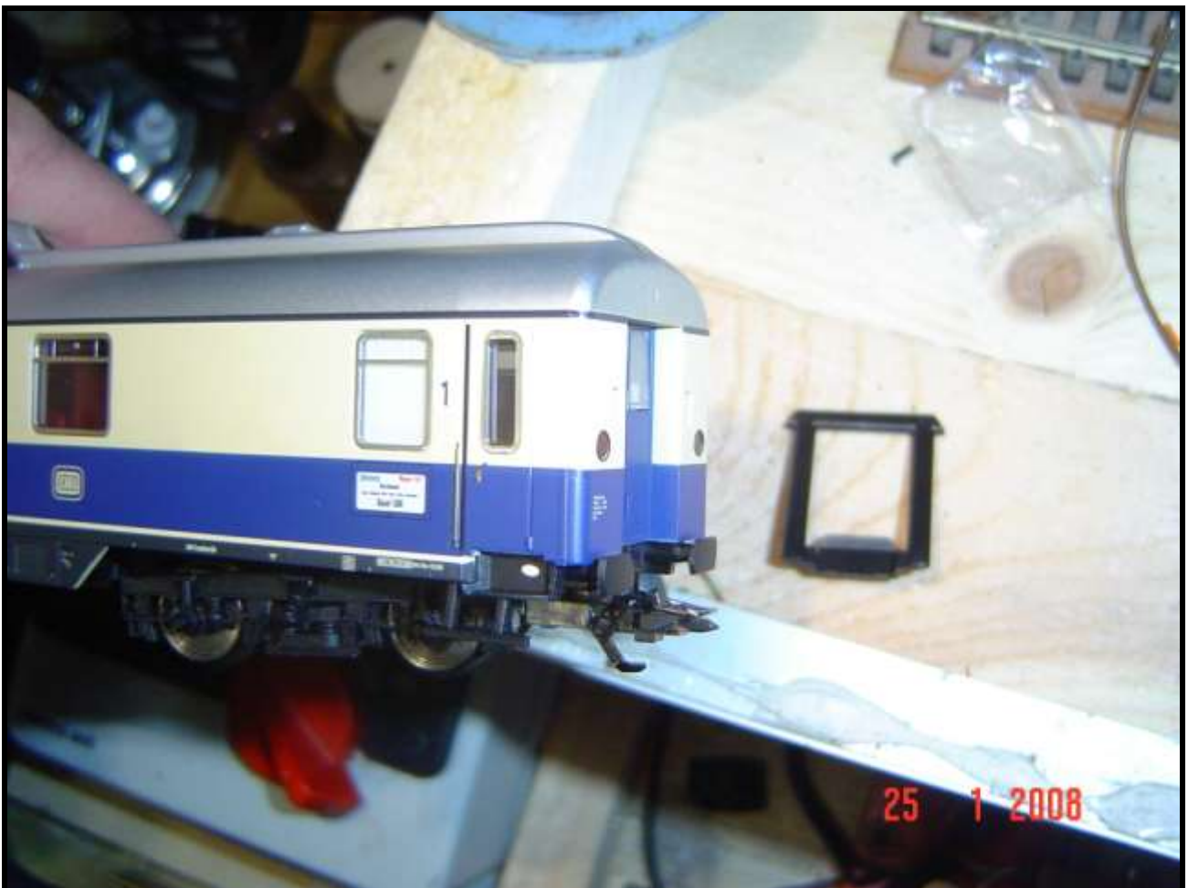
Foto n. 14: allontanando i soffietti si può sganciare la carrozzeria
