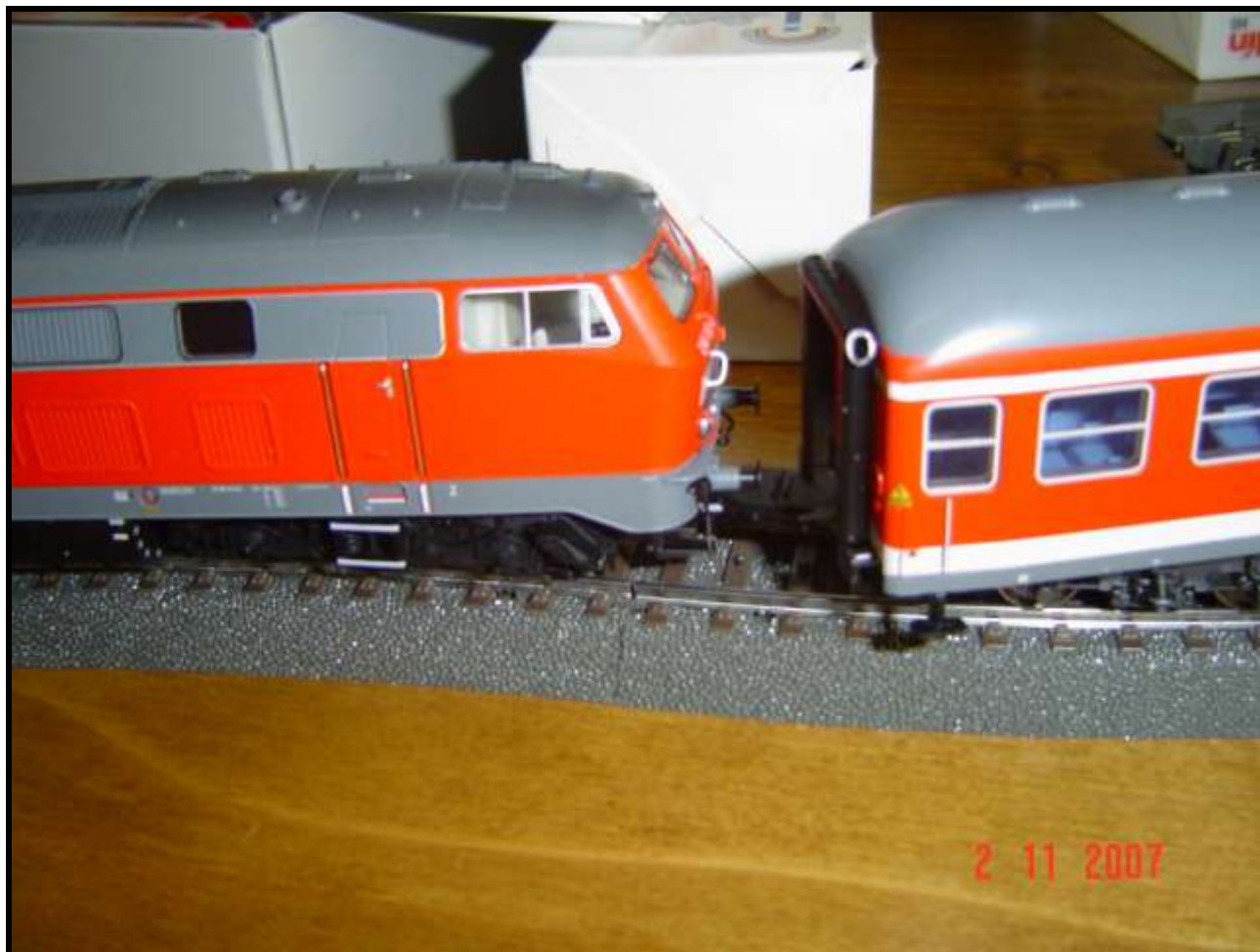
Foto n. 7: convoglio bloccato tramite ganci bipolari fissi, in grado di affrontare anche curve e controcurve strettissime.
