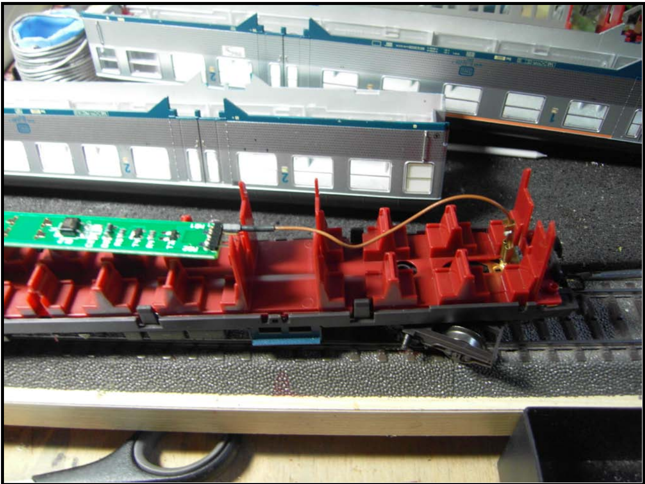
Foto n. 14: collegamento tra piastra e dispositivo a led di illuminazione.
