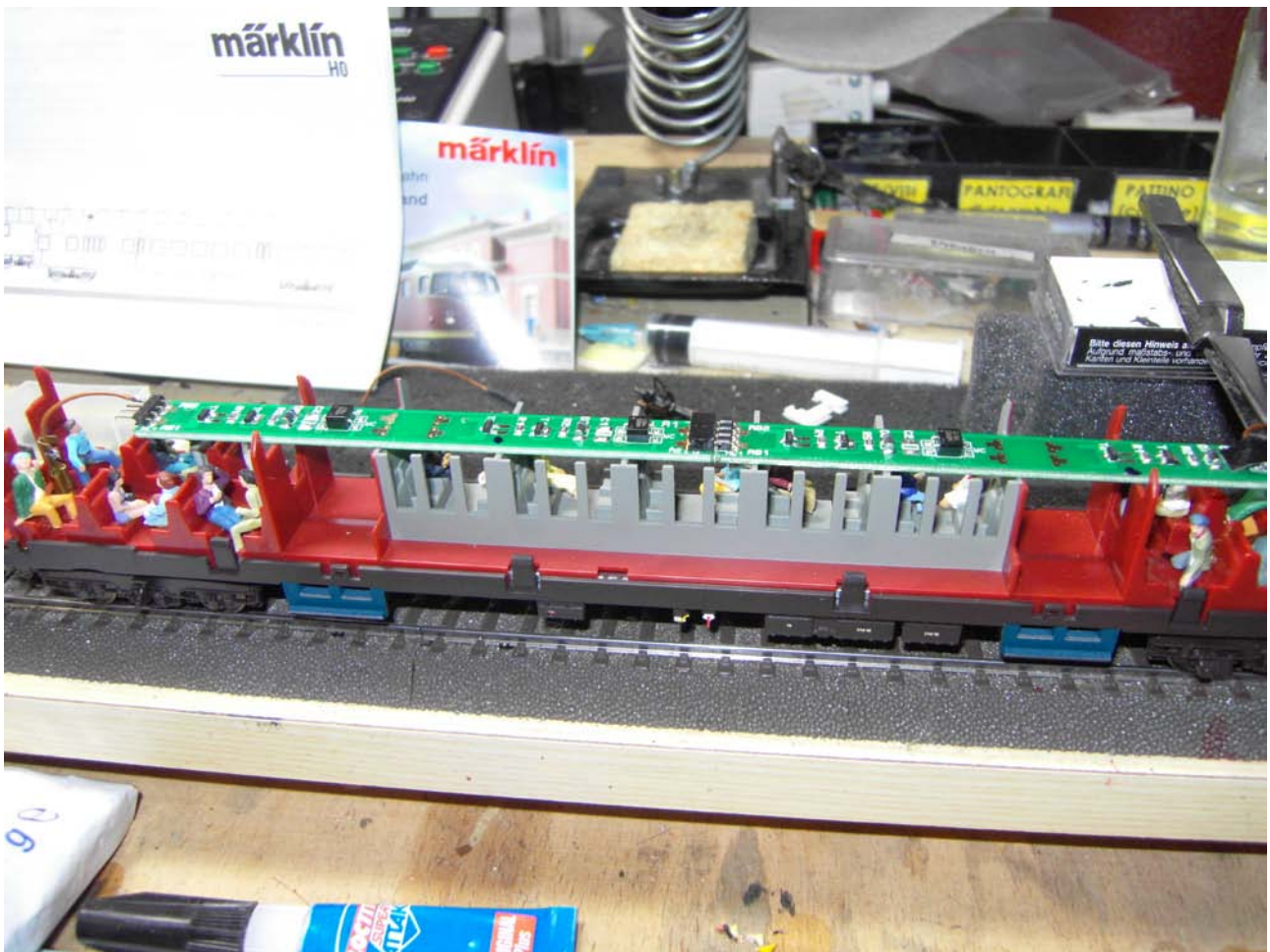
Foto n. 24: connessione tra due dispositivi a led
