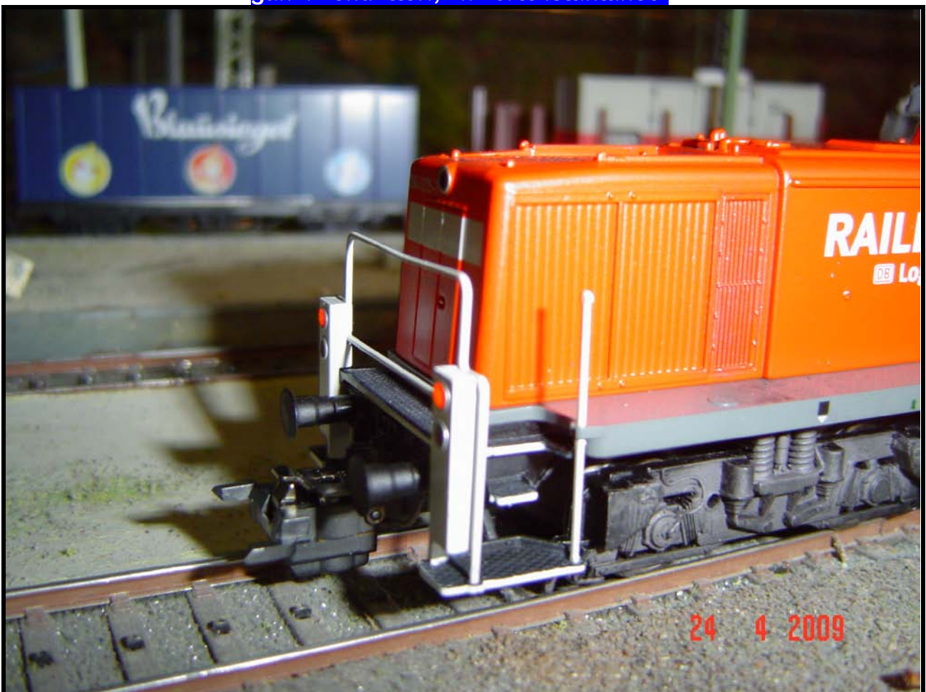
Foto n. 28: i nuovi telex (qui nella 294 075-7) non causano corti con i ganci 72021
