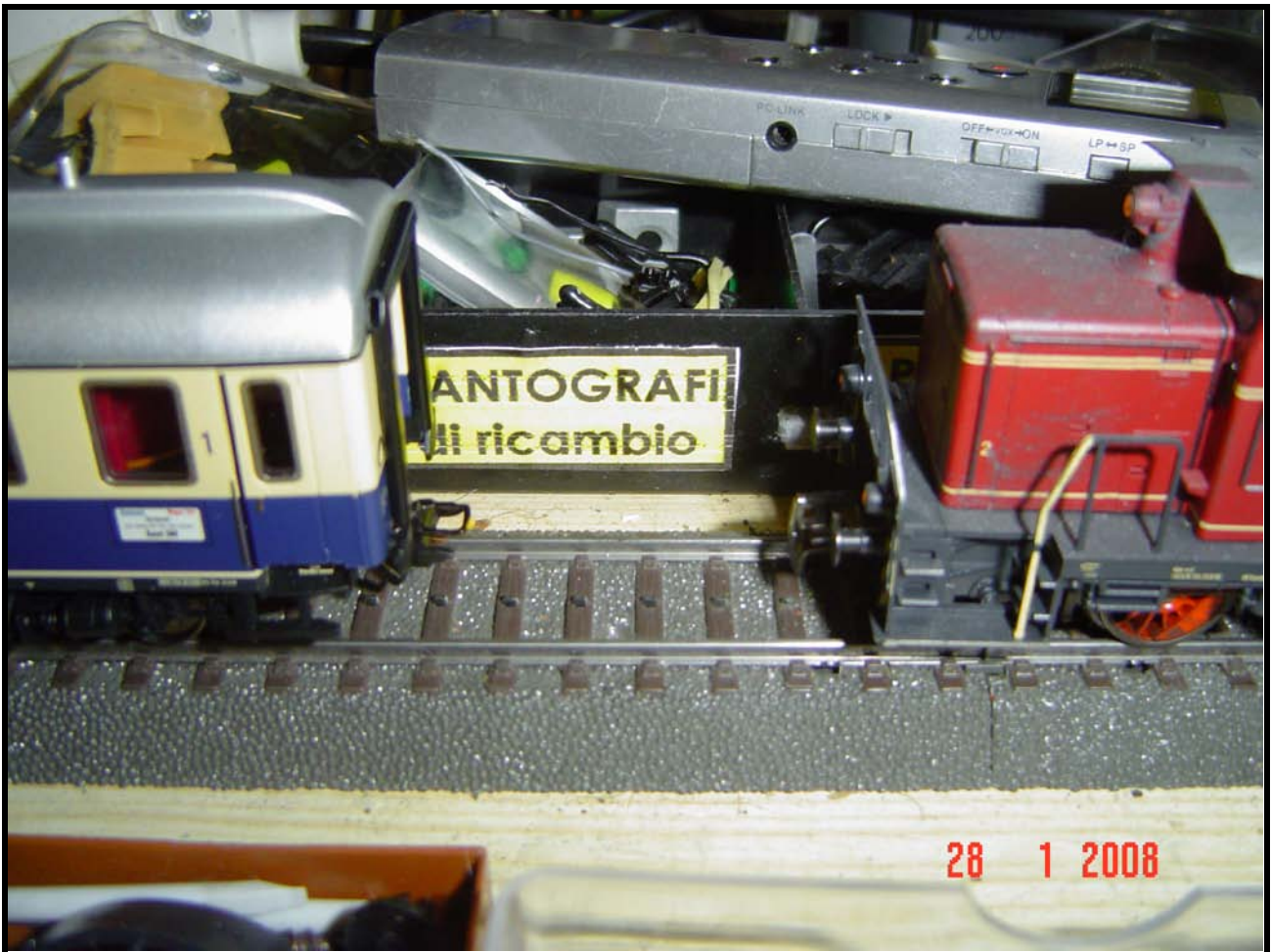
Foto n. 27: il gancio telex delle V 60 è collegato a massa e provoca, toccando i ganci conduttori, un corto istantaneo!
