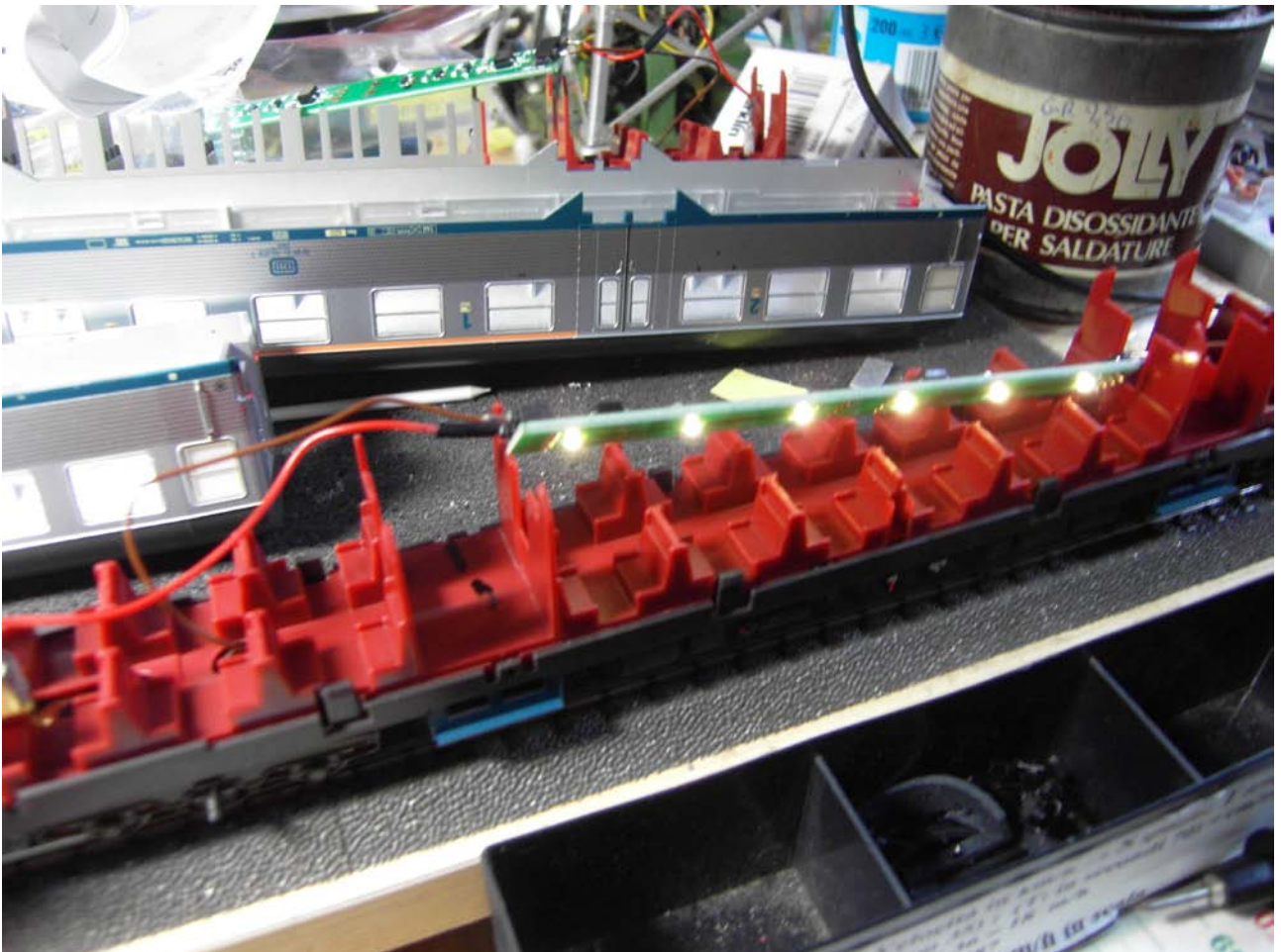
Foto n. 33: le prove possono essere effettuate anche con una sola piastra led
