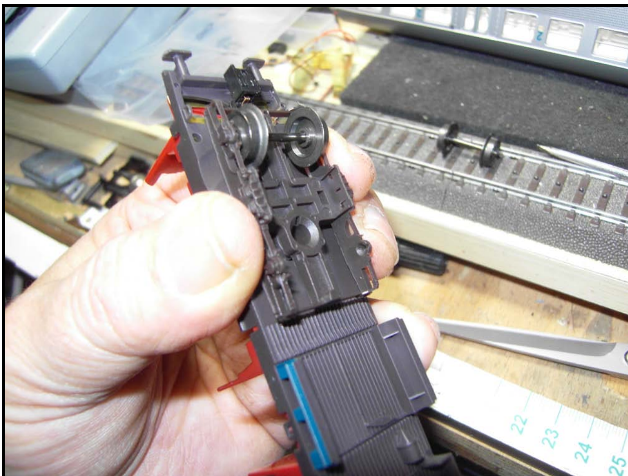
Foto n. 15: si deve per prima cosa allontanare uno degli assi nel carrello prescelto
