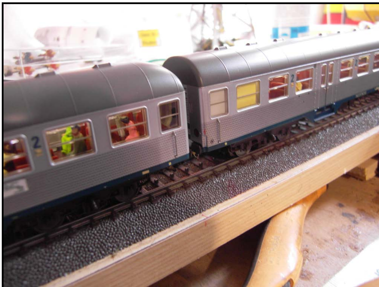
Foto n. 2: una tendina, ricavata dai biadesivi Märklin, forniti nella confezione delle piastre led d'illuminazione 73400 o 73401, nasconde anche il capocorda, visibile invece nella carrozza di sinistra, ingrandendo molto la foto.
