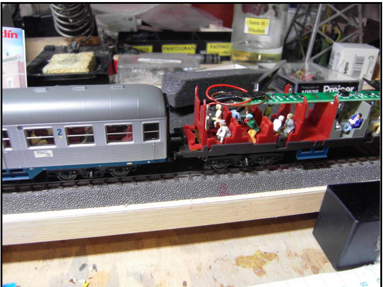
Foto n. 4: bloccaggio dei cavi in una carrozza Silberling, durante le prove luce
