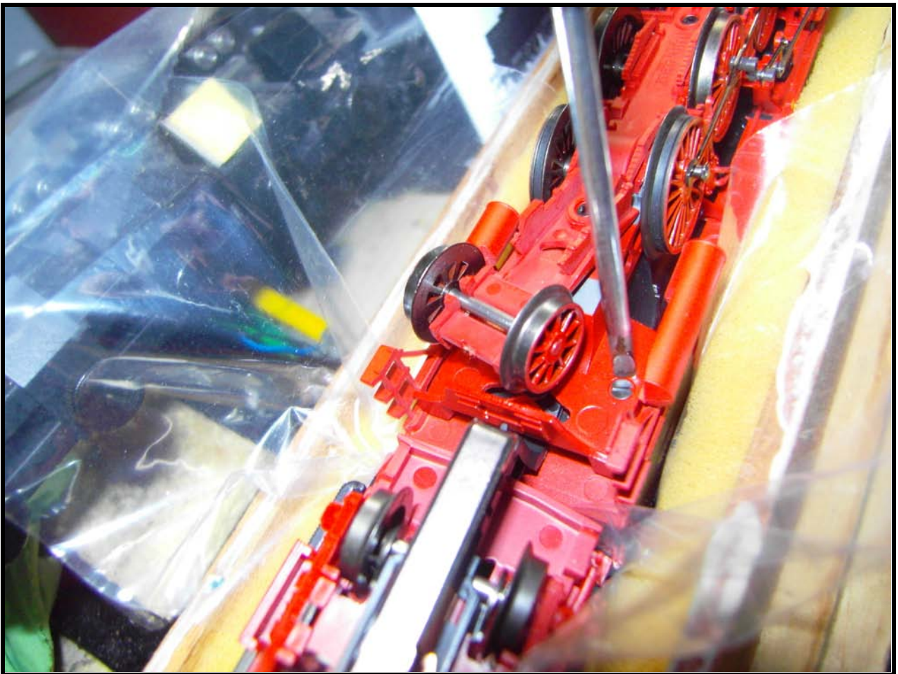
Foto n. 20: le due viti più corte sotto la cabina di guida della Br 39
