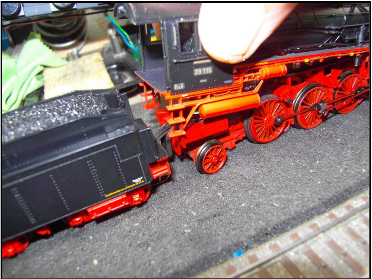
Foto n. 22: si deve alzare dal lato cabina per smontare il mantello delle Br 39 (notate il serbatoio e il segno dello stampo)
