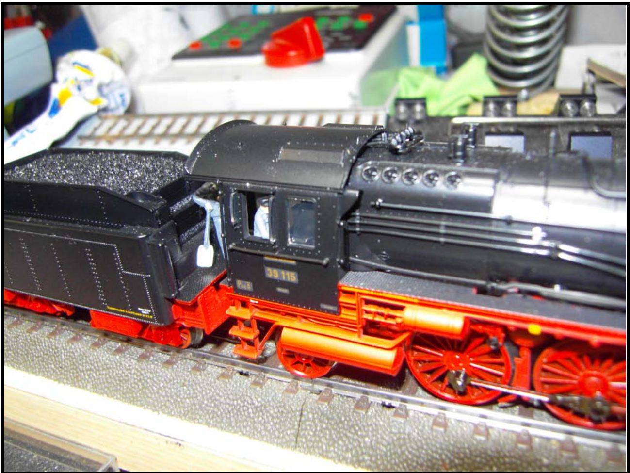
Foto n. 3: l'asta (in plastica) dell'inversione della Br 39 115 raddrizzata
