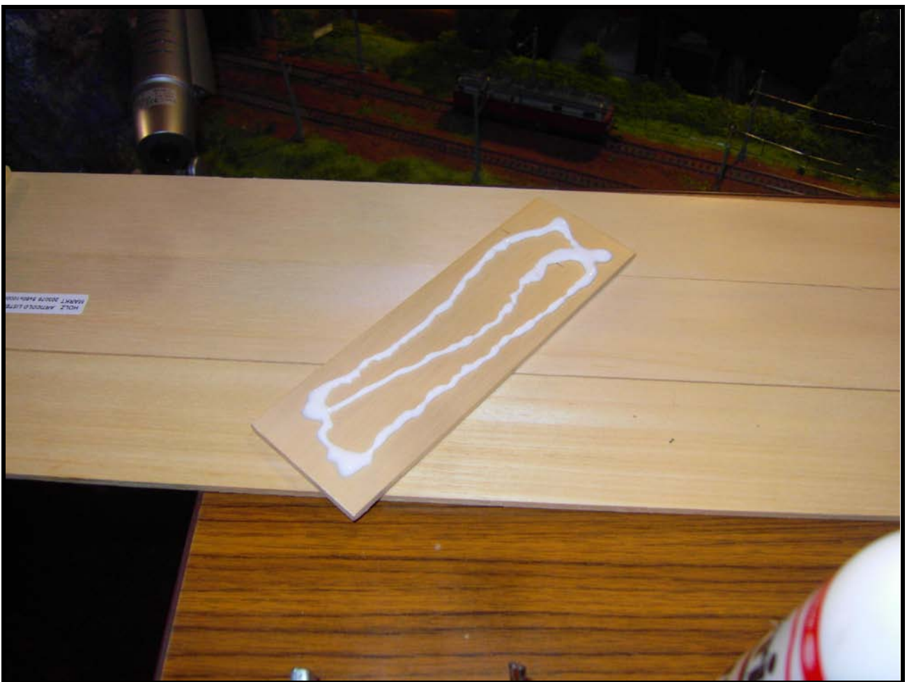
Foto n. 9: si incollano le traverse al basamento più lungo.
