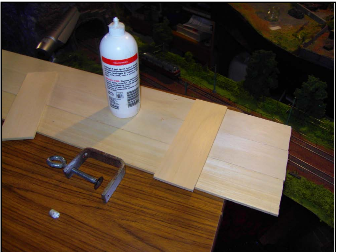
Foto n. 10: si incollano le traverse con colla vinilica.
