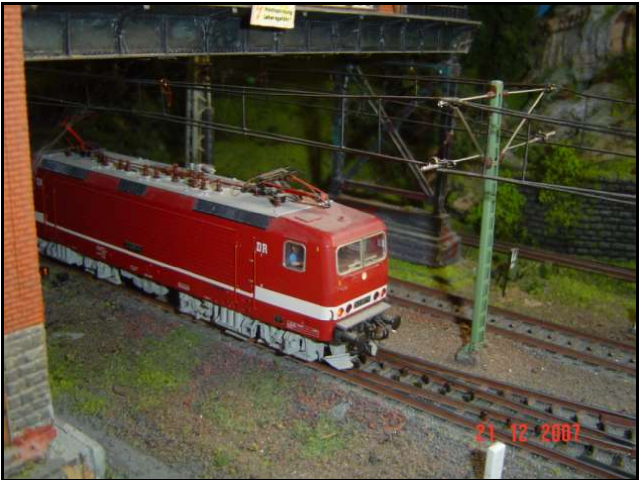
Foto n. 7: una 243 della DR già provvista di piccoli vomeri spazzaneve.
