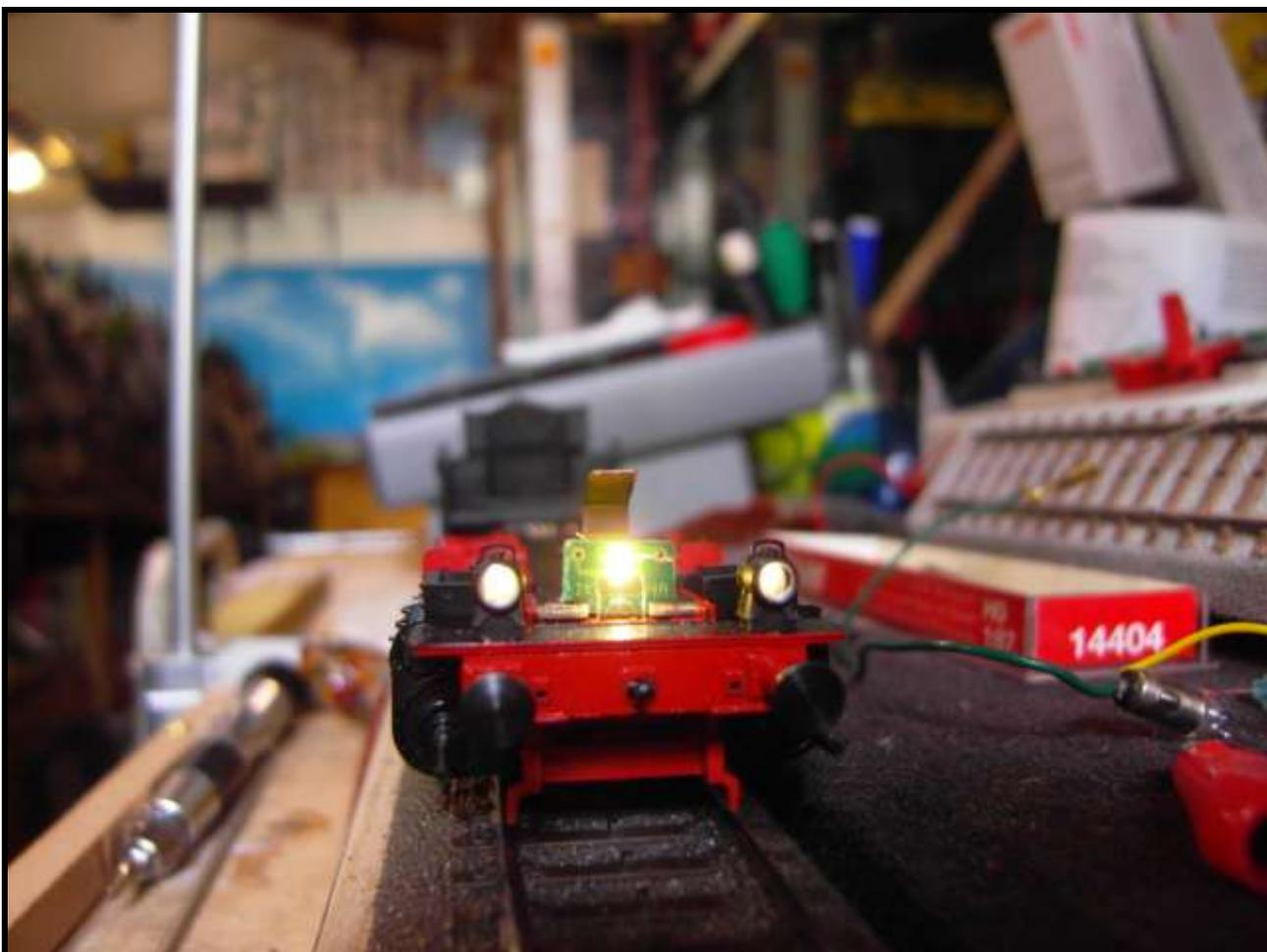
Foto n. 11: vista di fronte dei nuovi led che hanno sostituito le vecchie lampadine.
