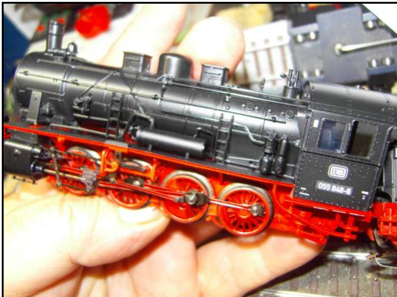
**Foto n. 7: sull'asse di sinistra una pompa è uscita dalla sede e ci sono da verificare altri particolari**
