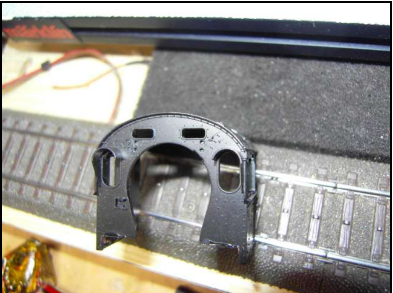
Foto n. 5: cabina guida d'una Br 55, i lunghi tiranti vanno infilati nei fori.
