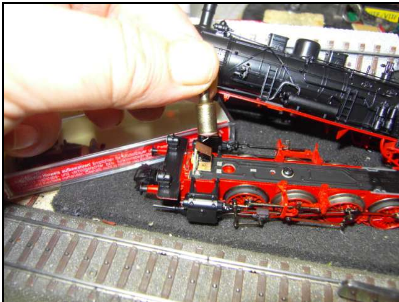
Foto n. 17: corretta piegatura del contatto centrale del dispositivo fumo 72270.
