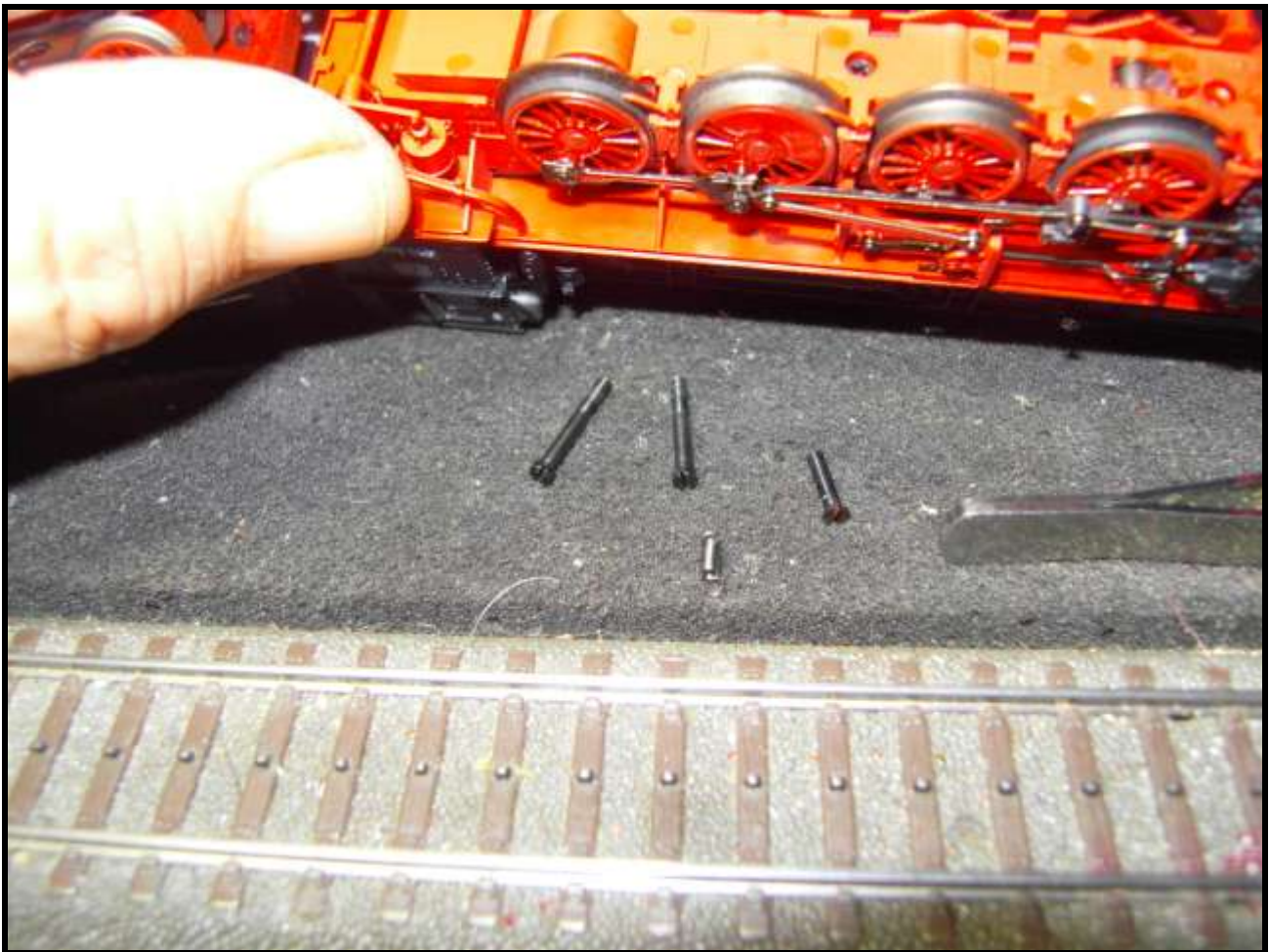
Foto n. 14: ecco la terza vite anteriore (corta) accanto alle altre e alla molletta di richiamo del gancio corto anteriore.
