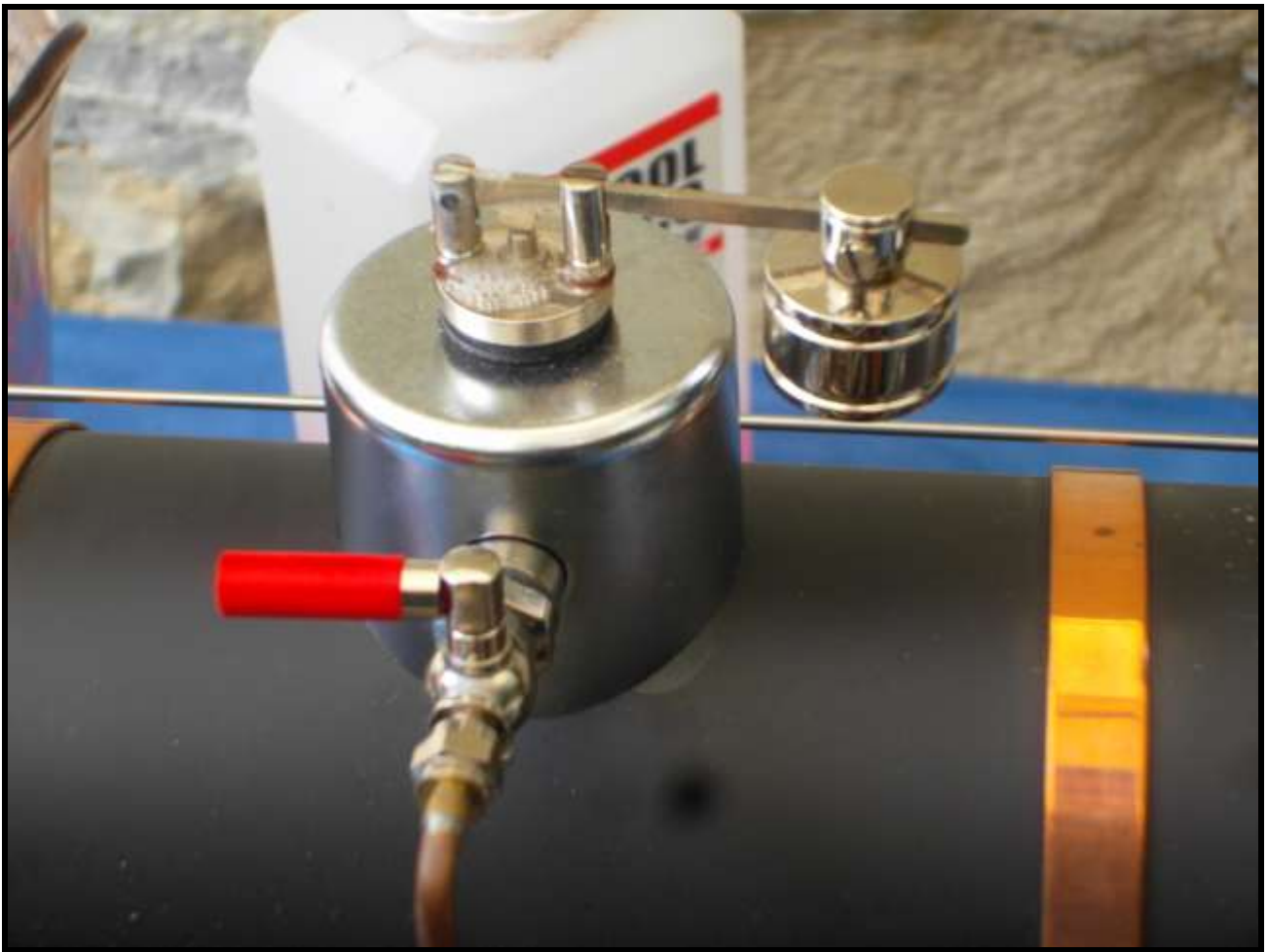
Foto n. 22: aumenta la pressione visibilmente nella valvola di sicurezza, notate che il rubinetto del vapore è ancora chiuso (quello con la manopola rossa)
