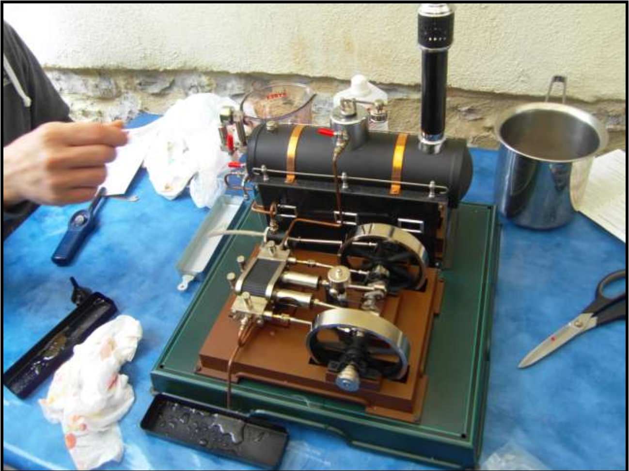
Foto n. 25: notate che il rubinetto del vapore al centro della caldaia è in posizione chiusa
