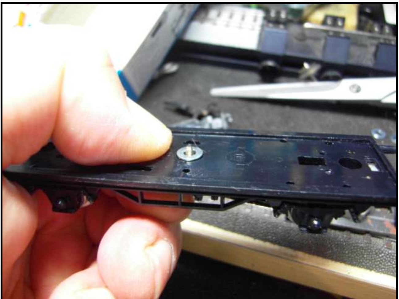
Foto n. 23: si colloca la rondella, utile per il blocco del pattino
