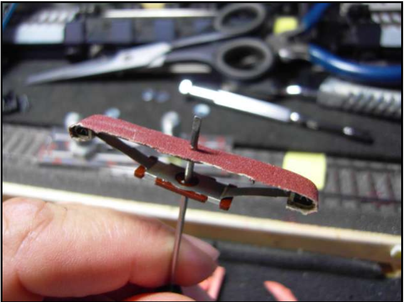
Foto n. 15: con il cacciavite si pratica un foro per la vite nella carta abrasiva
