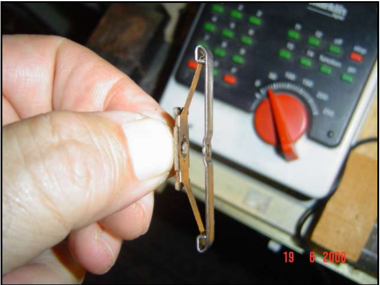
Foto n. 9: il vecchio pattino 7164 usurato, con la vite già infilata
