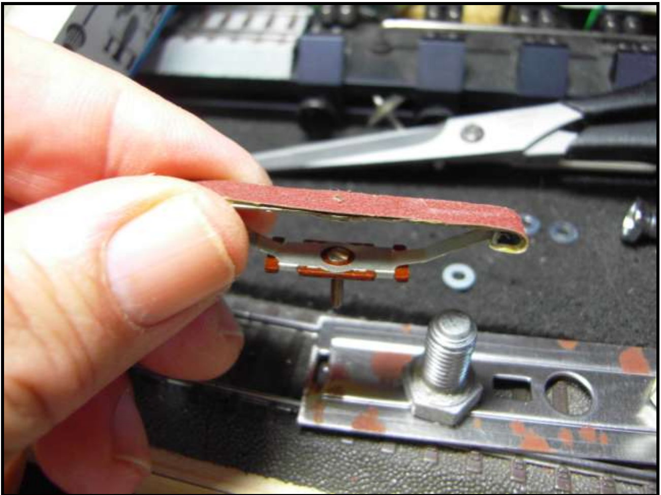
Foto n. 11: il vecchio 7164, con la carta abrasiva è pronto per essere installato
