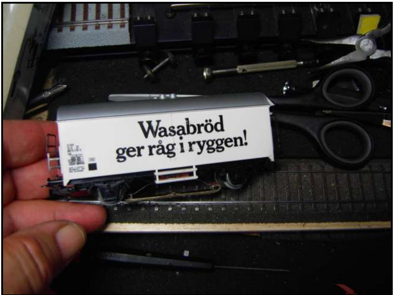
Foto n. 31: dopo le prove viene rimontato il mantello a pressione
