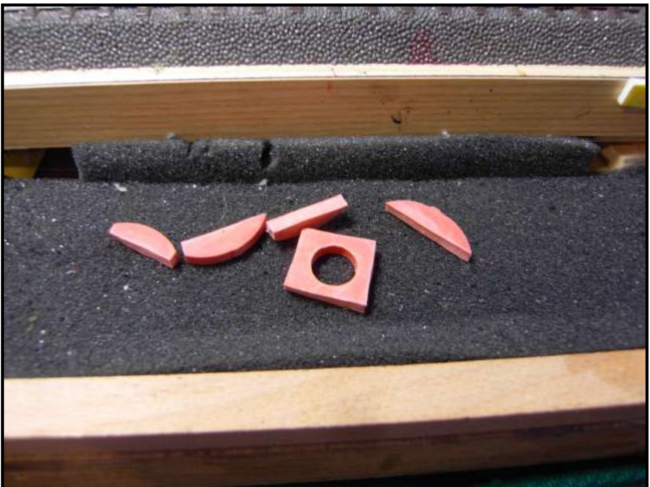
Foto n. 19: la rondella di gomma della foto n. 3 è stata tagliata
