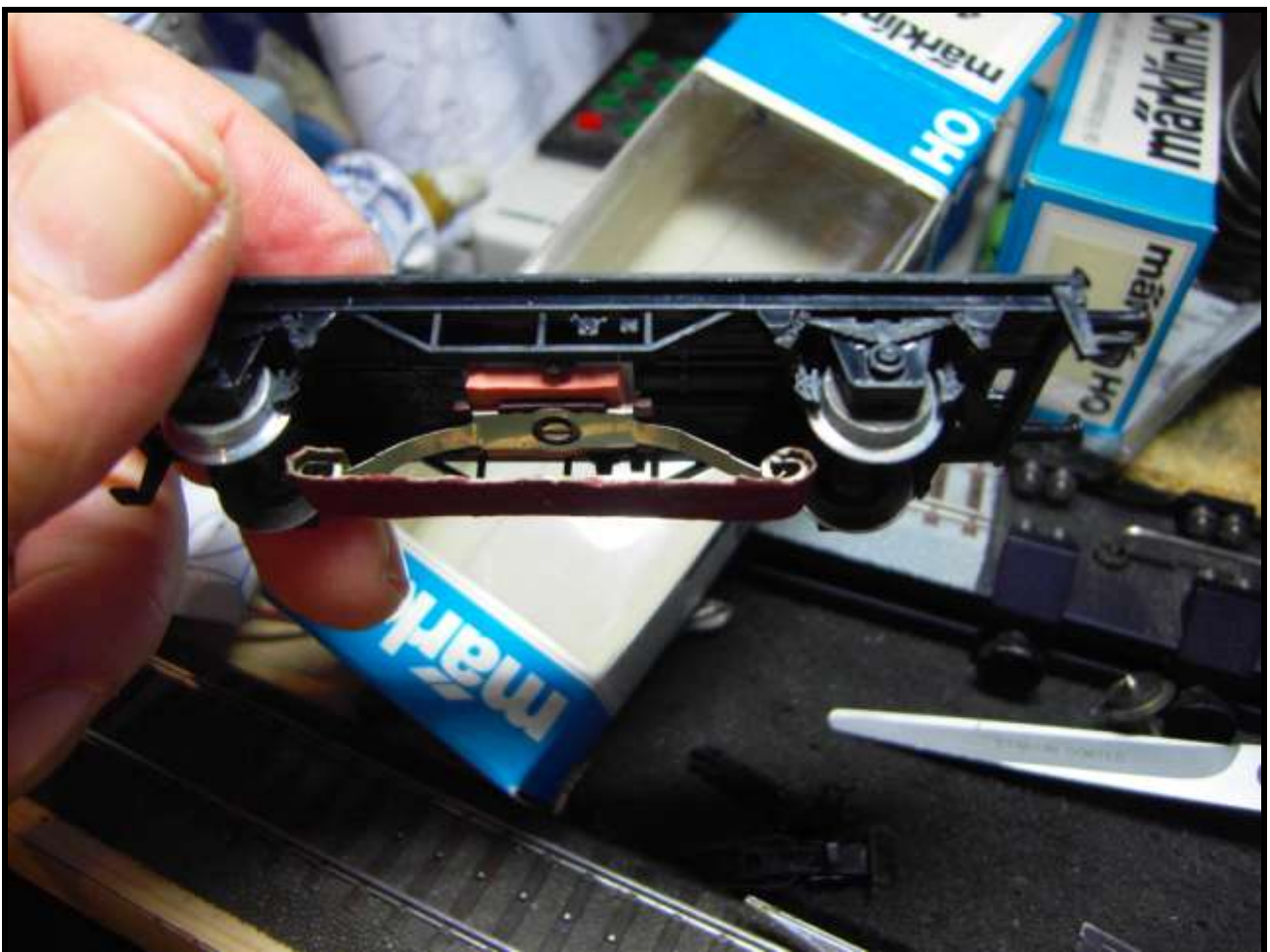
Foto n. 26: il pattino è installato
