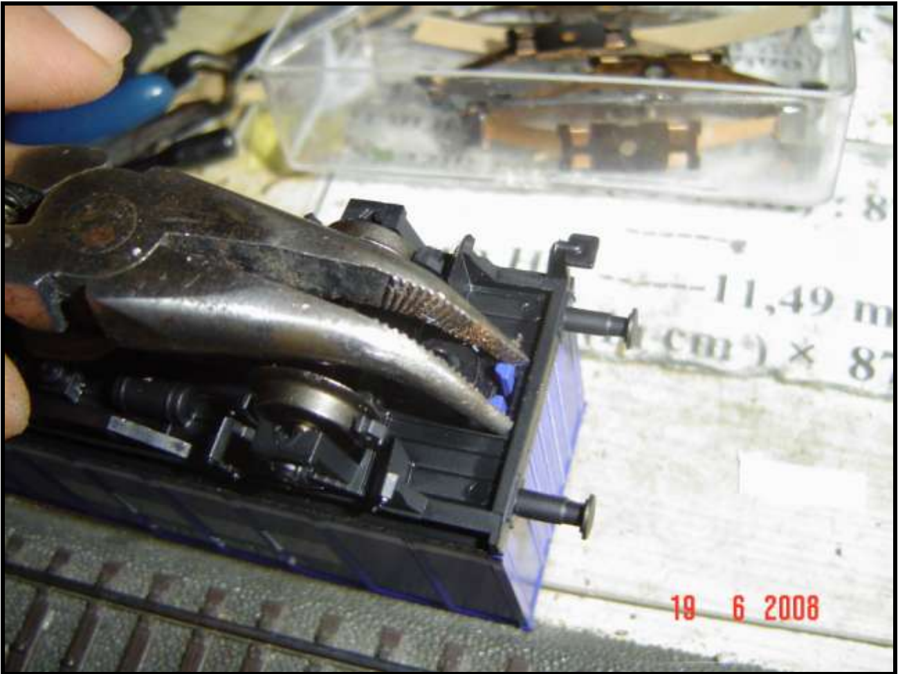
Foto n. 4: con un paio di pinze si stringono gli incastri e si allontana il mantello
