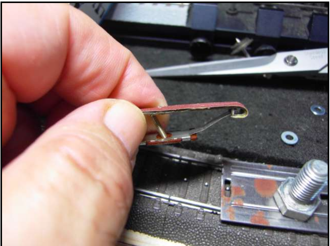
Foto n. 10: il vecchio 7164, con la carta abrasiva è più difficile far passare la vite
