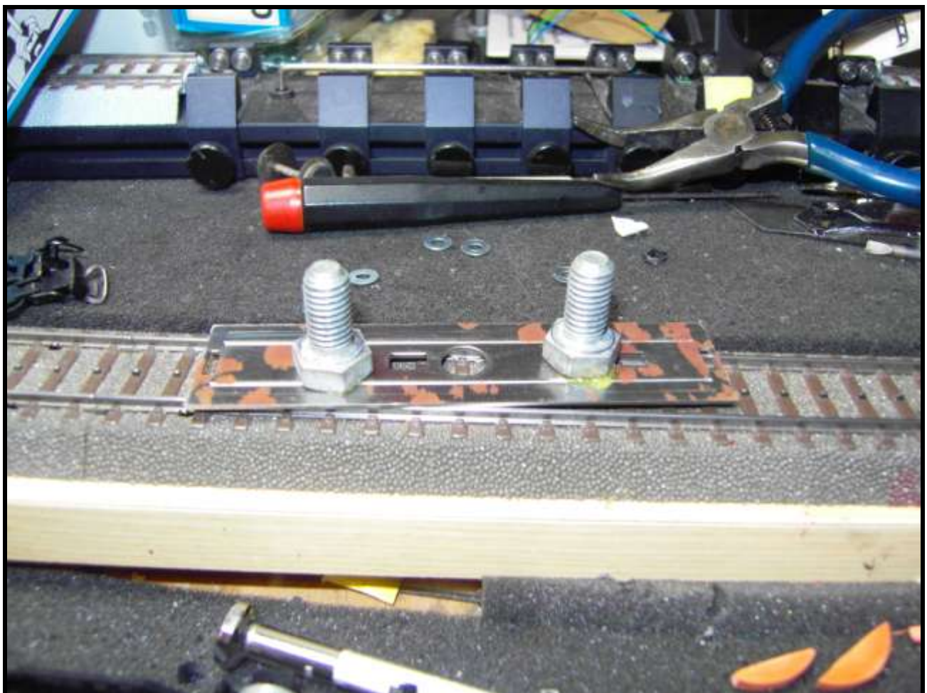
Foto n. 6: i pesi realizzati con grosse viti, incollate sul piano del carro
