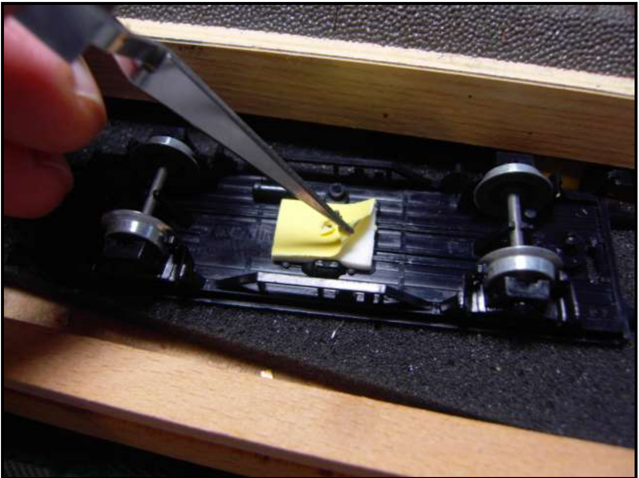
Foto n. 20: si allontana la protezione del biadesivo già forato
