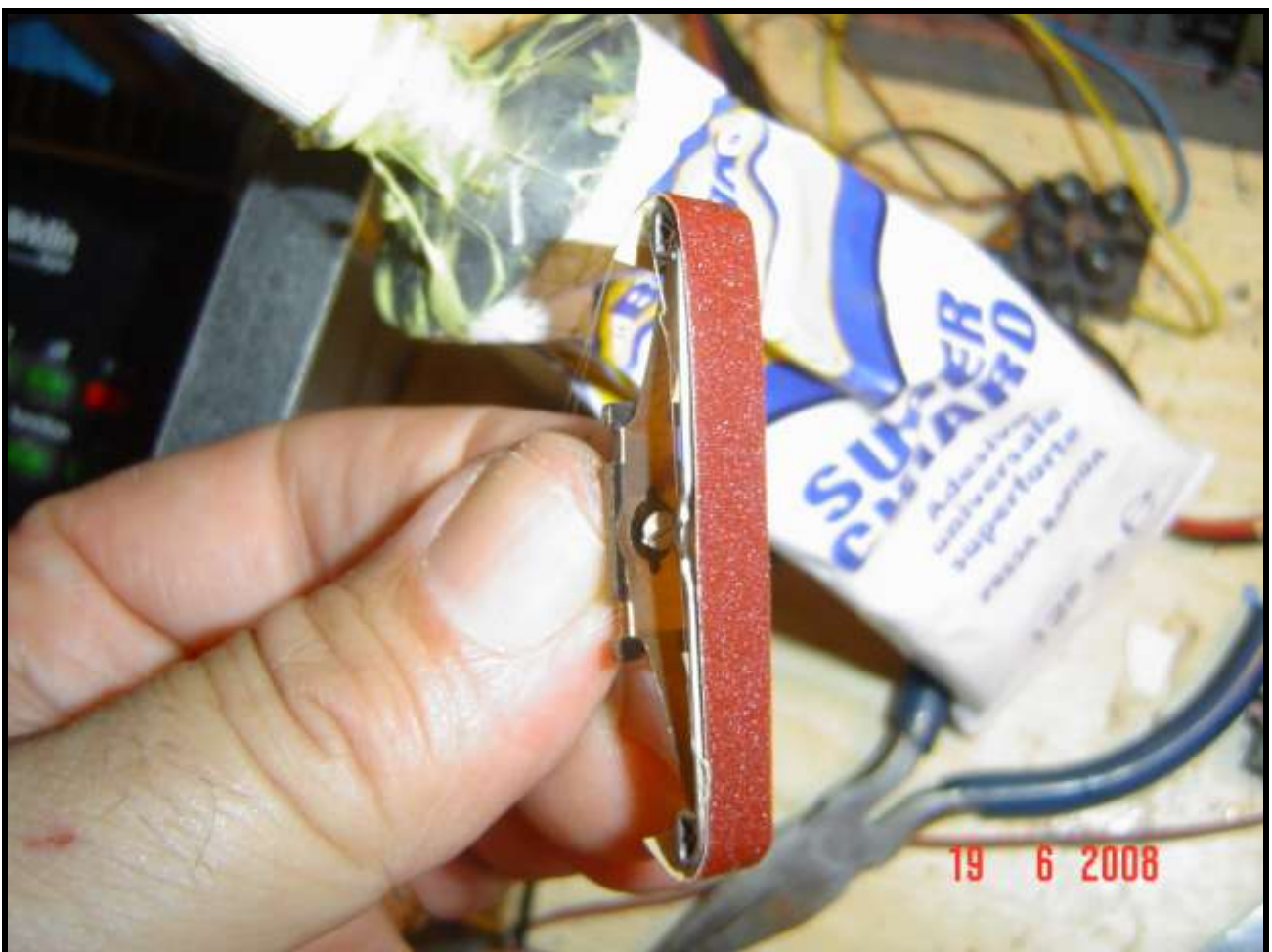
Foto n. 13: sul vecchio 7164 si incolla la striscia di carta abrasiva
