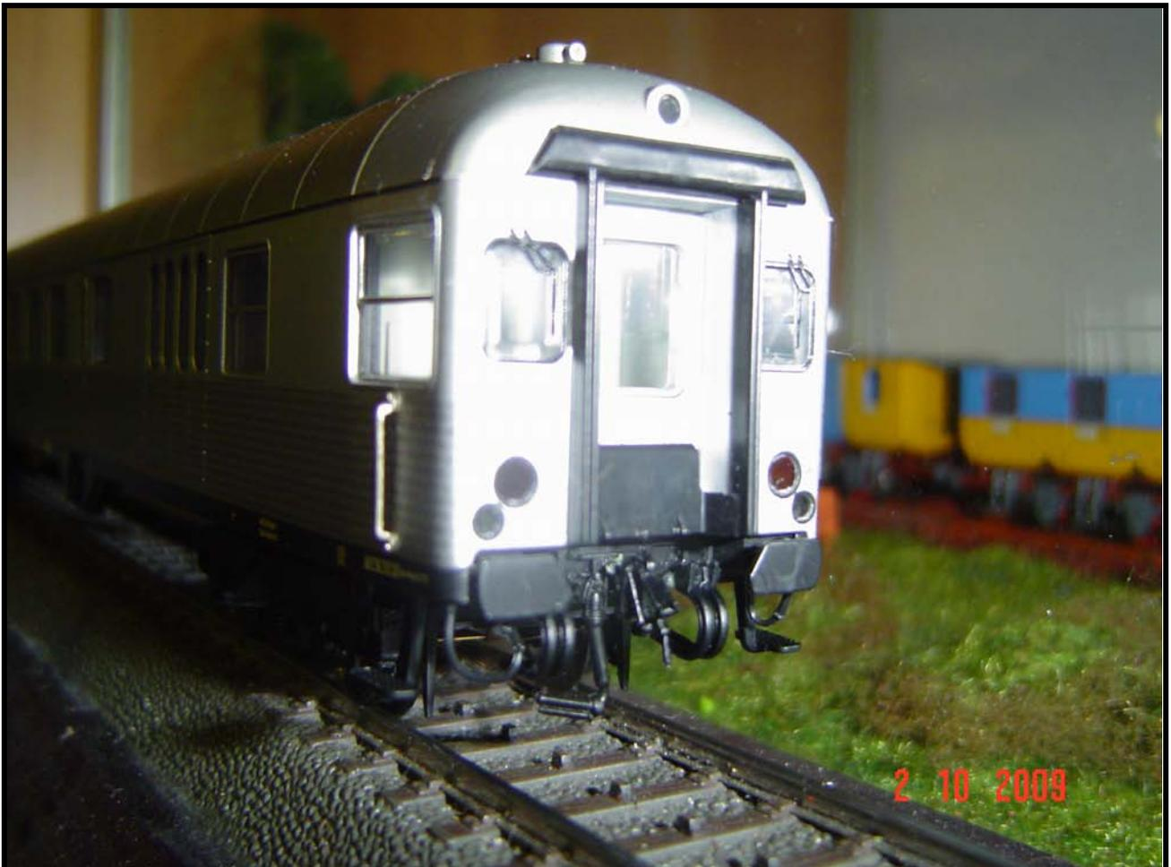
**Foto n. 20: le carrozze pilota Silberling, nei primi anni, avevano la angusta testata Hasenkasten (gabbia di lepre)**
