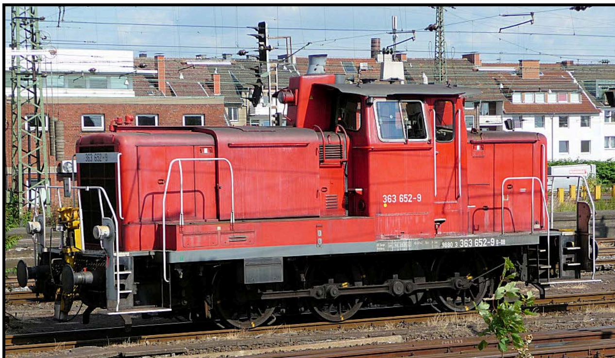
Foto n. 6: una 363 652-9 con gancio automatico (in giallo).
