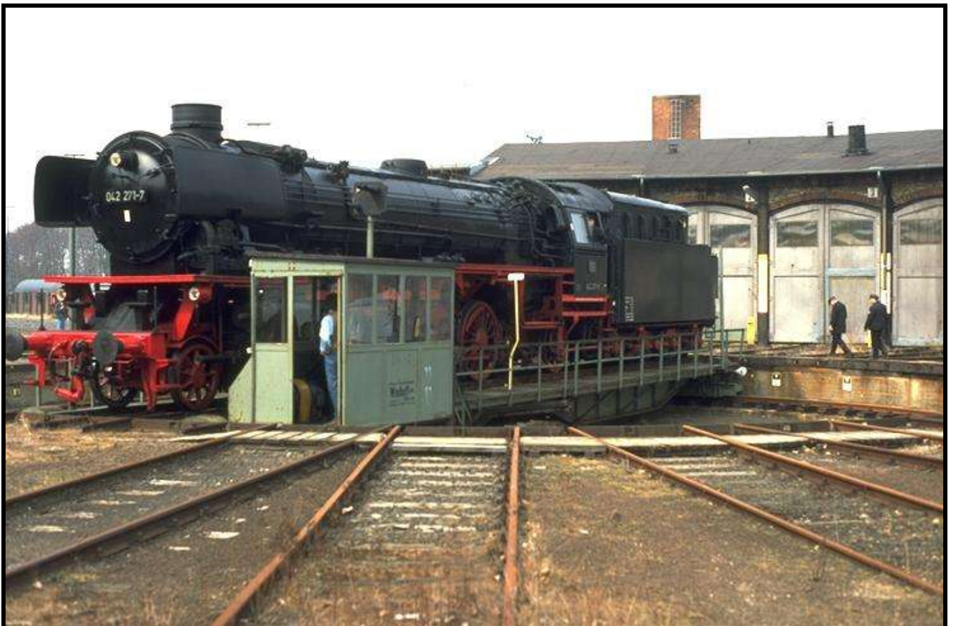
Foto n. 7: lato sinistro, turbodinamo e tubature della Br 042 271-7
