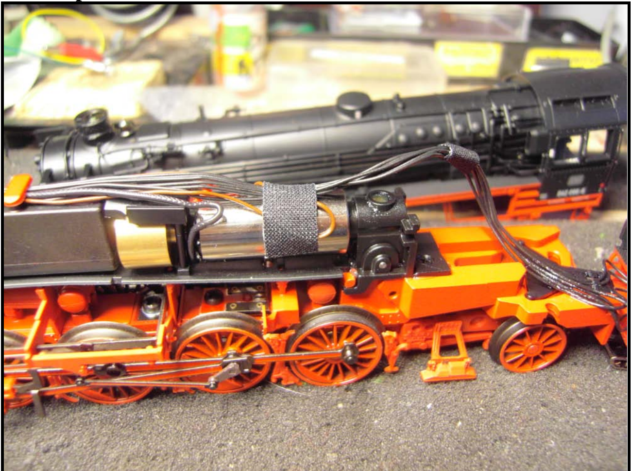
Foto n. 12: le sole 2 ruote dotate di cerchiature nella Br 042
