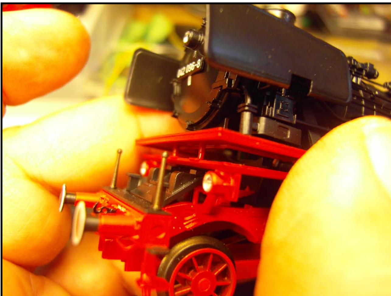
Foto n. 6: incastri con la basetta led da rispettare nel rimontaggio!
