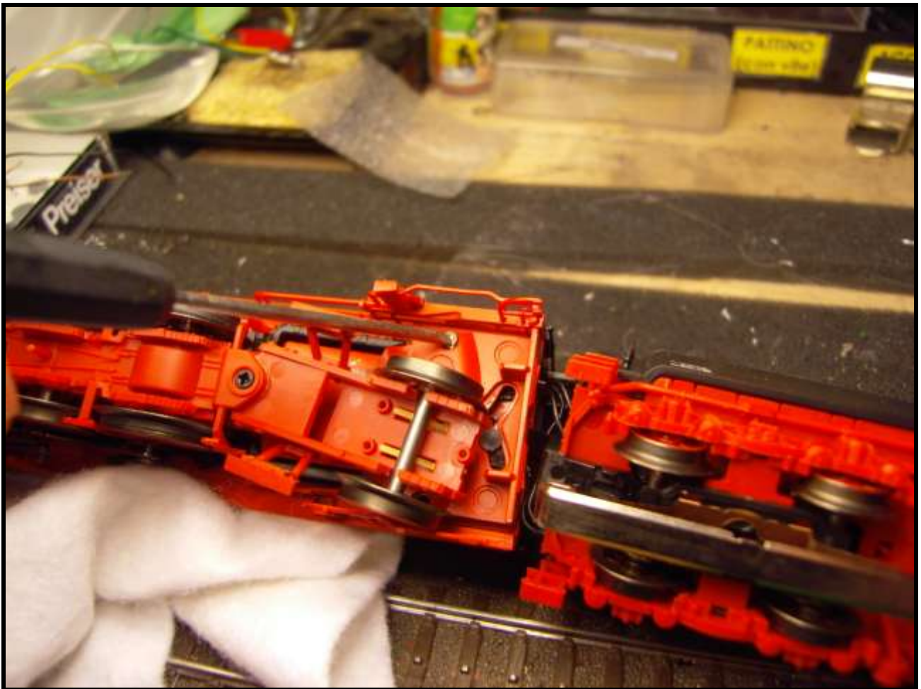
Foto n. 23: una seconda vite sotto la cabina della Br 042 096-8
