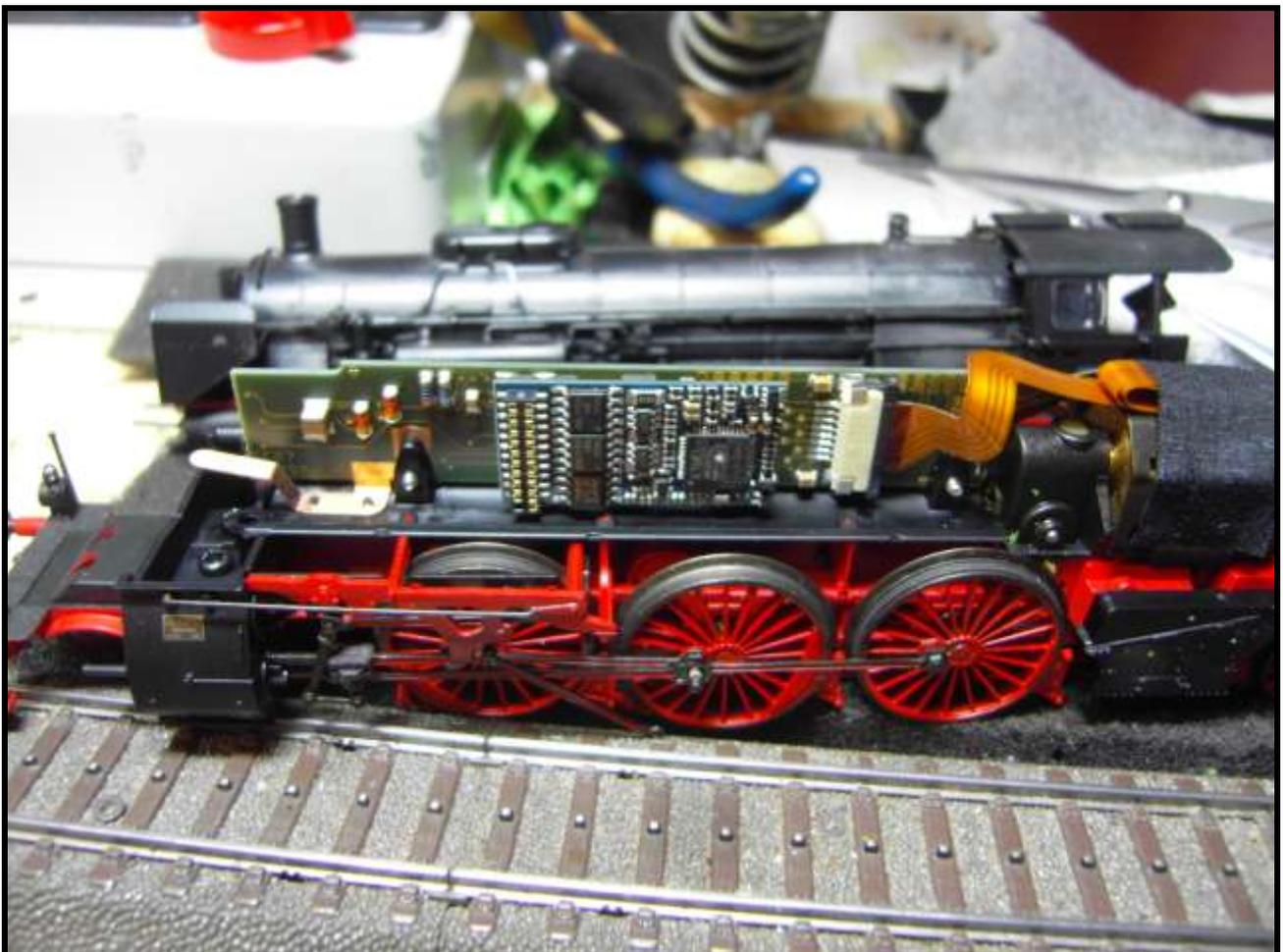
Foto n. 22: la Br 18 ha il motore facilmente accessibile per l'ingrassaggio (a destra e sotto la piattina/dati).
