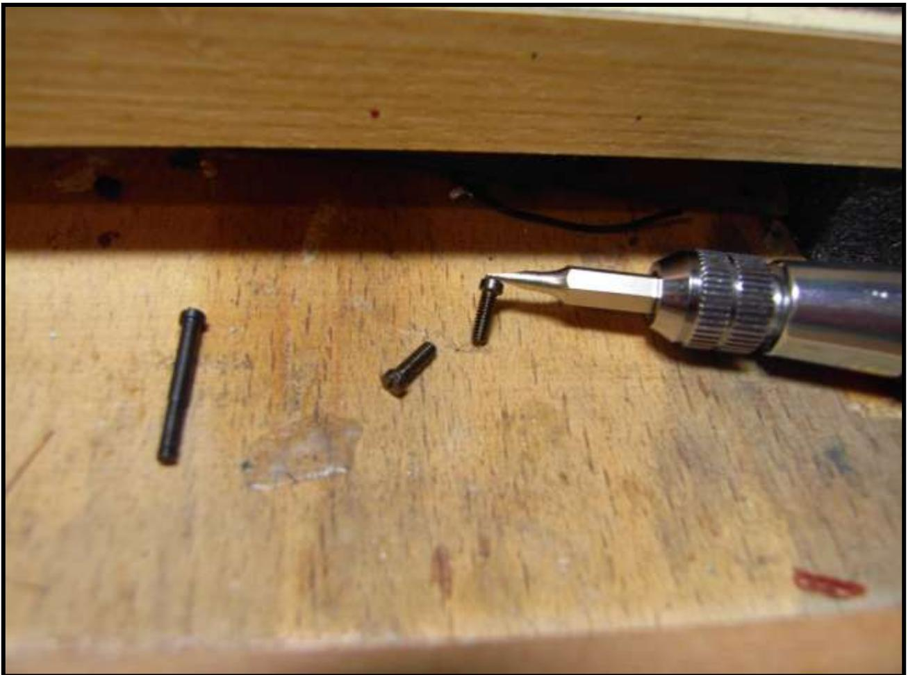
Foto n. 21: le tre viti allontanate per smontare il mantello 18 321.
