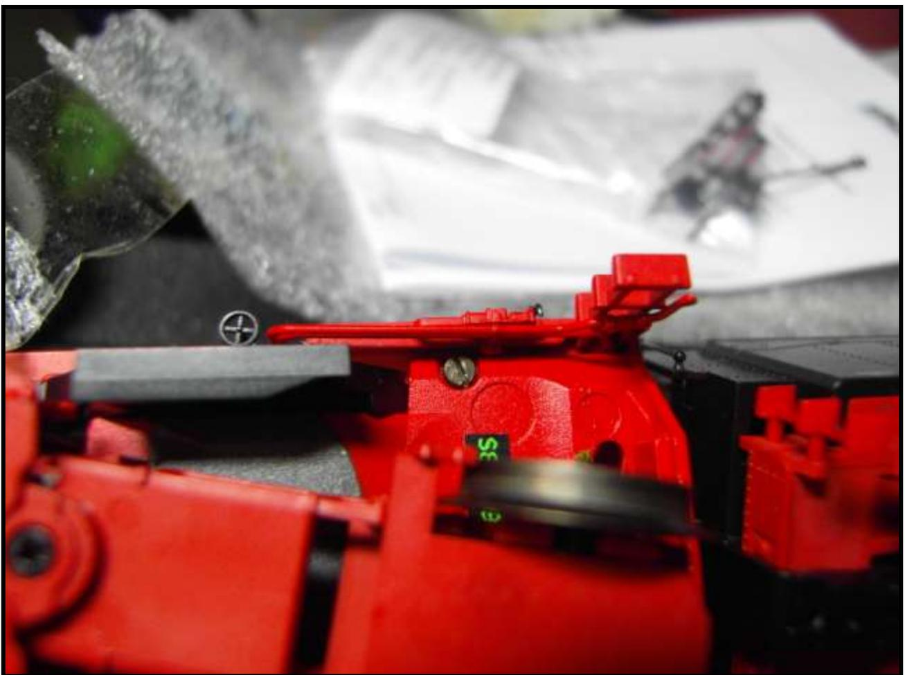
Foto n. 19: le due viti piccole nascoste sotto il carrello posteriore.
