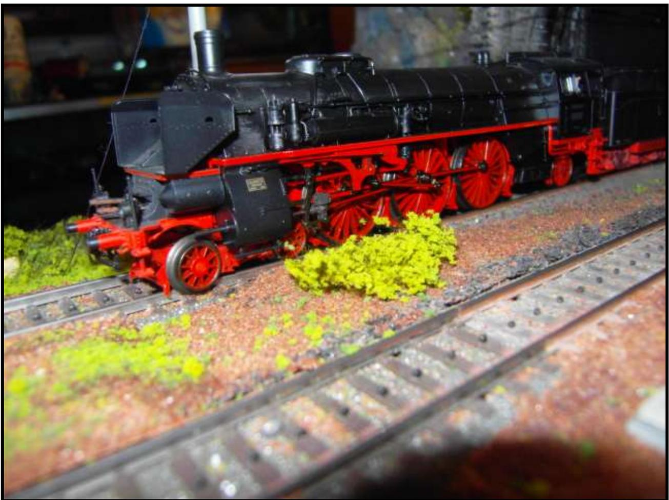
Foto n. 12: la 18 321 aggancia durante la corsa un ciuffo d'erba filamentosa che spezzerà parte del biellismo (ricostruzione).
