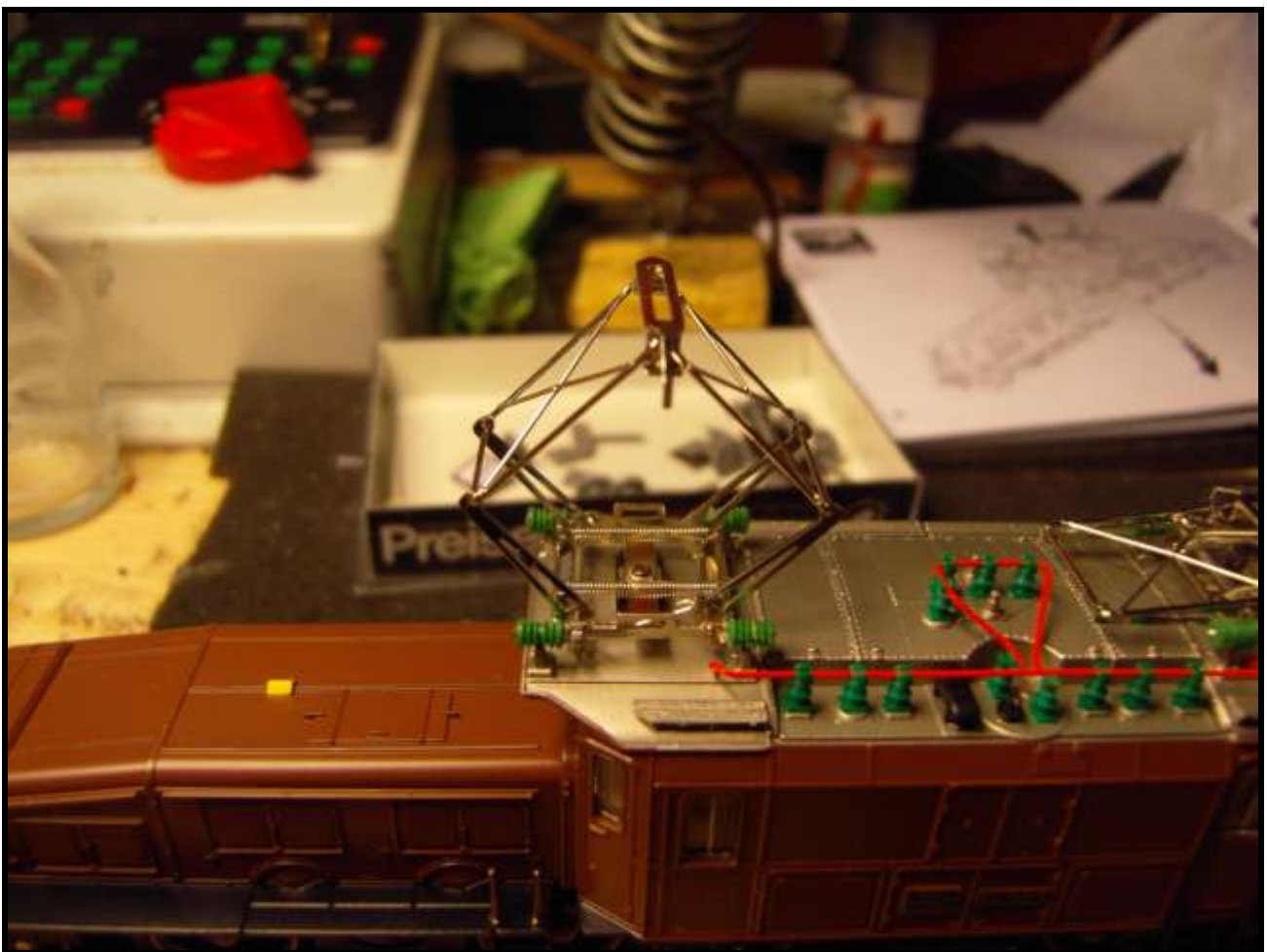
Foto n. 13: condotte elettriche dell'imperiale , ma corrimani stampati.
