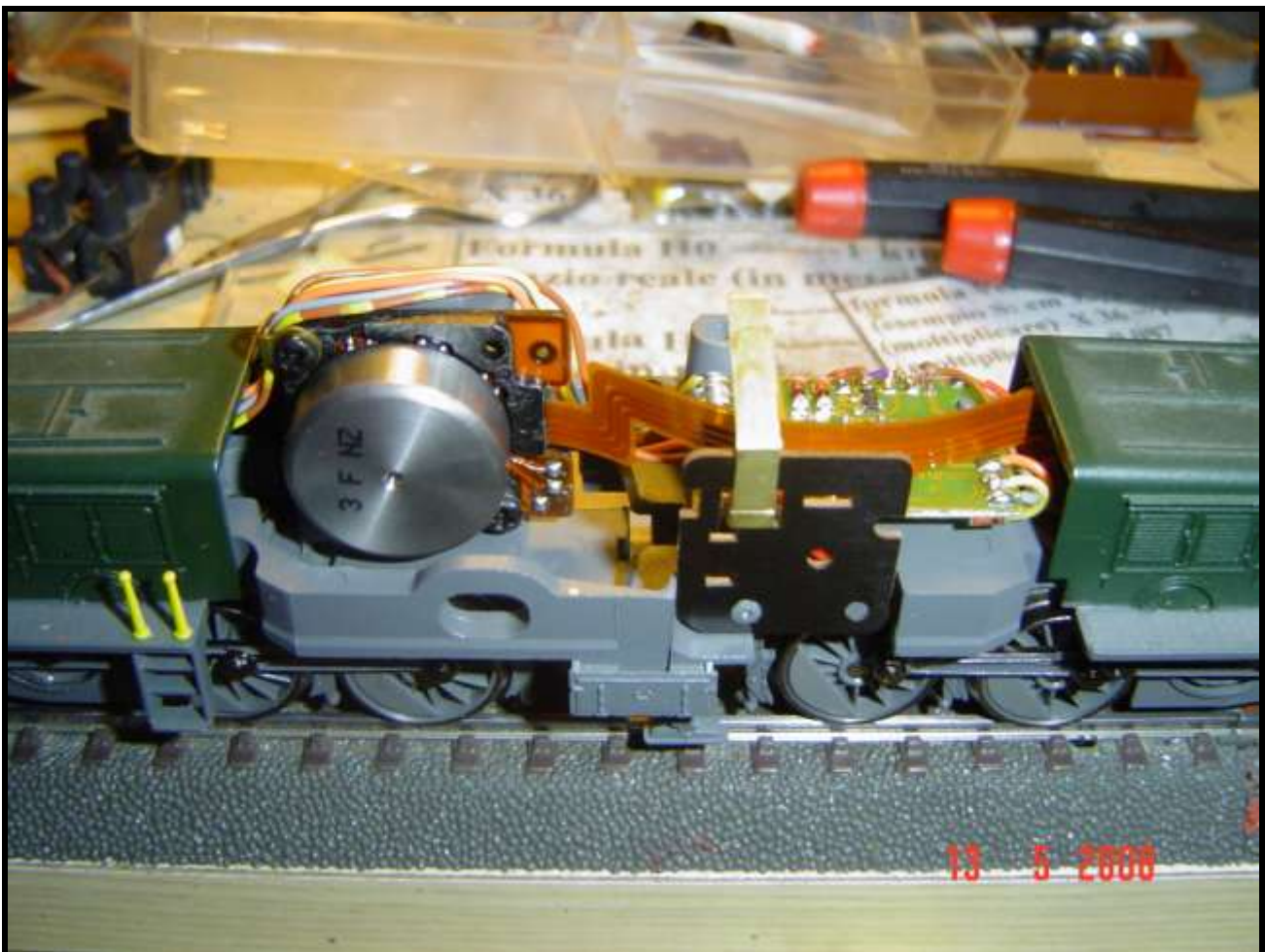
Foto n. 9: motore C-Sinus 1ª versione nel Ce 6/8 III 14310.
