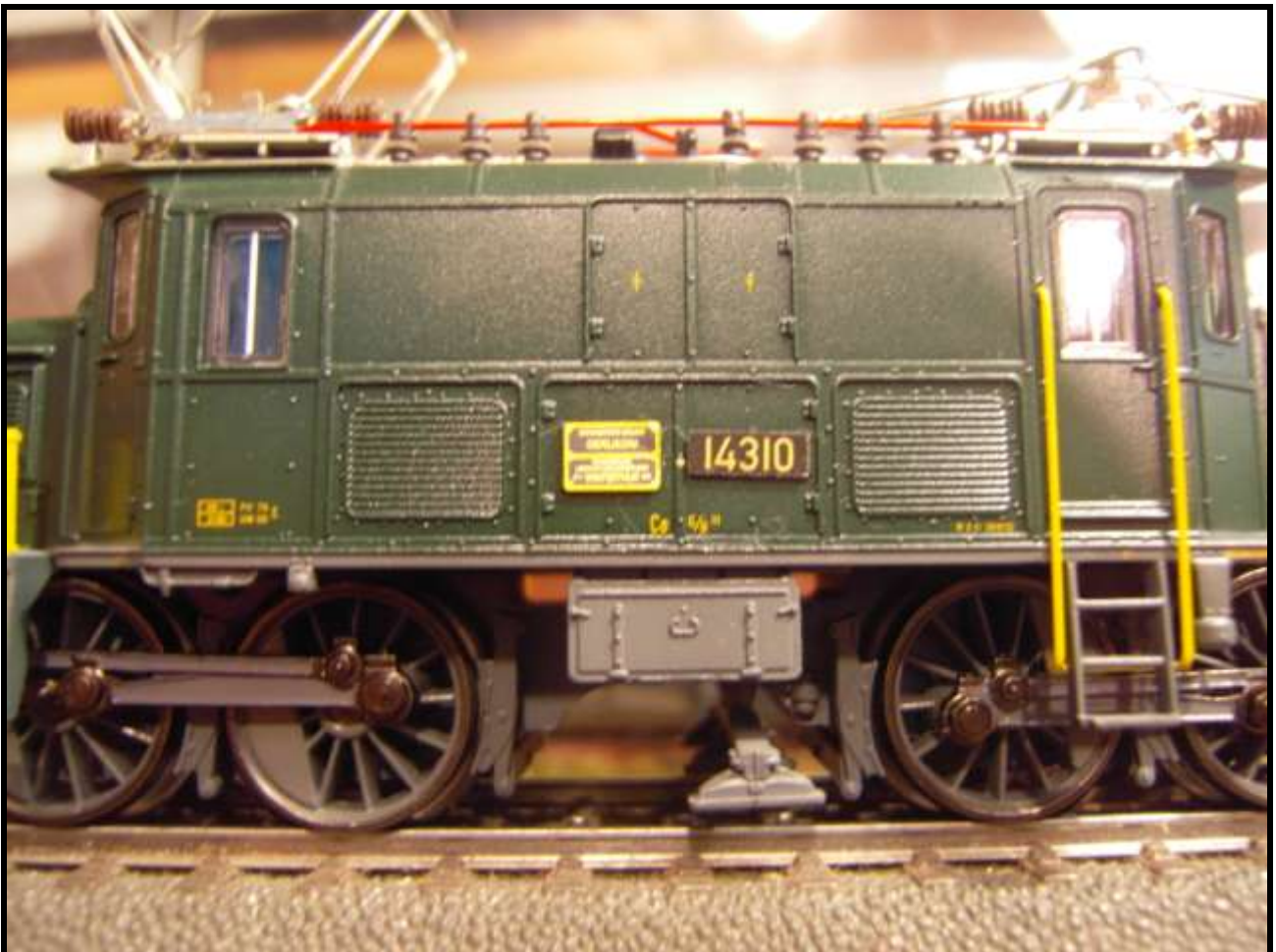
Foto n. 23: il Ce 6/8 III 14310 ha due scalette laterali (una per lato).
