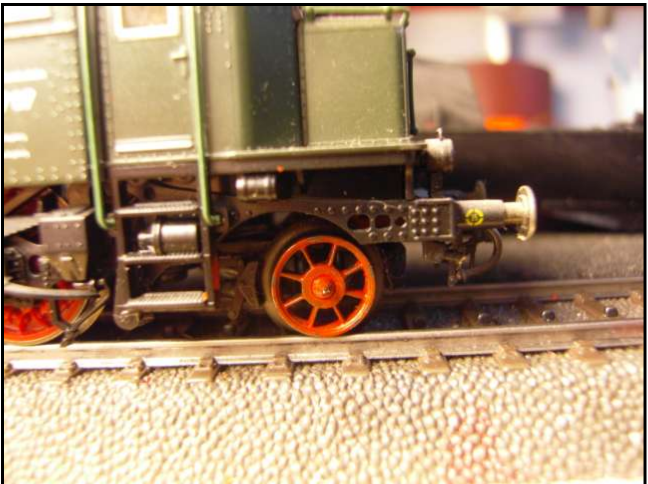
Foto n. 7: il carrello portante della E 17 07 Roco operativo; per mascherare l'adattamento erano praticati dei fori (3) più piccoli.
