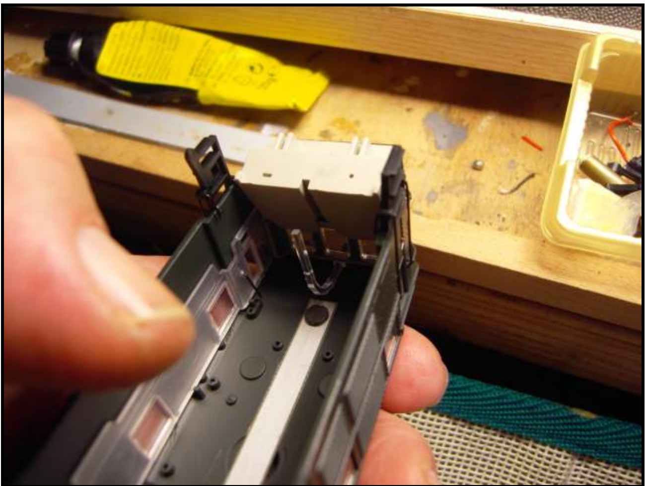
Foto n. 8: la E 17 111 ha la cabina incastrata tra il diffusore del terzo faro e d il mantello, per allontanarla ci vuole cautela.
