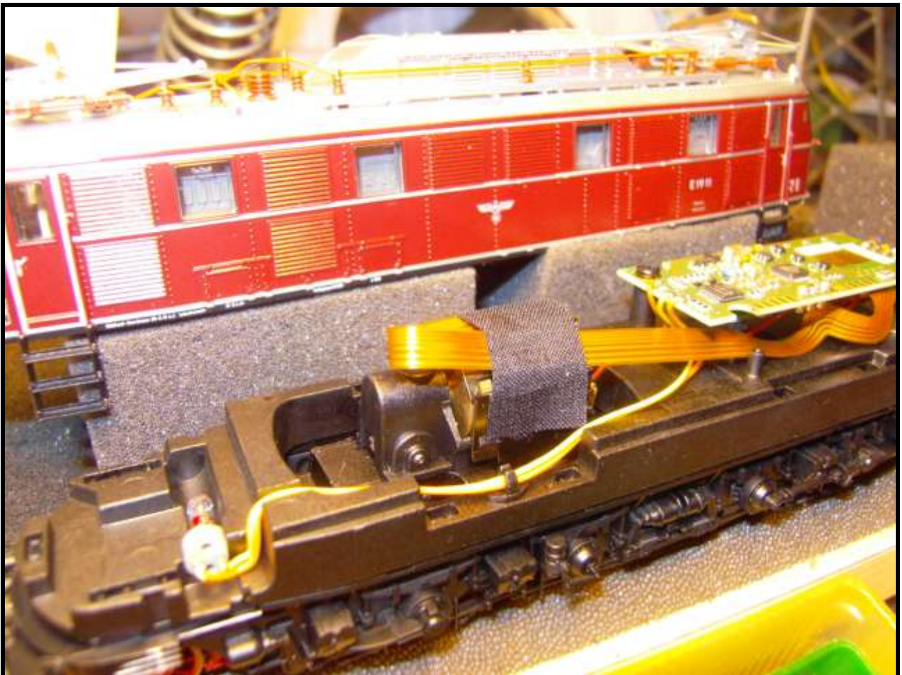
Foto n. 3: il potentissimo motore di una E 19 Märklin (Soft Drive Sinus).
