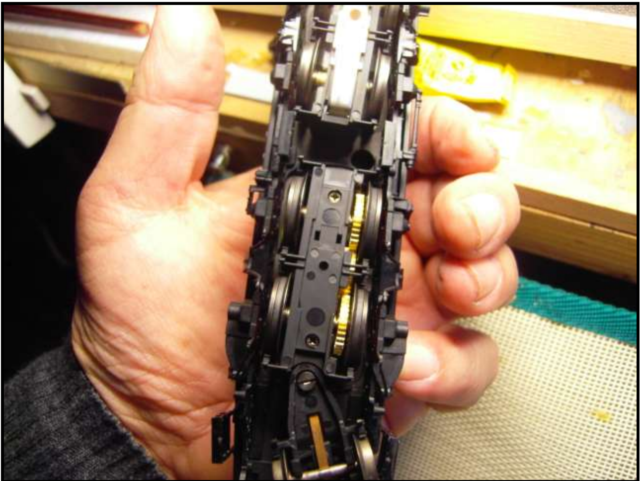
Foto n. 6: il carrello motore di una E 18 Märklin.
