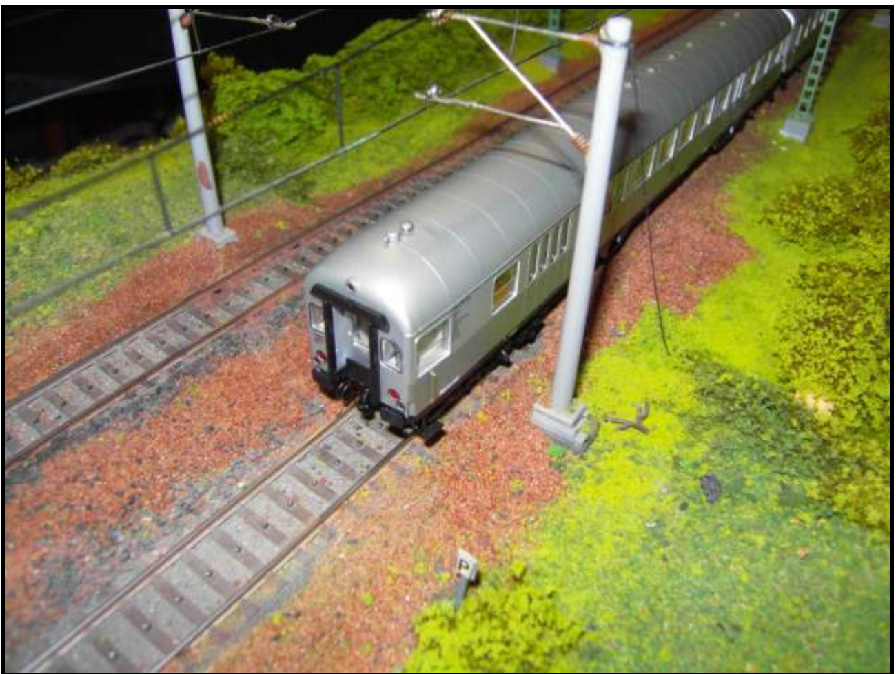
Foto n. 20: la carrozza pilota Silberling, con testata di vecchio tipo e cabina di guida angusta ribattezzata Hasenkasten .
