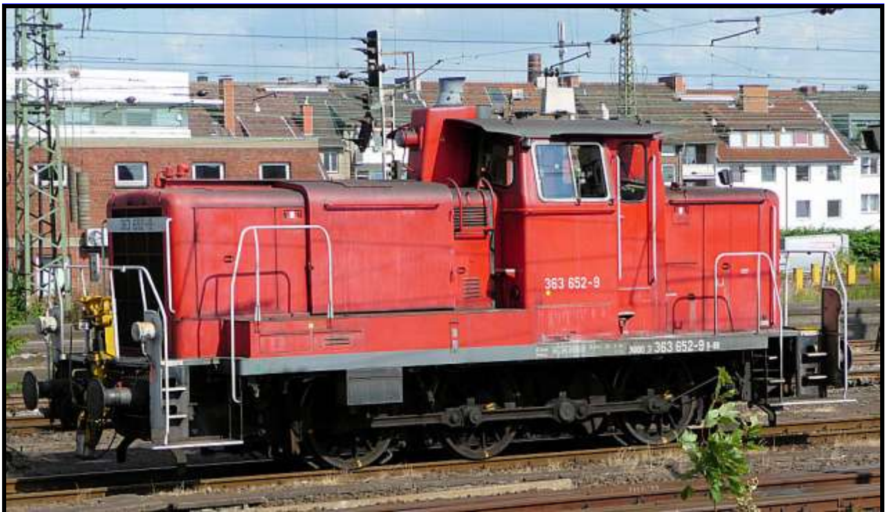
Foto n. 19: una 363 (derivata dal progetto V 60) con sigla dispari (361/63/65) perchè provvista del telecomando anche se fu applicato sulle 362 intorno al 2000.
