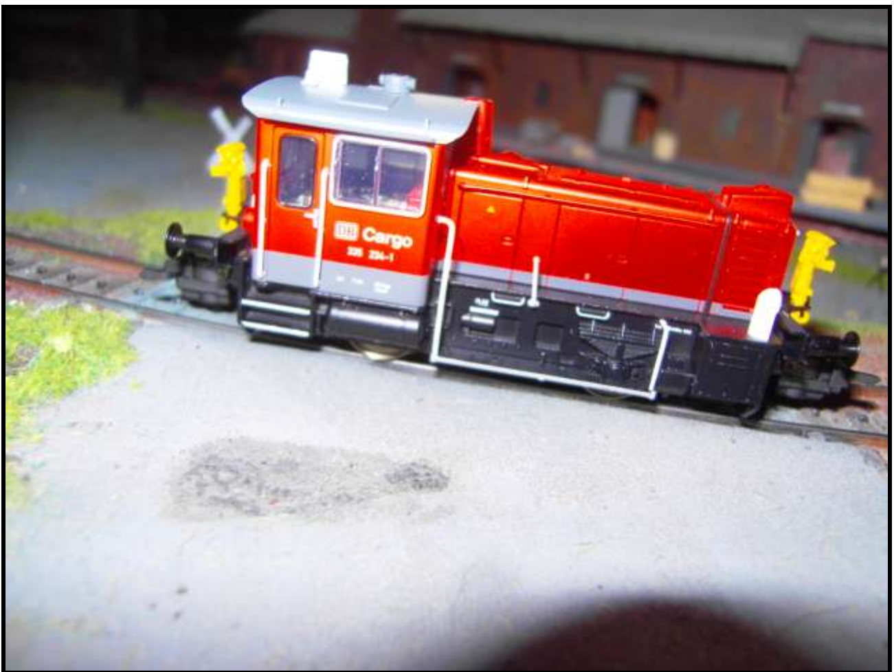
Foto n. 18: Köf III di epoca moderna, con aggancio e telecomando (antenna sul tetto)
