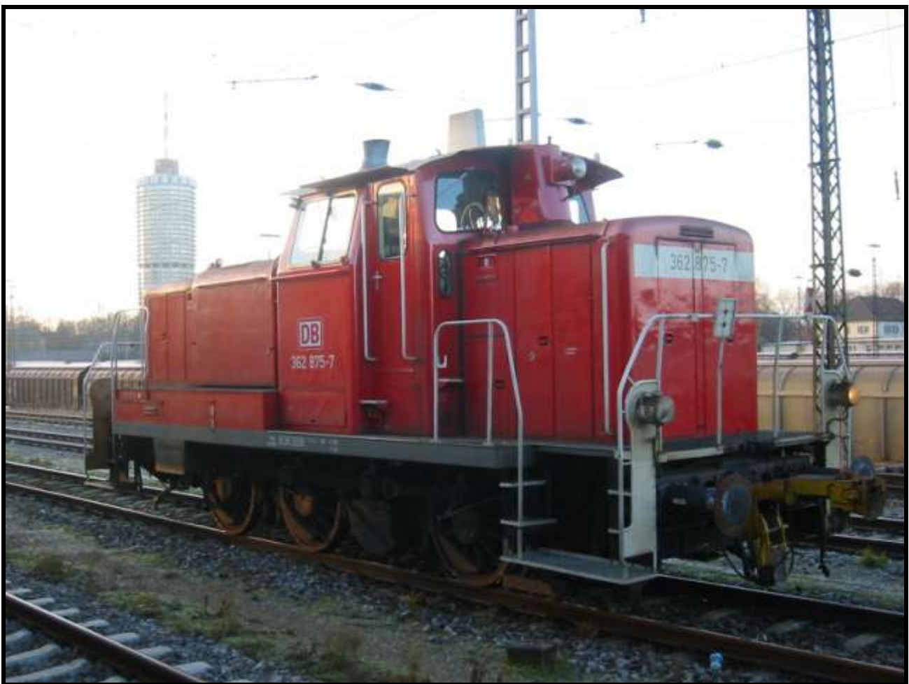
Foto n. 23: il gancio automatico, in una 362 fresca di riverniciatura, è già molto sporco per l'uso (foto Marco Palazzo, Augsburg 2003).
