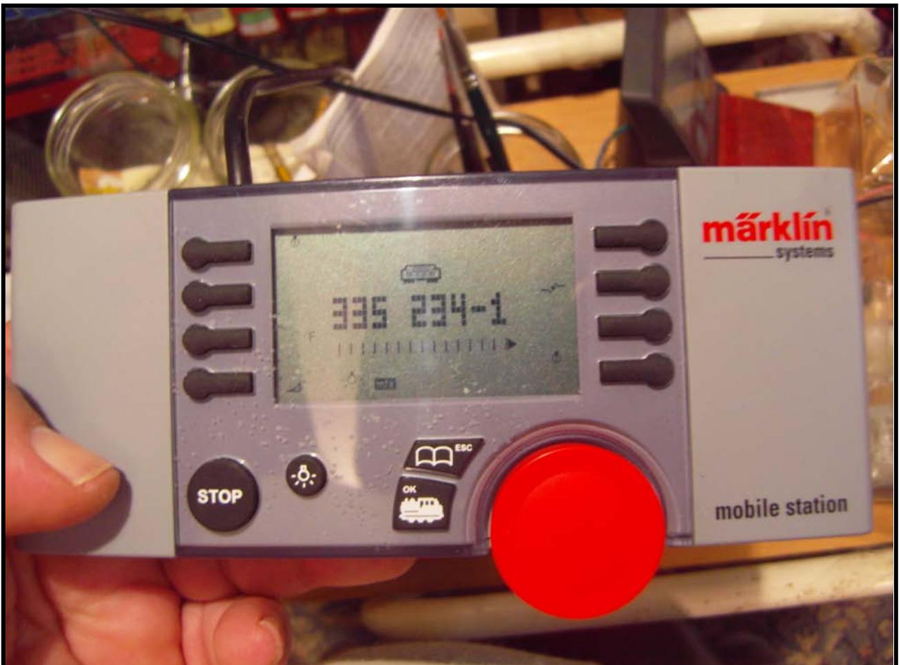
Foto n. 38: sulla destra, in alto, il comando per telex posteriore in MS1.
