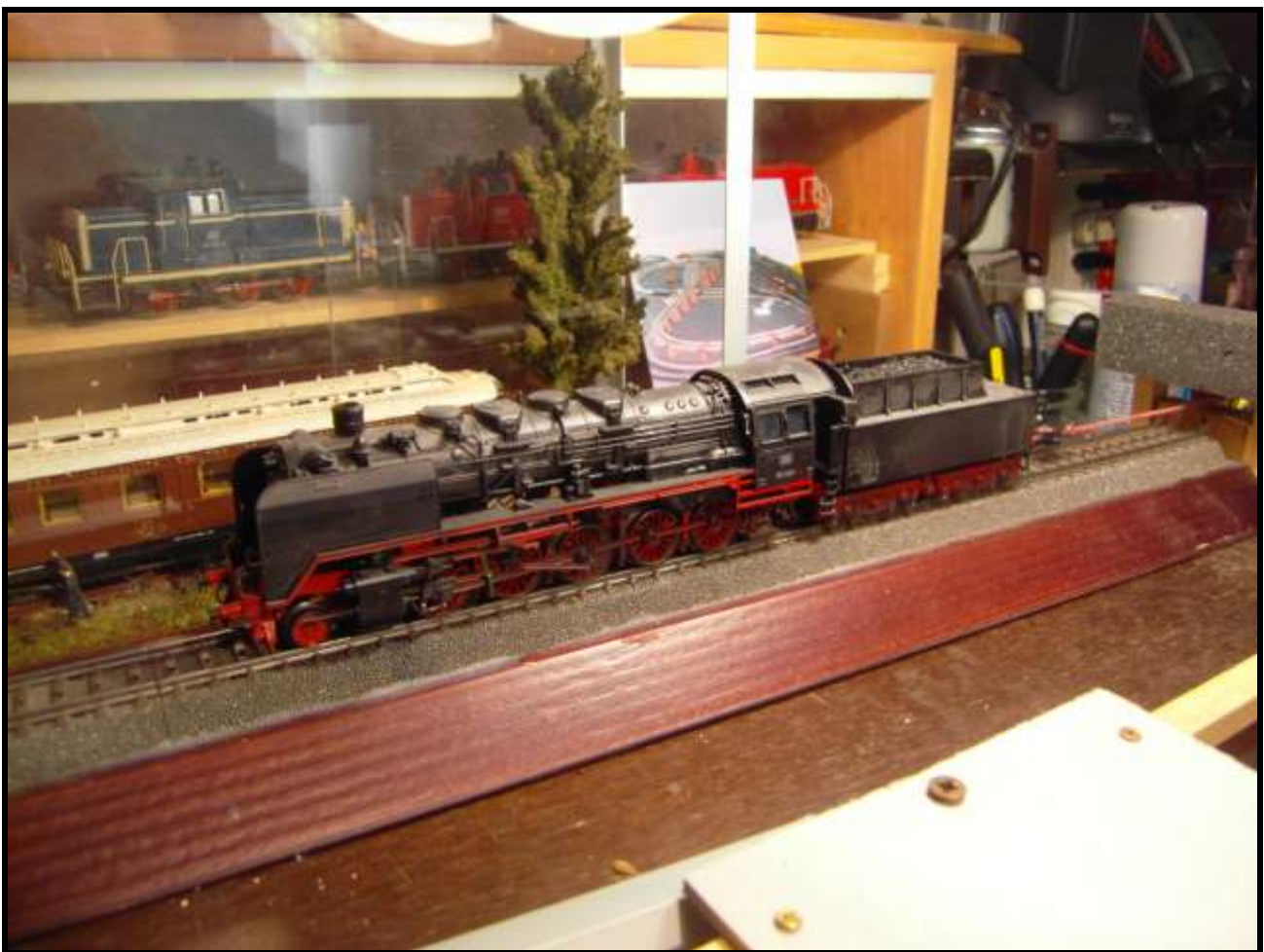
Foto n. 14: la Br 50 1301, sul banco dinamometrico.
