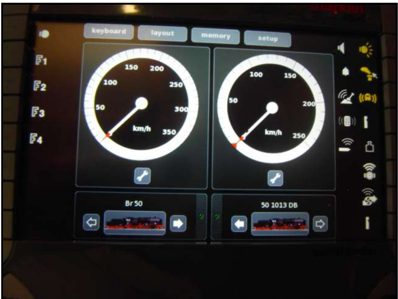
Foto n. 17: la Br 50 1013, recupera l'icona perduta e memorizzata prima di effettuare variazioni sulla macchina.
