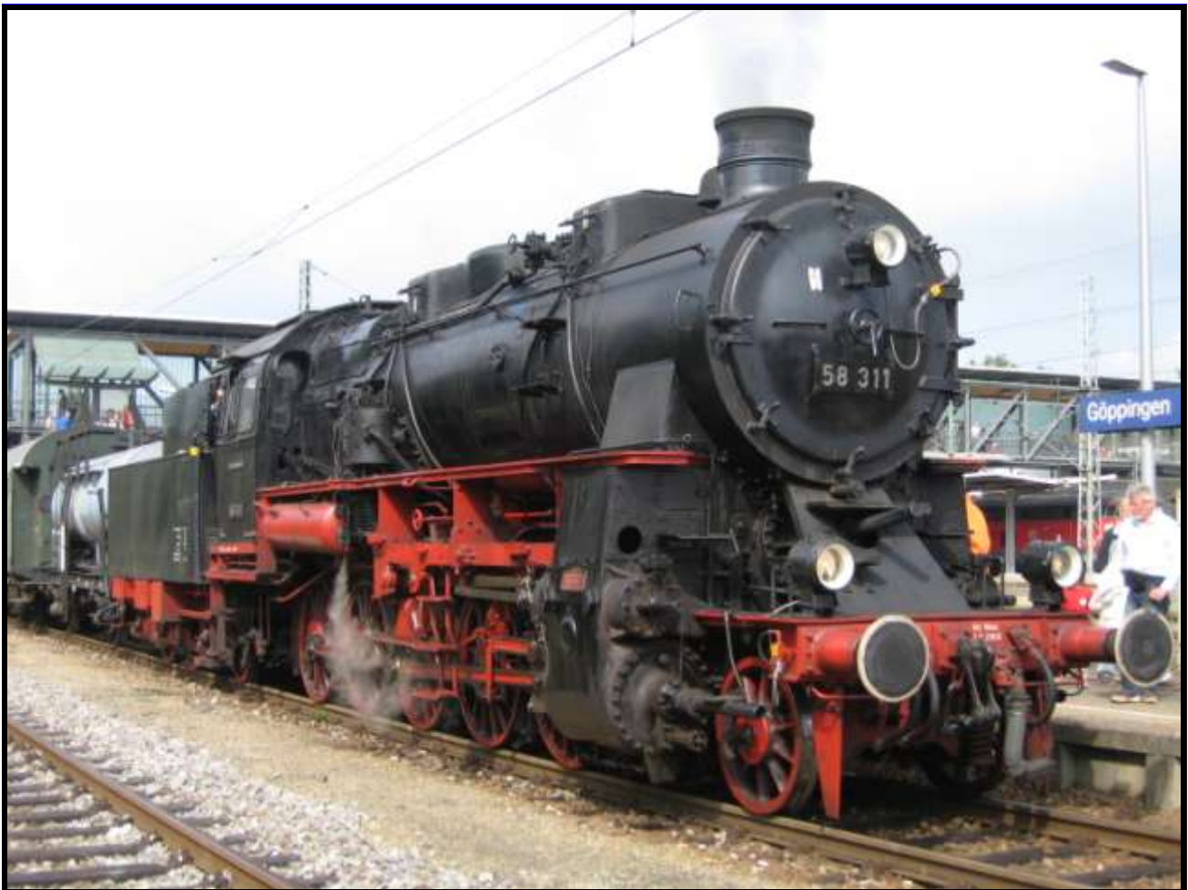
Foto n. 8: evidente segno della giunzione della lamiera nel comignolo della Br 58 311, colta a Göppingen da Marco Palazzo nel 2007.
