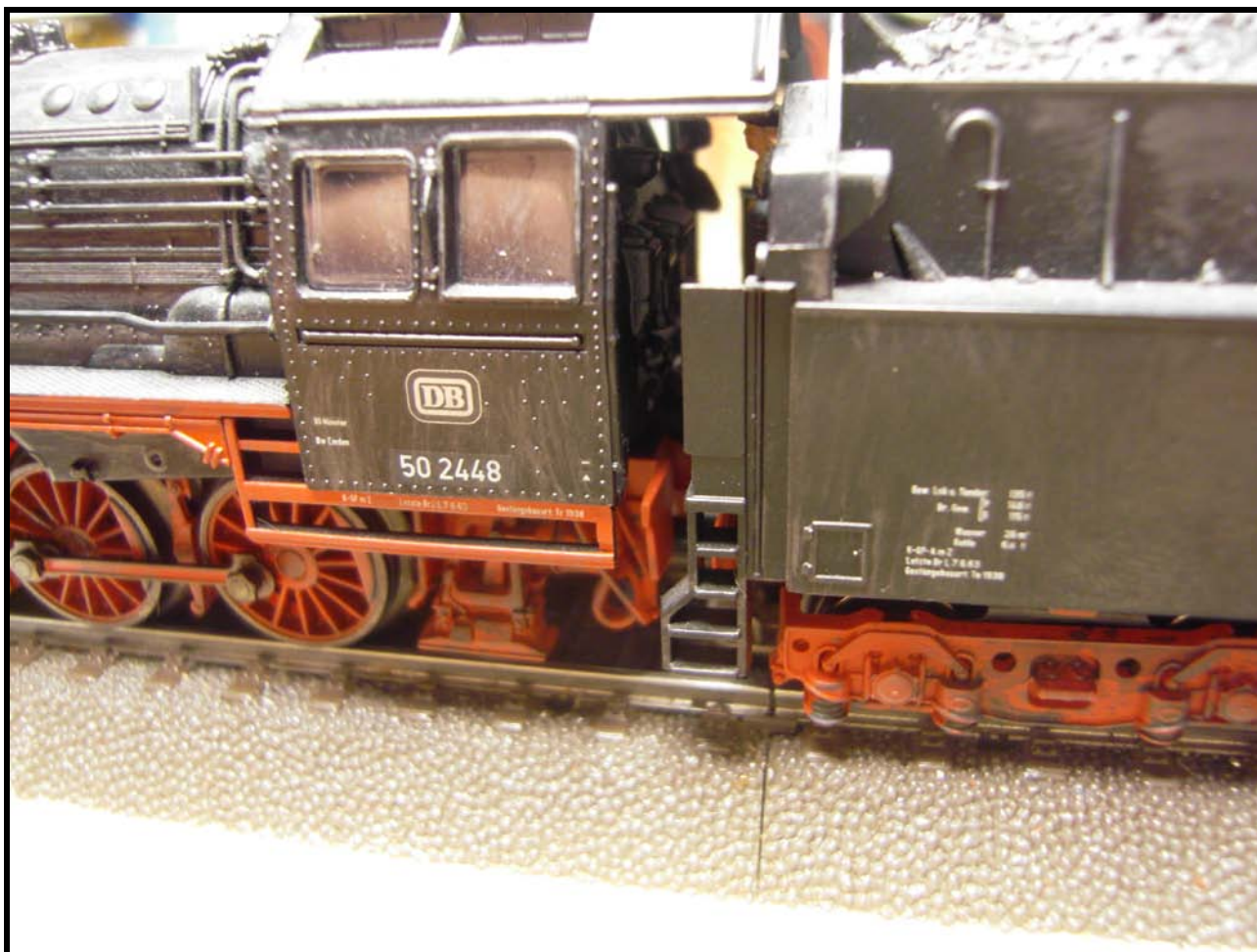
Foto n. 6: la cabina invasa dal motore nella Br 50 2448 del 2001, motore rimasto invariato dal 1974 in molti recenti modelli.
