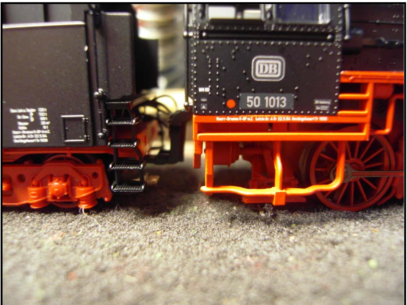
Foto n. 37: lato destro della nuova Br 50 1013 con il dispositivo Indusi.
