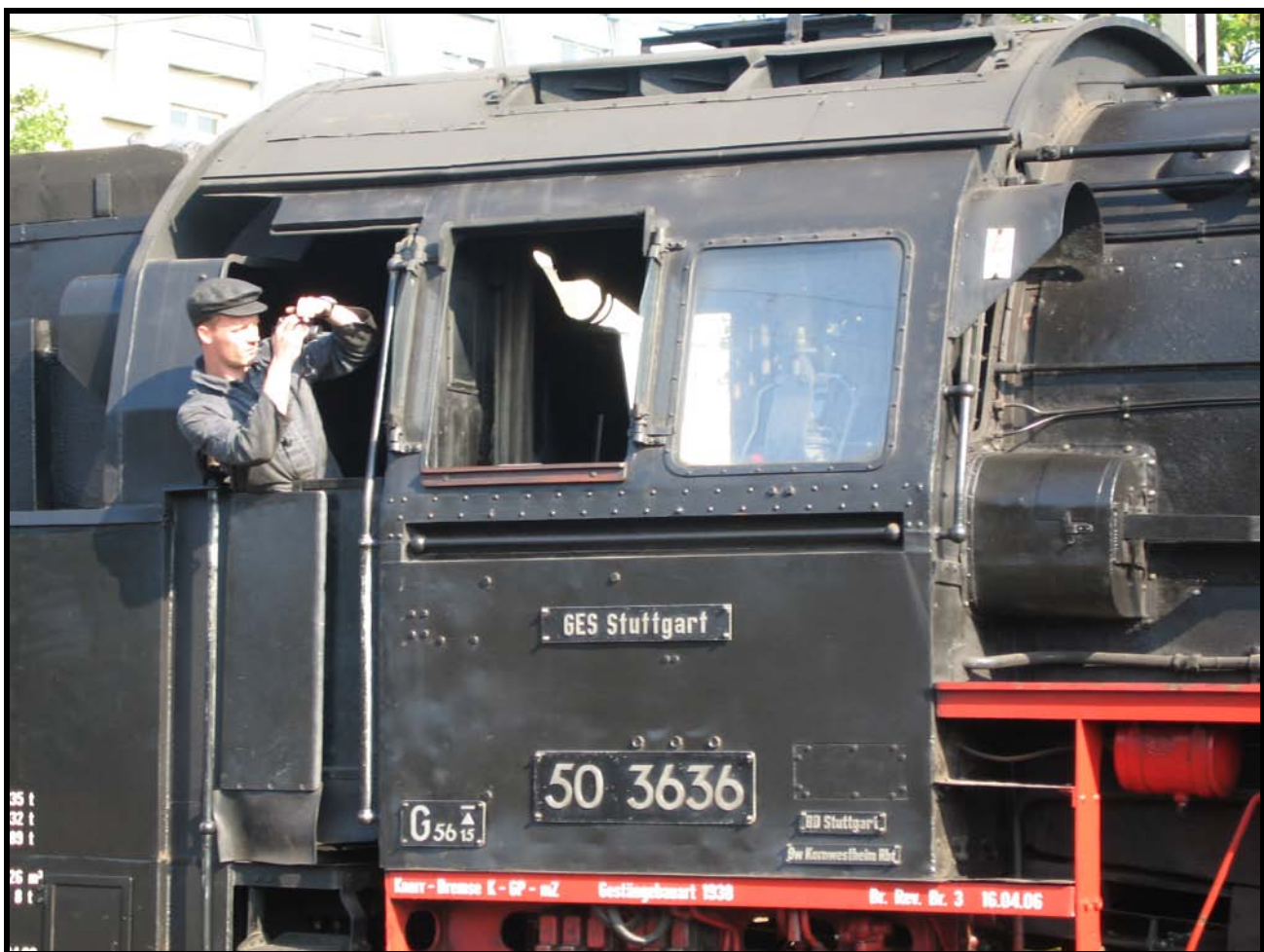
Foto n. 15: al vero la paratia del tender toccava quasi il tetto della cabina e riparava il personale di macchina nella marcia a ritroso.
