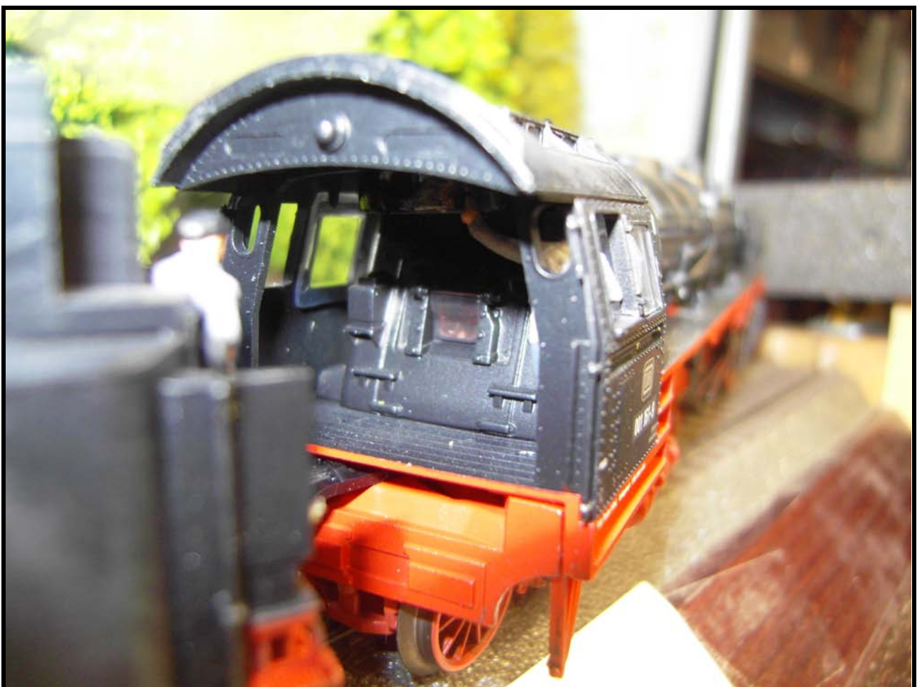
Foto n. 24: corrimano destro spezzato nella Br 001 161-9 del 2009.
