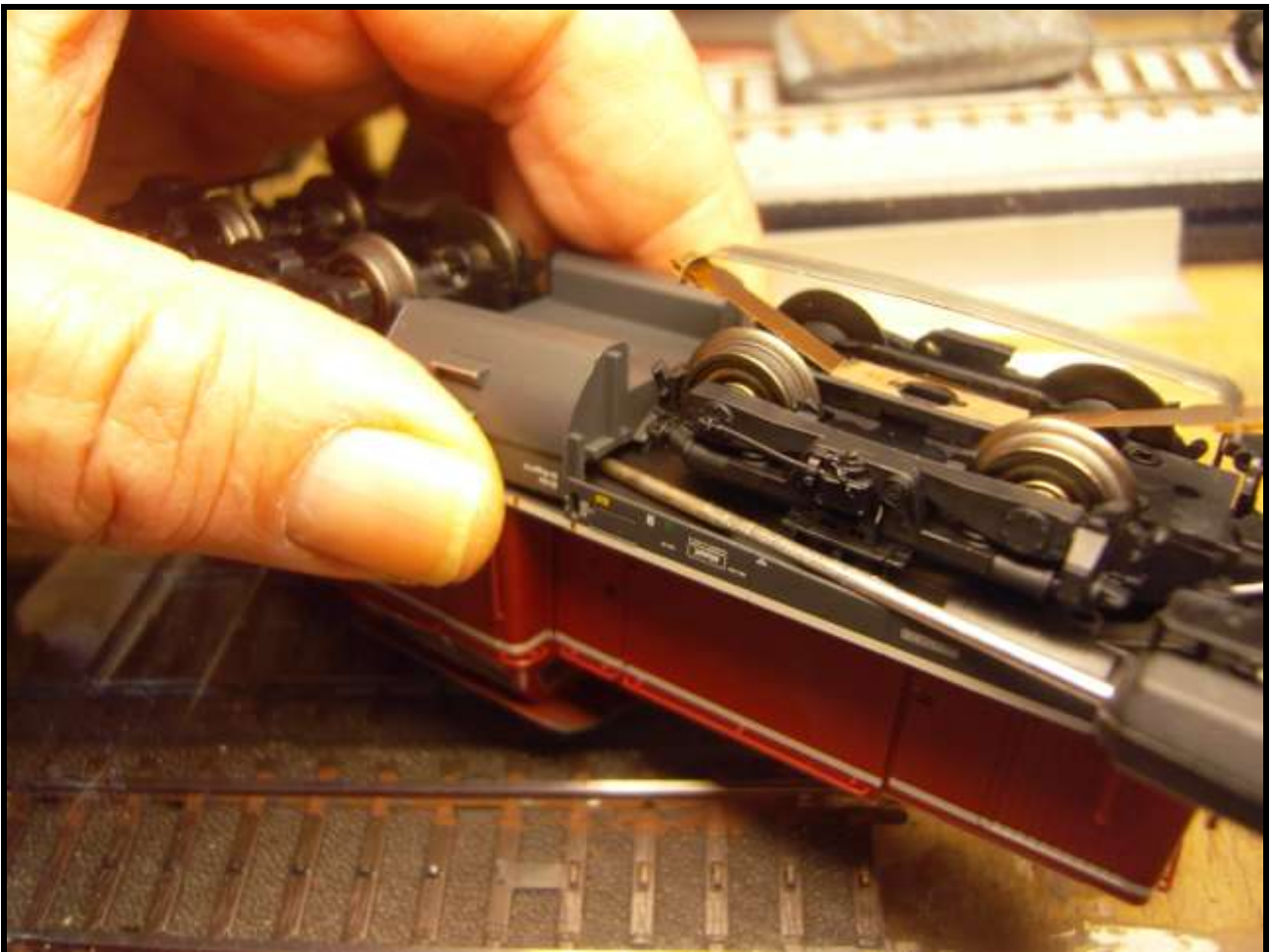
Foto n. 8: come usare il cacciavite per allontanare i serbatoi.
