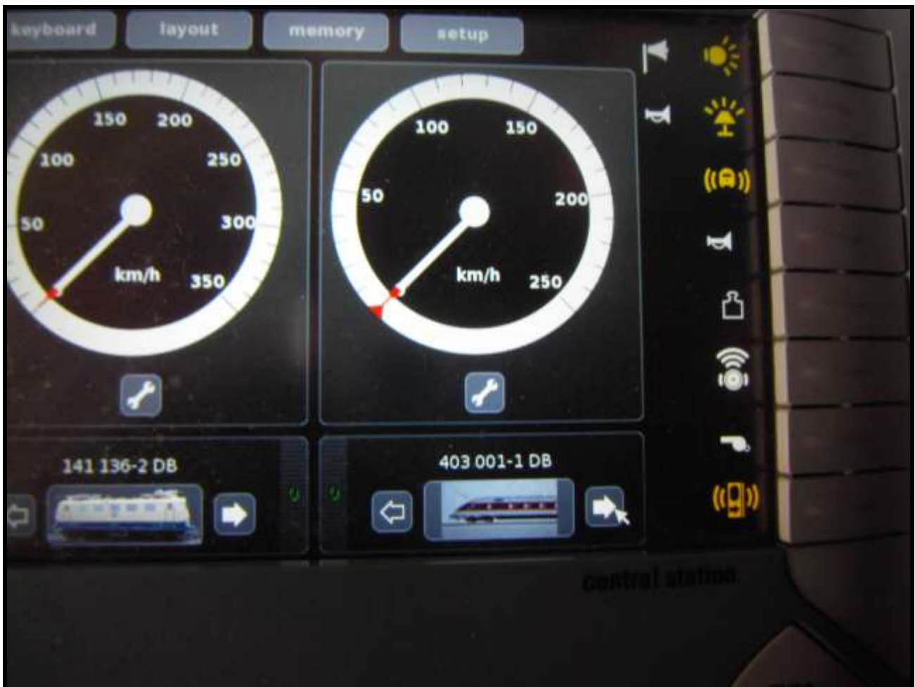
Foto n. 9: con l'attivazione della chiusura-porte (a destra in basso) l'ET 403 non può partire.
