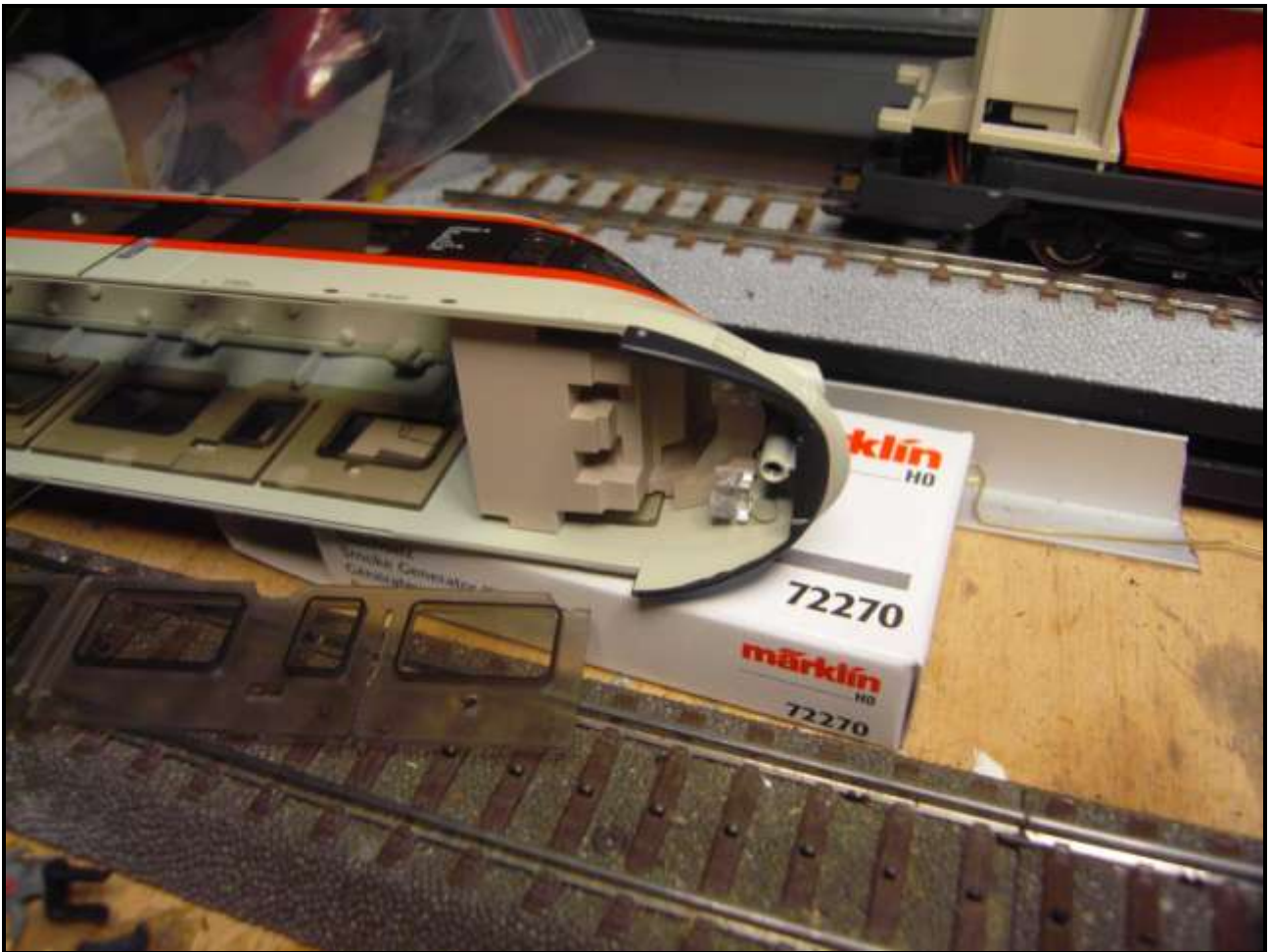
Foto n. 18: allontanando il mantello di una carrozza pilota si distaccano facilmente tutti i vetri.
