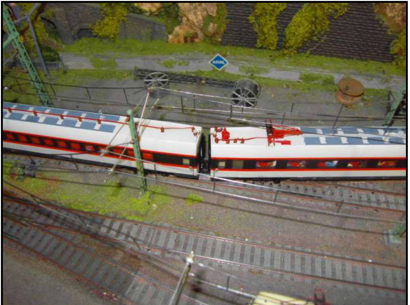
Foto n. 9: minima disarticolazione dei soffietti in curve o controcurve dei deviatori slanciati, da 12,1°, art. 24711/12 Märklin.
