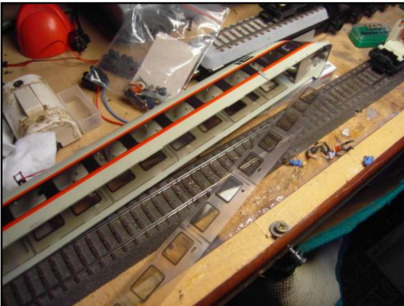
Foto n. 21: la colla vinilica è praticamente invisibile dopo alcune ore.
