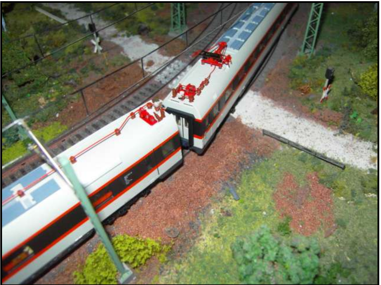
Foto n. 10 e n. 11: maggiore disarticolazione dei soffietti in curve da 30°, di tipo R4 ed R 5.
