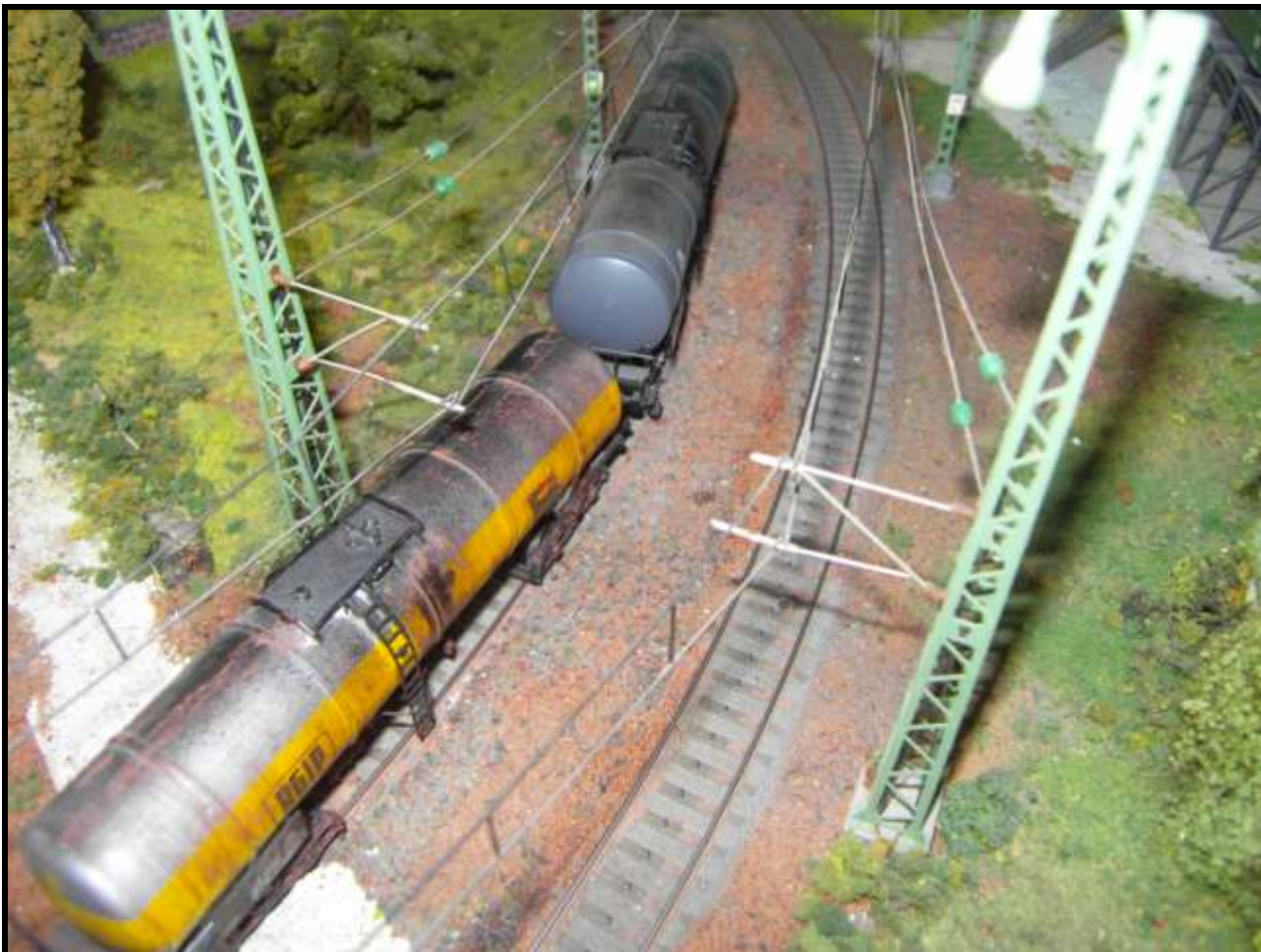
Foto n. 43: i cavi fissati sui pali Märklin con isolatori.
