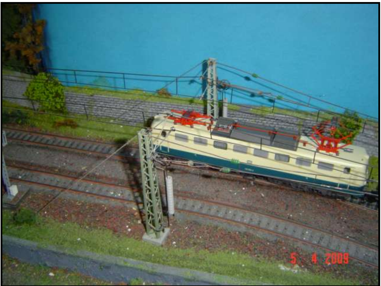
Foto n. 40: i pali a torre bassi, i tenditori ei contrappesi sono Sommerfeldt, le mensole sono invece le Märklin adattate.
