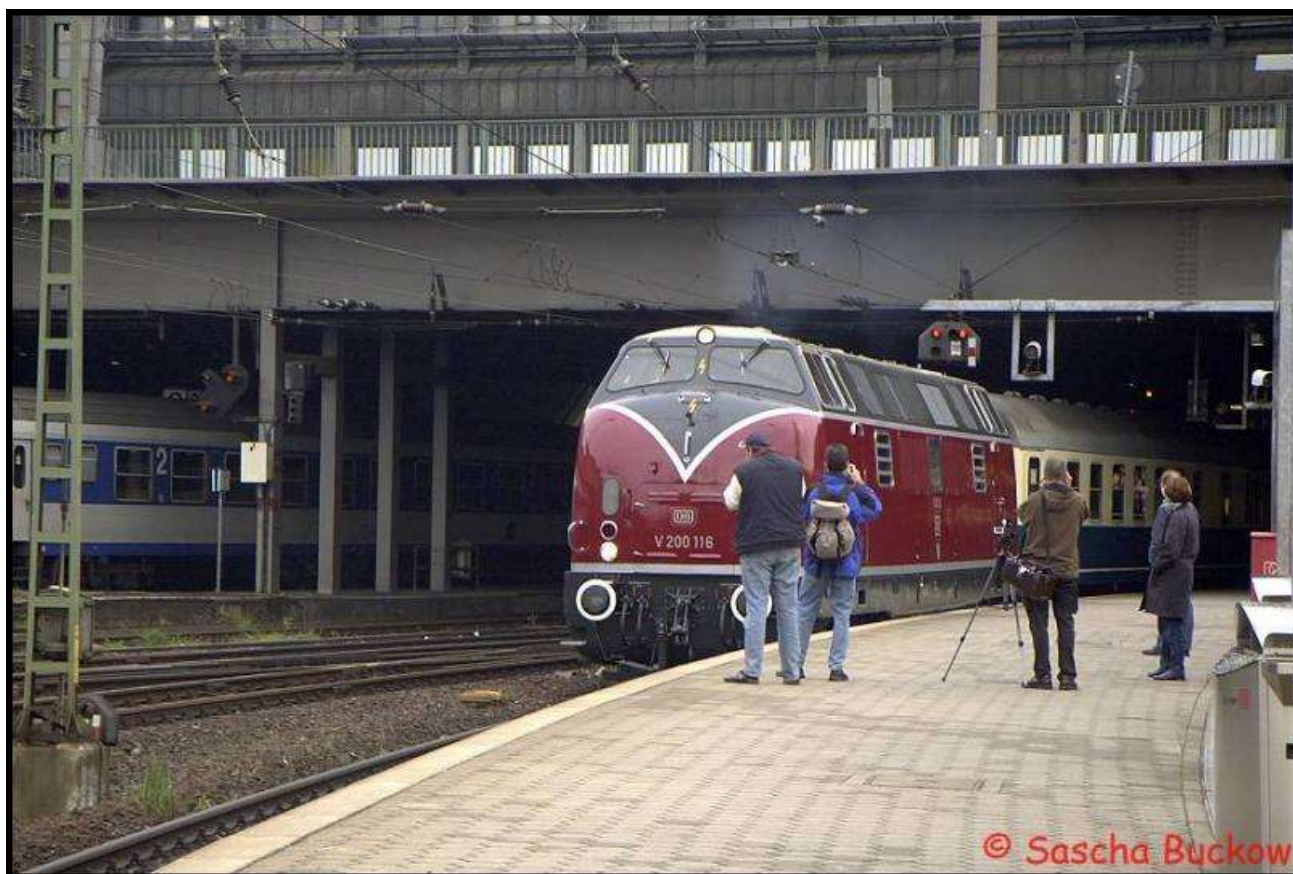
Foto n. 10: l'isolatore a slitta proprio sopra la V 200 116 museale.
