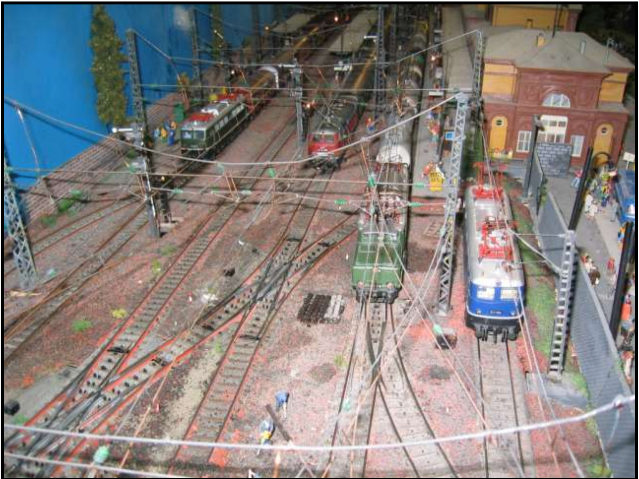
Foto n. 2: le sospensioni trasversali autocostruite a Vibaden Due.
