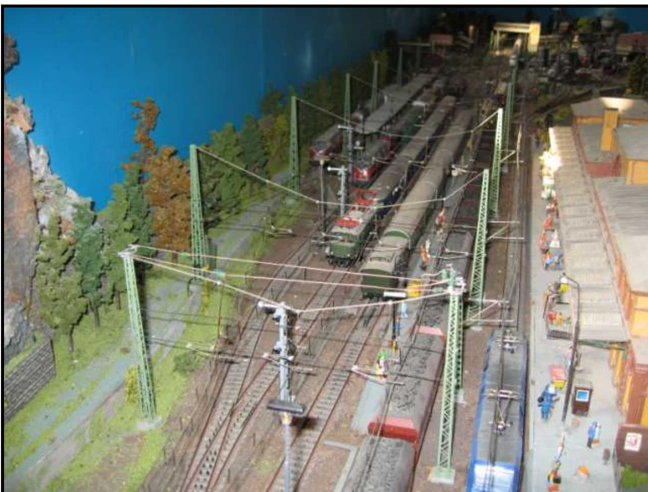
Foto n. 39: palo a torre con contrappeso a sinistra nella sospensione in seconda fila, dietro quella con la calata d'alimentazione.
