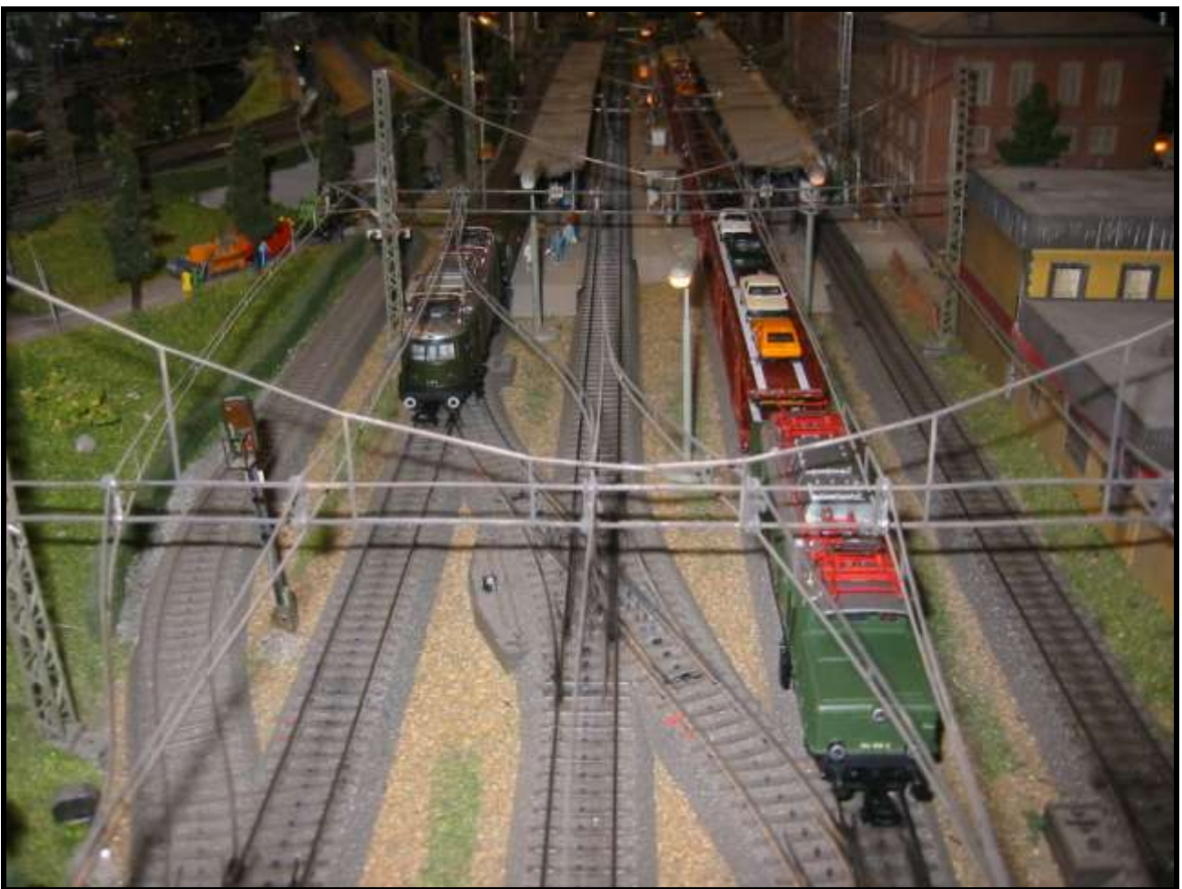
Foto n. 6: indecenti le curvature del filo in un plastico dimostrativo.
