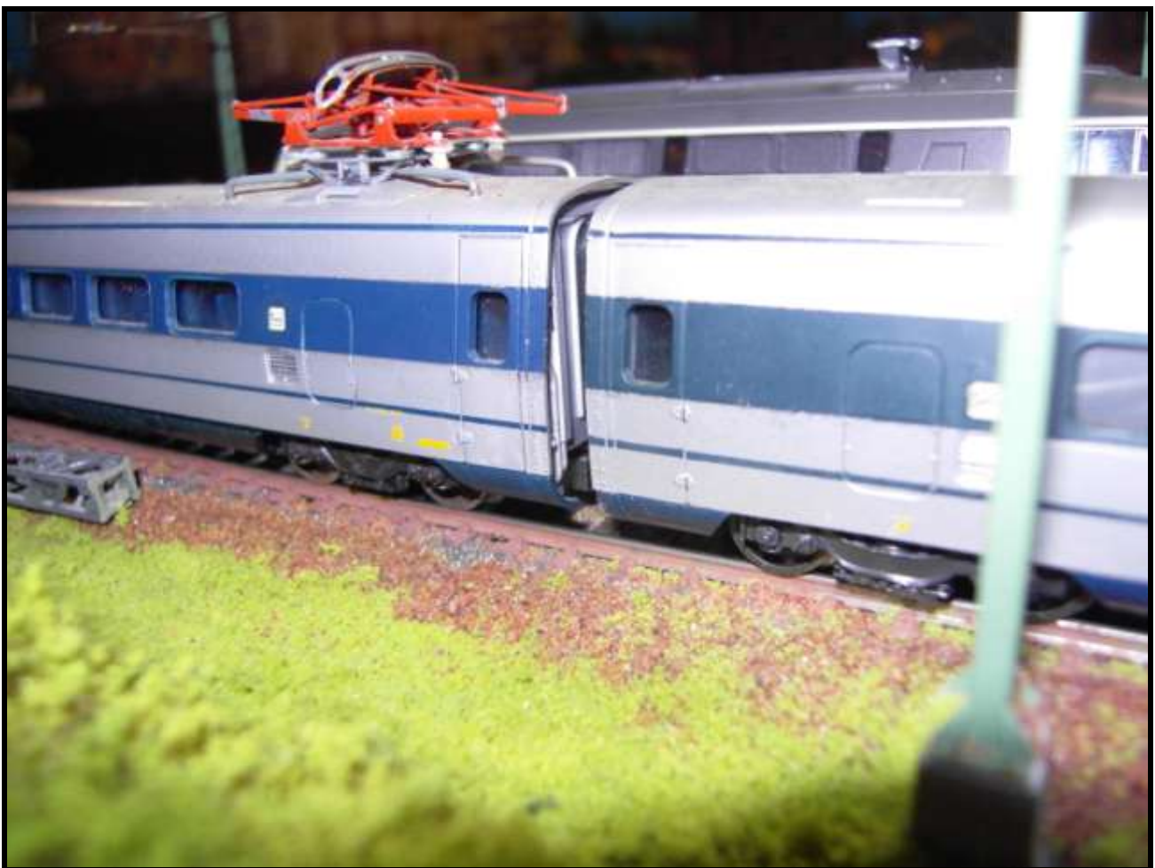
Foto n. 21: pantografo italiano tipo 52 sull'ETR 401 FS a Vibaden.
