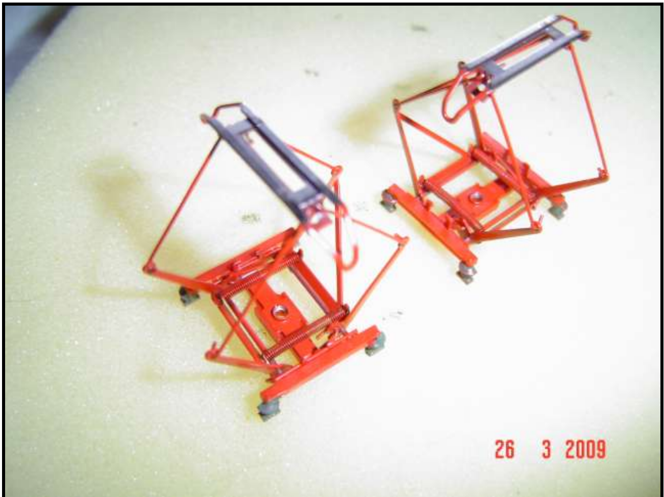
Foto n. 1: i DBS 54 montati su molti locomotori Märklin.
