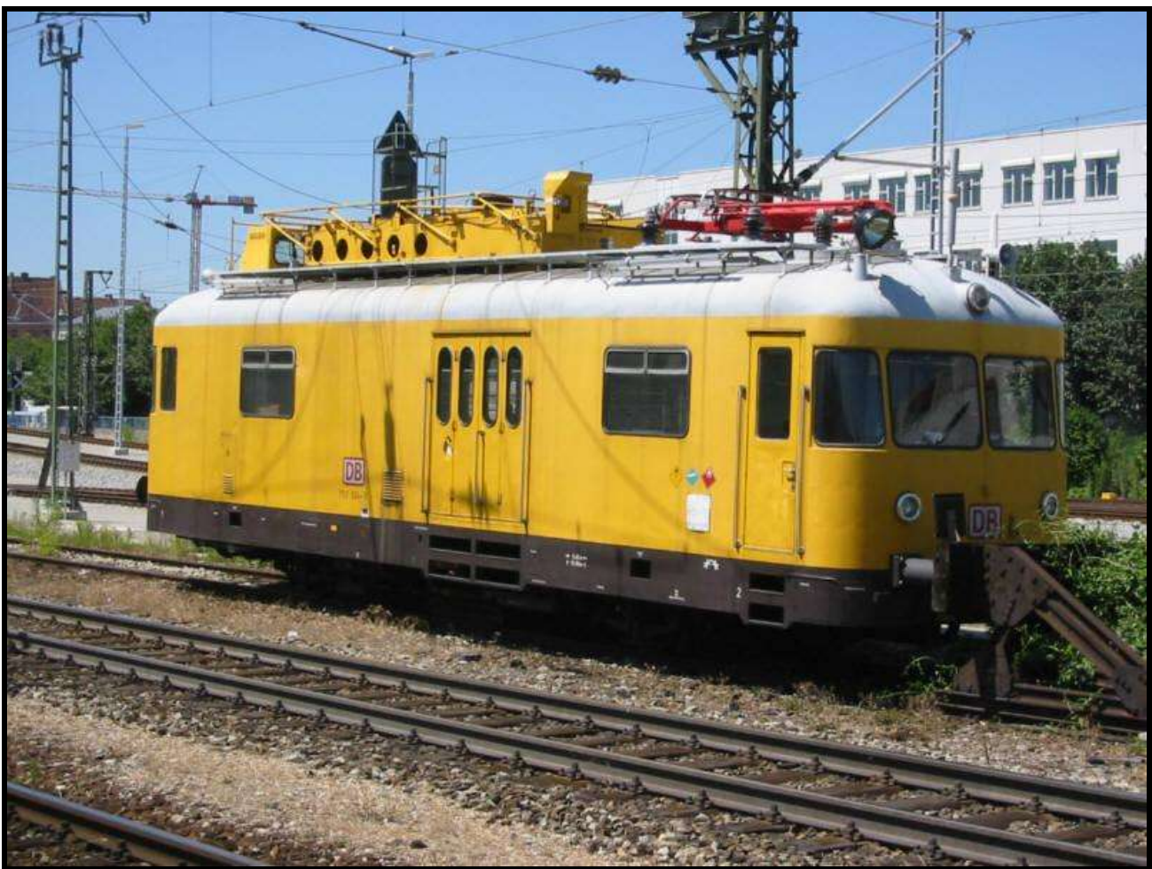
Foto n. 20: una reale draisina DB AG con pantografo monobraccio.
