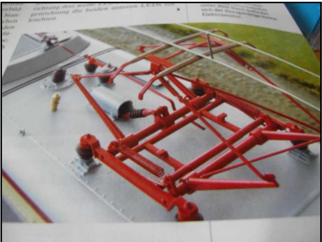
Foto n. 2: le piccole molle (quasi invisibili sorreggono lo strisciante) nei DBS 54, in scala 1 Märklin, montati per esempio su una 103.
