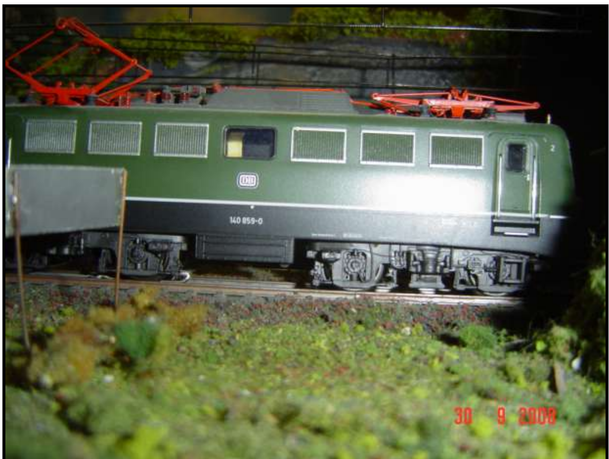
Foto n. 3: i DBS 54 in H0, montati su molti locomotori Märklin.
