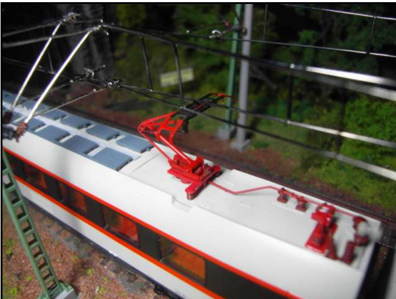
Foto n. 29: particolare delle prove con il nuovo pantografo dell'ET 403.
