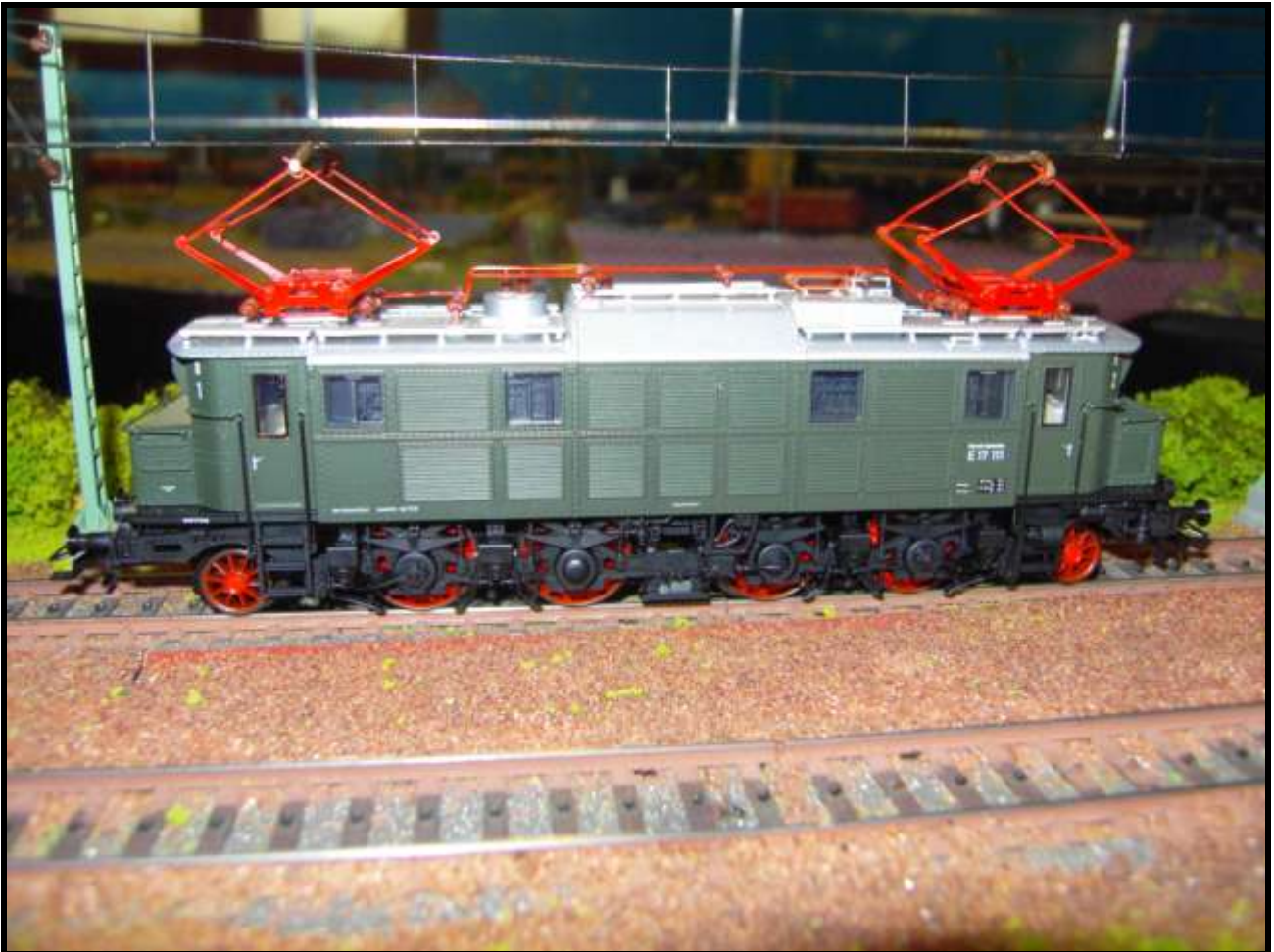
Foto n. 23: i pantografi SBS 10, montati per esempio sulla Märklin E 17 111 del 2011, hanno il braccetto orizzontale ricavato da curvatura .
