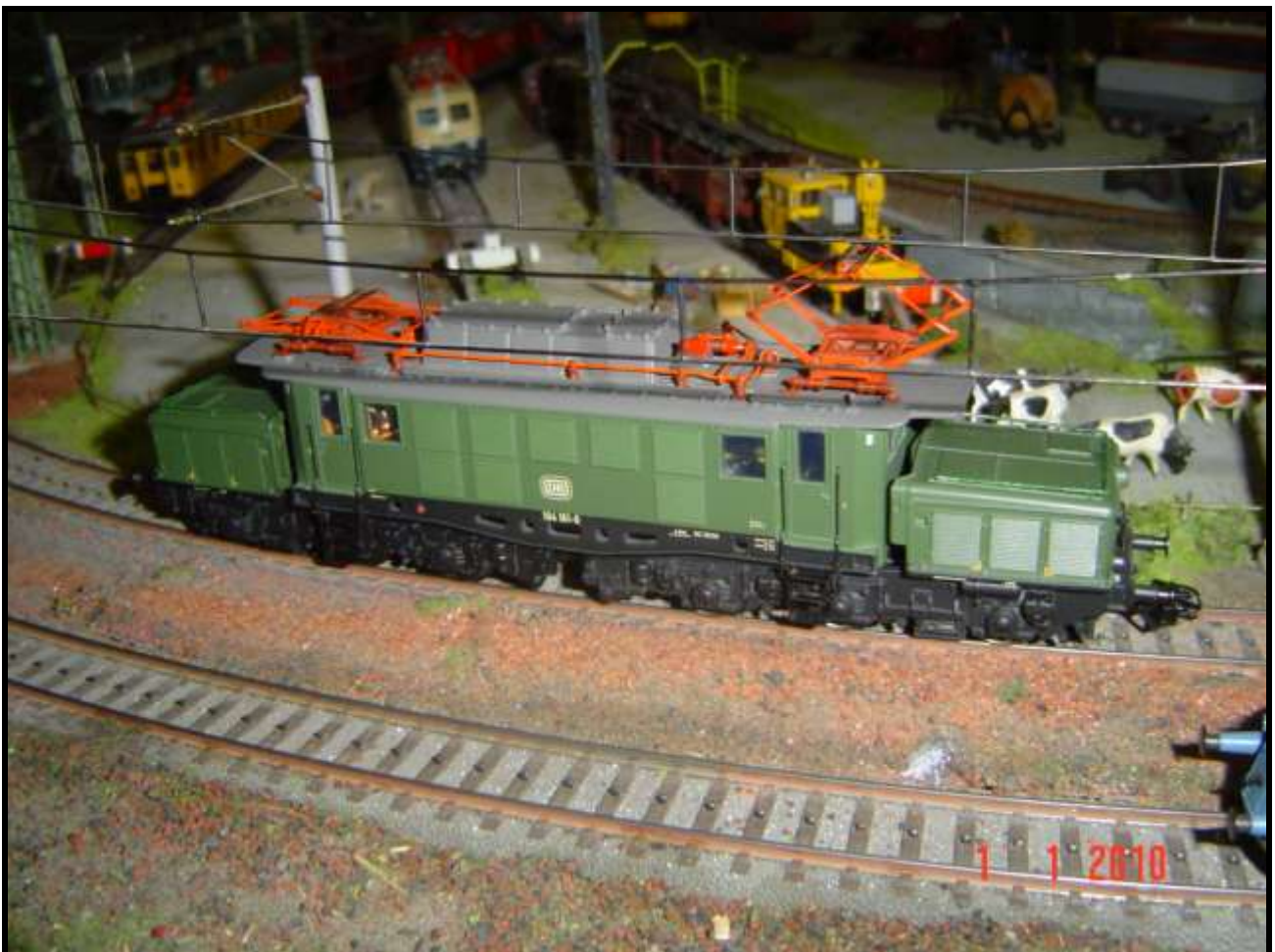
Foto n. 27: SBS 10 con striscianti doppi, montati sulla Märklin 194 161.
